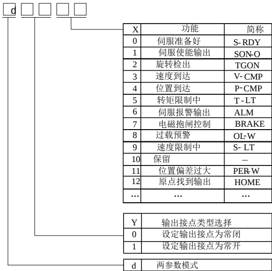
图 8.1.2 可编程输出端子功能设定示意图
