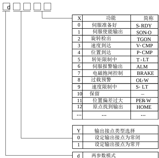
图 8.1.2 可编程输出端子功能设定示意图
