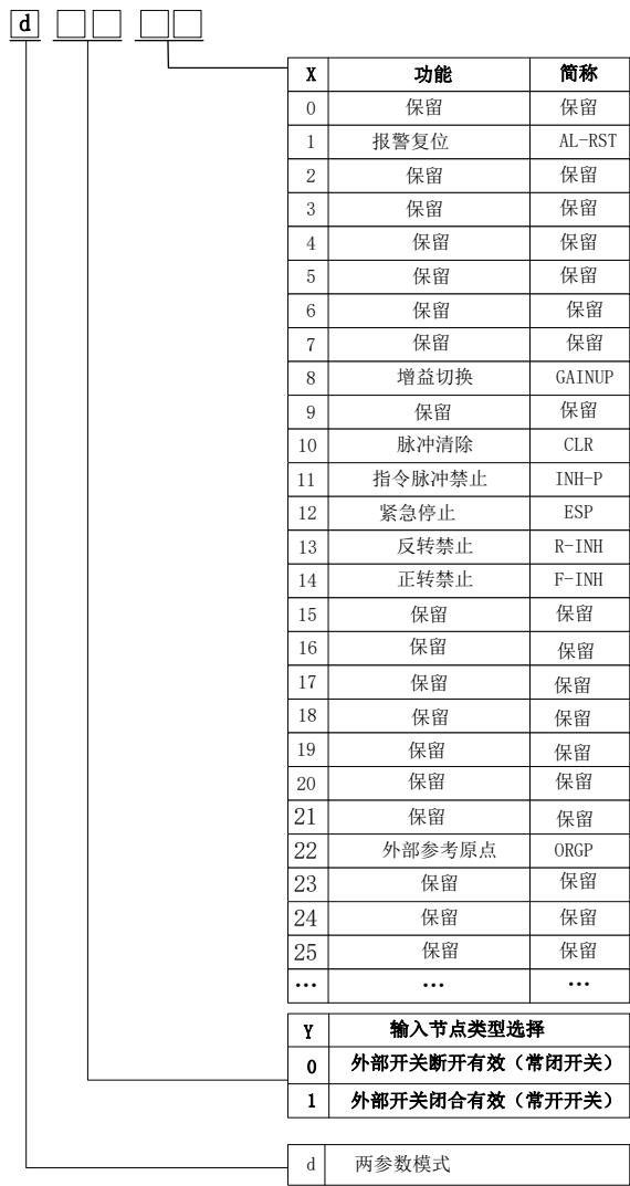
图 8.1.1 可编程输入端子功能设定示意图
