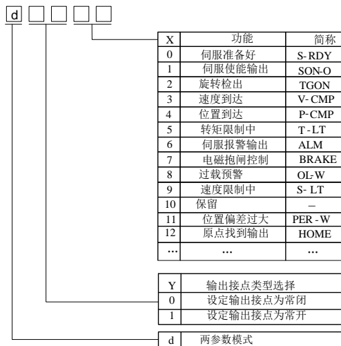
图 8.3.2 可编程输出端子功能设定示意图
