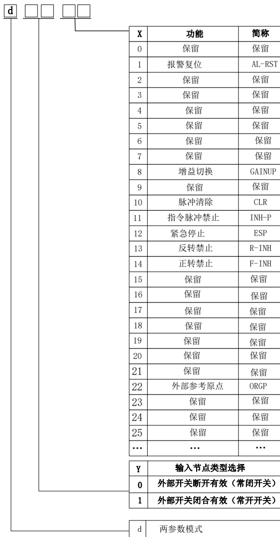
图 8.1.1 可编程输入端子功能设定示意图
