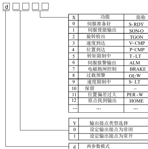
图 8.1.2 可编程输出端子功能设定示意图
