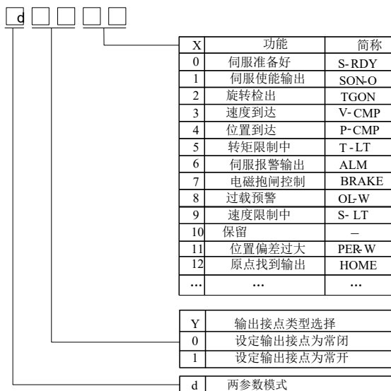
图 8.1.2 可编程输出端子功能设定示意图
