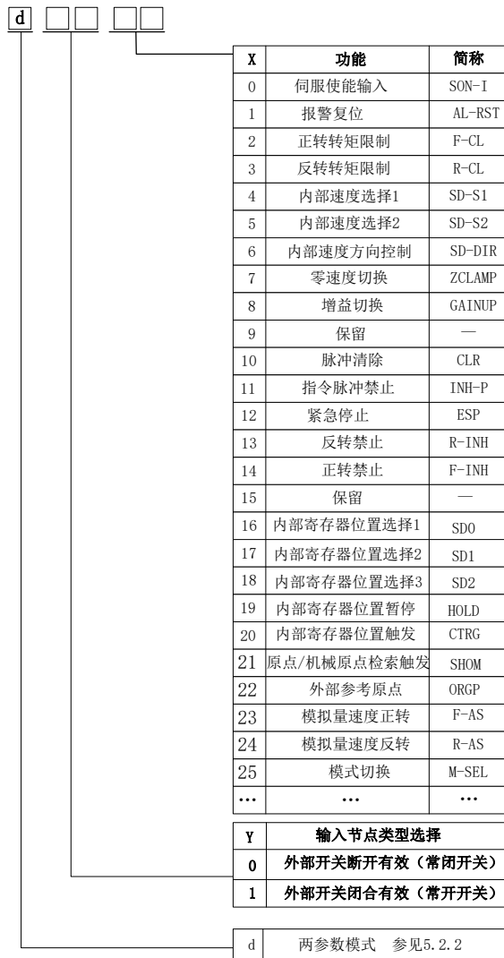
图 8.1.1 可编程输入端子功能设定示意图
