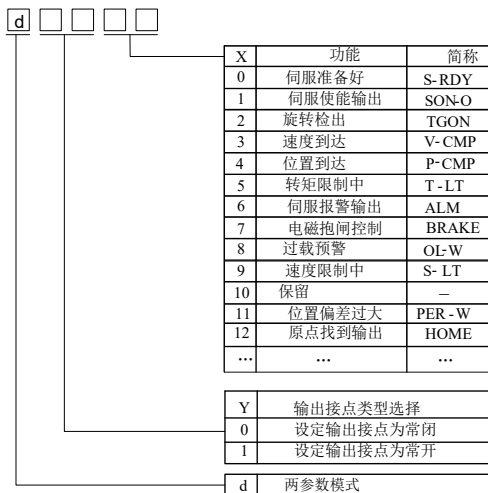
图 8.1.2 可编程输出端子功能设定示意图
