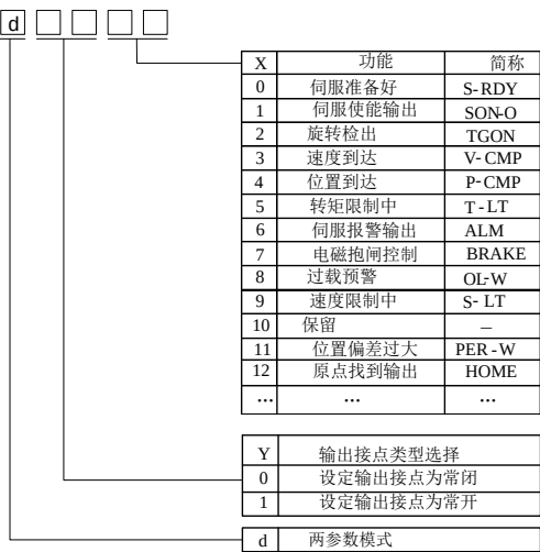
图 8.3.2 可编程输出端子功能设定示意图
