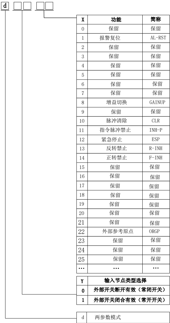
图 8.1.1 可编程输入端子功能设定示意图
