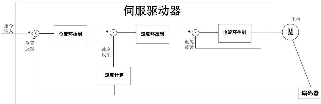
图 6 伺服系统控制框架图
