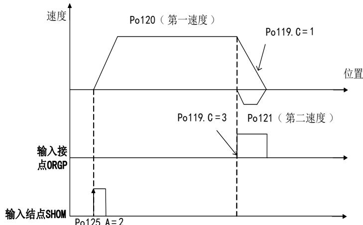
图 6.4.31 原点检索第一速度正转寻找原点
