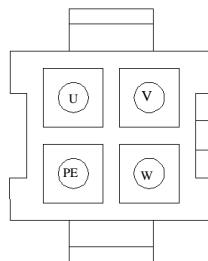
图 4.4.1 4 芯航电源安普插头示意图
