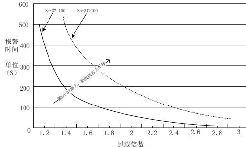
图 6.6.1 电机过载曲线与报警时间曲线图
