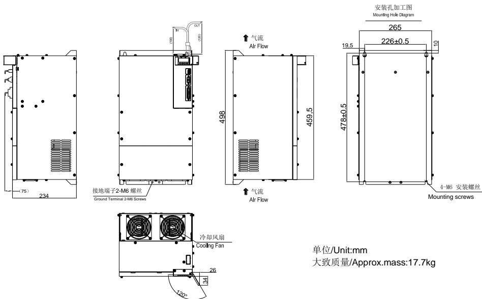
图 3.1.10 伺服驱动器结构尺寸 9
