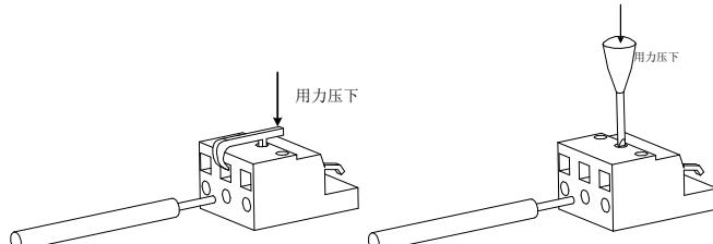
图 4.1.5 主电路端子使用方法
