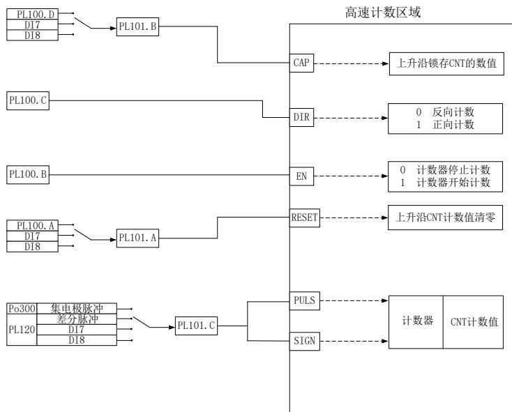
图 6.7.1 高速计数器内部框架图
