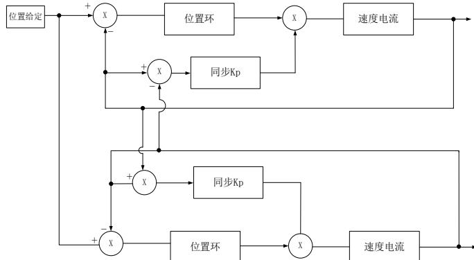
图 6.4.41 龙门同步典型应用接线图
