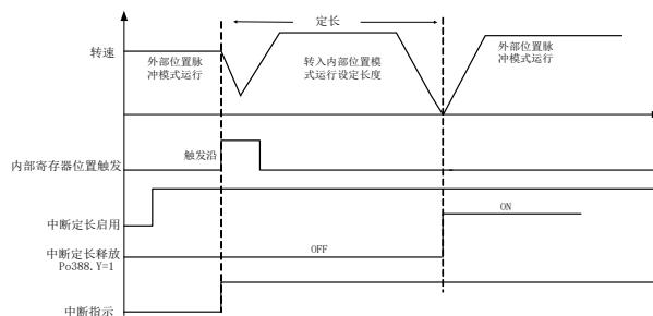
图 6.4.36 中断定长控制时序图
