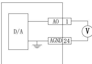
图 4.3.12 模拟量监控输出接口
