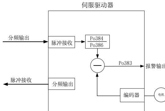
图 6.4.43 龙门同步实际使用中内部原理图
