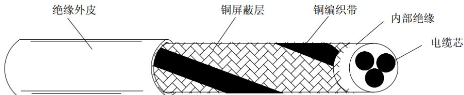
图 4.5.2 屏蔽线缆编制密度示意图
