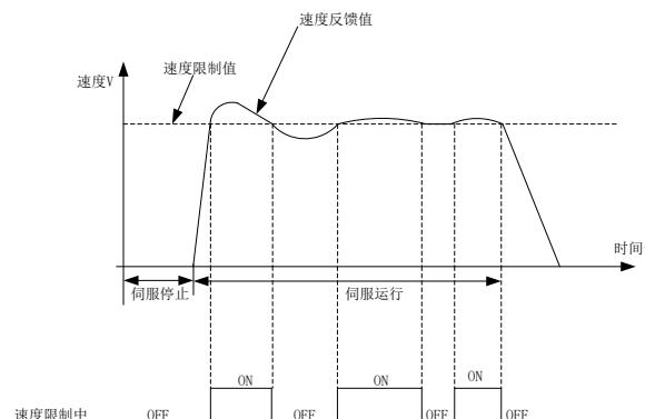
图 6.6.2 转矩模式下速度限制中输出示意图
