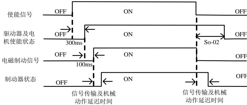
图 6.1.8 电磁抱闸制动时序图
