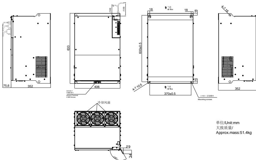
图 3.1.13 伺服驱动器结构尺寸 12
