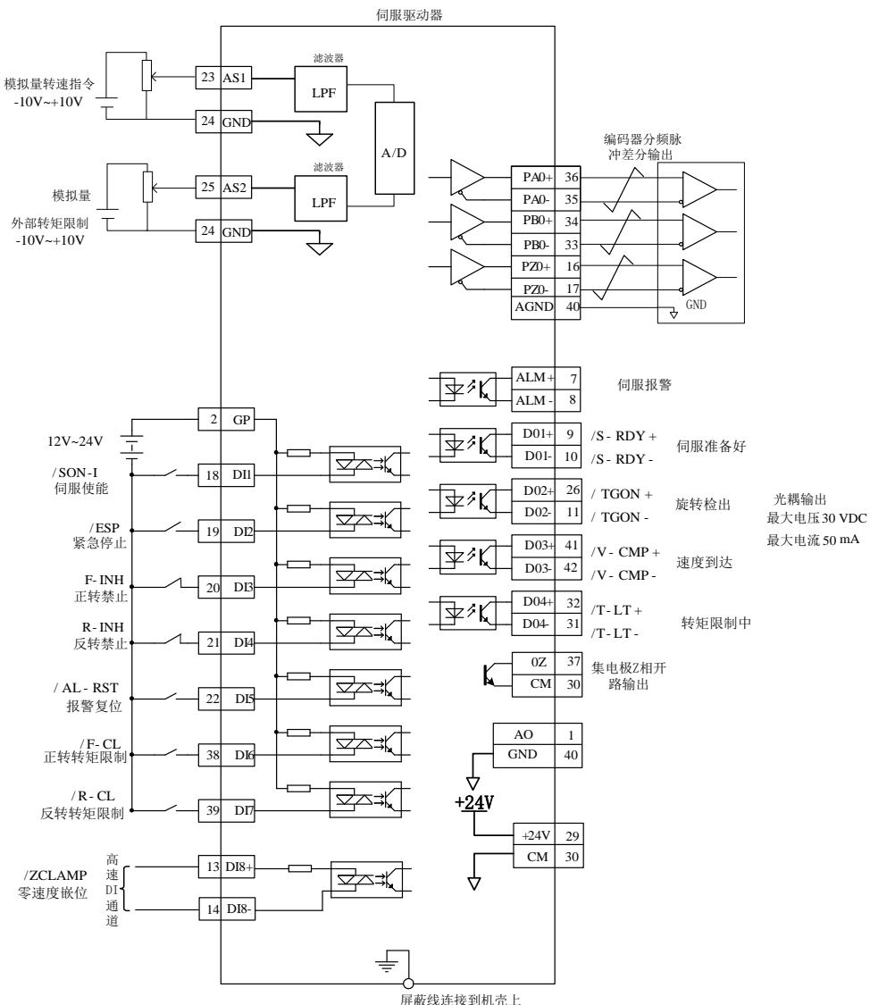
图 6.2.4 模拟量速度模式下典型的接线图
