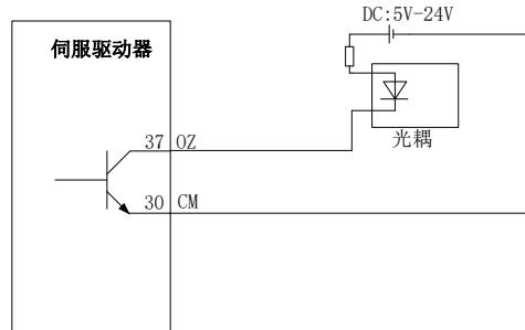
图 4.3.21 集电极 OZ 信号接口电路
