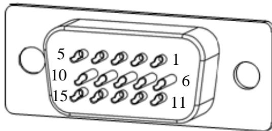
图 4.2.4 Hiperface 型编码器端子排列示意图
