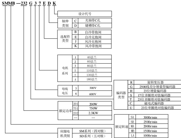
图 2.2.1 伺服电机命名規则 (180 及以下法兰电机)
