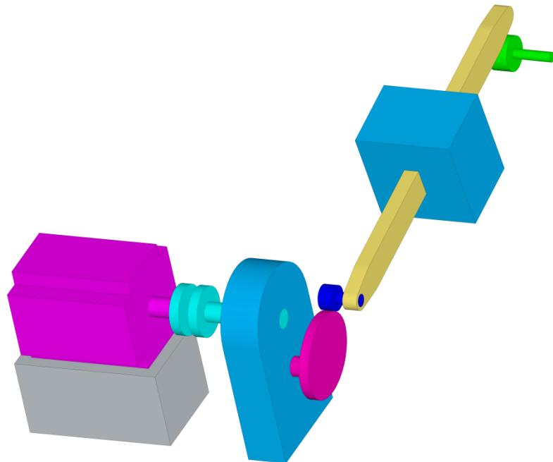
图 6.4.45 SD20 伺服电子凸轮内部框架图
