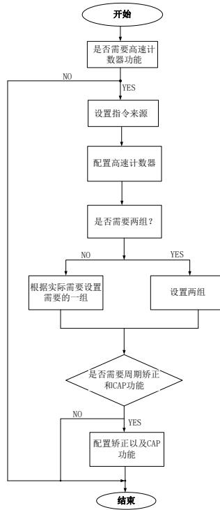
图 6.7.2 高速计数器设置流程
