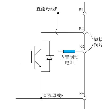
图 6.1.16 伺服内部能耗制动示意图
