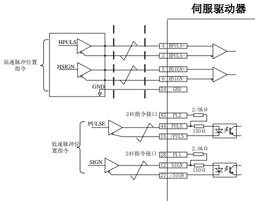
图 6.4.4 外部位置脉冲指令端子接线示意图
