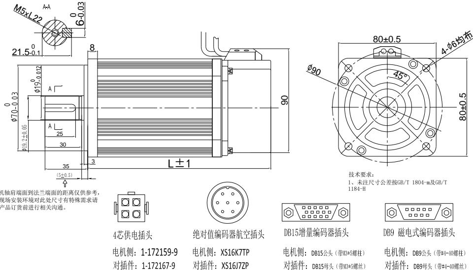
电机轴端面到法兰端面的距离仅供参考，
