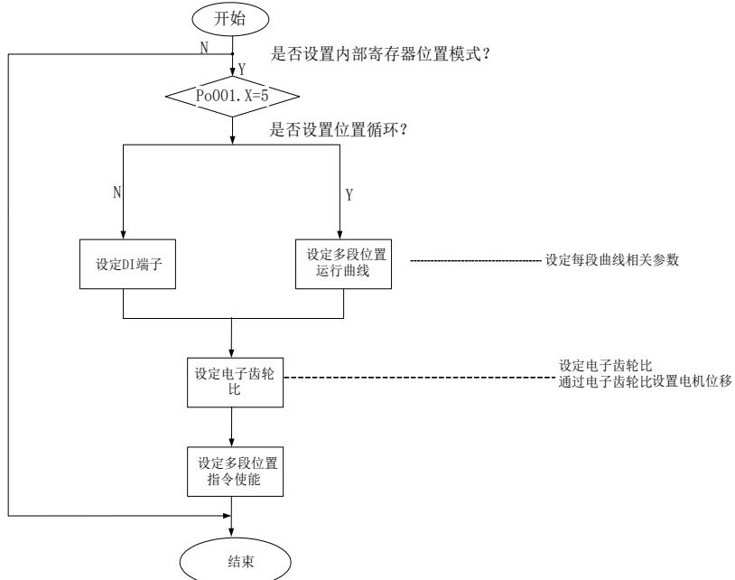
图 6.4.7 内部寄存器位置设置流程图
