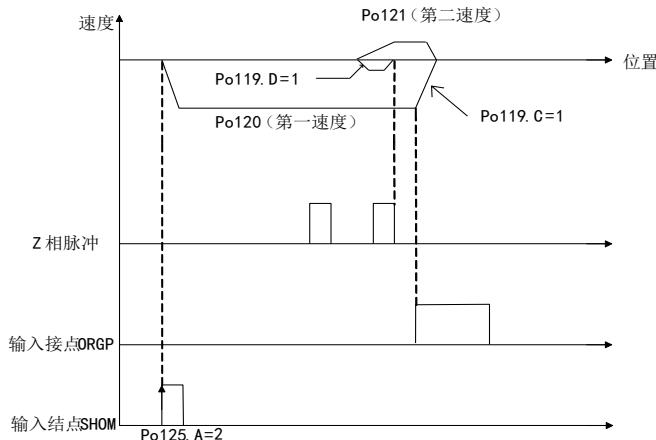
图 6.4.26 原点检索第一速度反转寻找原点
