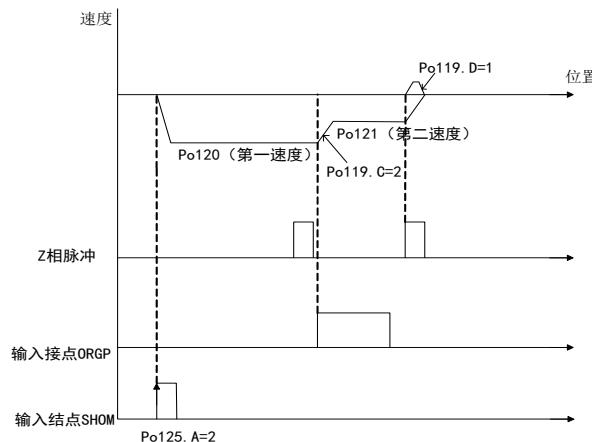
图 6.4.28 原点检索第一速度反转寻找原点
