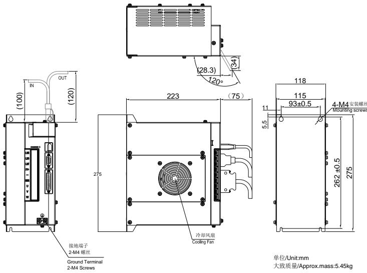
图 3.1.6 伺服驱动器结构尺寸 5
