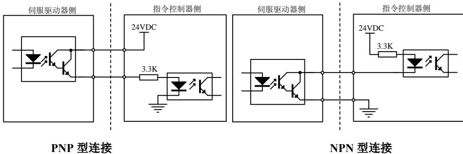
图 4.3.18 光电耦合器输出接口电路
