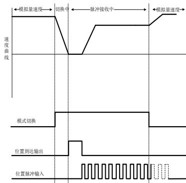
图 6.5.2 模拟量速度及位置脉冲时序图
