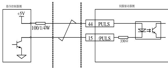
图 4.3.5 5V 集电极开路脉冲输入接口电路
