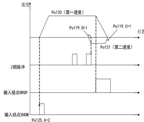
图 6.4.25 原点检索第一速度正转寻找原点
