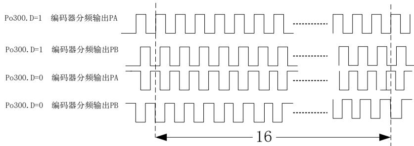
图 6.4.21 编码器信号分频示意图
