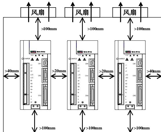
图 3.1.2 多台并列安装最小安装尺寸示意图
