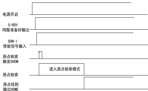
图 6.4.24 接入输入点时的时序图
