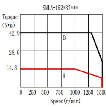
180 法兰伺服电机转矩-转速特性曲线
