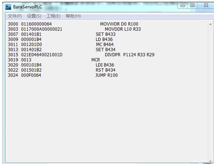
图 6.8.4 程序编译正确时的界面
