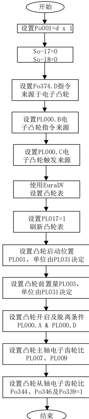
图 6.4.46 SD20 伺服电子凸轮设置流程图
