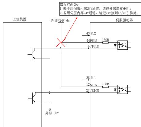
图 4.3.7 24V 集电极开路接线错误示意图 1
