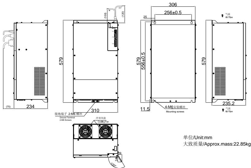
图 3.1.11 伺服驱动器结构尺寸 10
