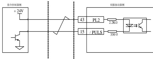
图 4.3.6 24V 集电极开路脉冲输入接口电路
