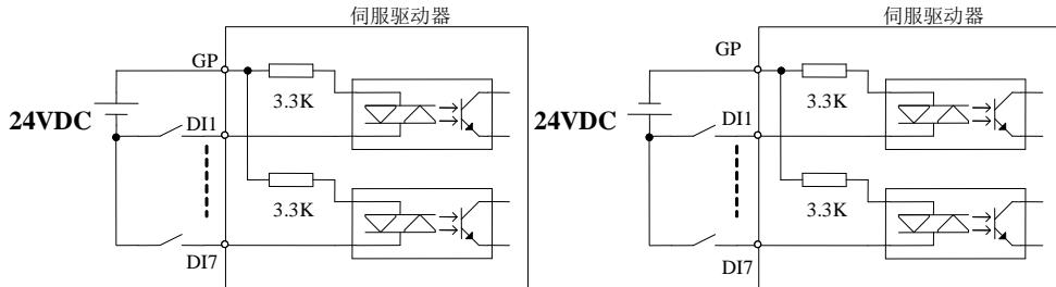
图 4.3.13 无源接点接口电路
