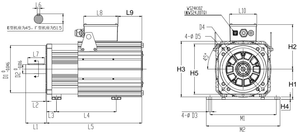
图 3.2.6 180 及 250 止口四对极伺服电机安装尺寸
