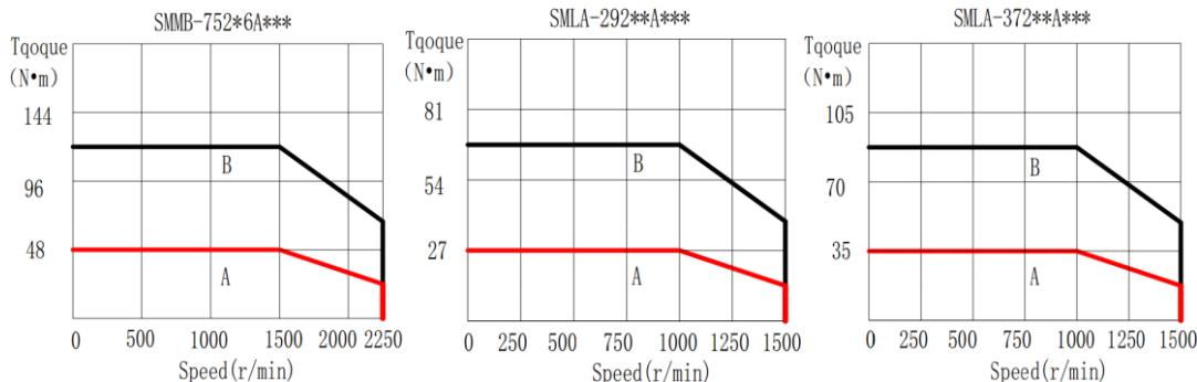
测试条件：1、60/80 法兰伺服电机安装在 260mm×260mm×28mm 铸铁法兰盘上测试；110/130/180 法兰伺服电机安装在 360mm×360mm×38mm 铸铁法兰盘上测试；2、采用匹配驱动器，且输入驱动器电压为额定电压。
