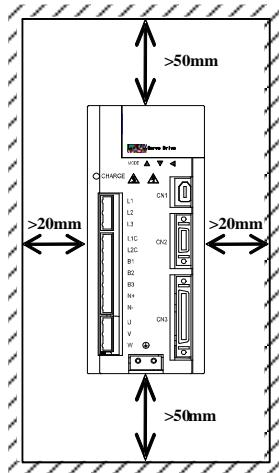
图 3.1.1 典型最小安装尺寸示意图
