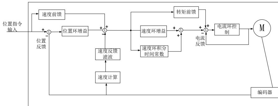
图 7.3.1 伺服驱动器内部框架图
