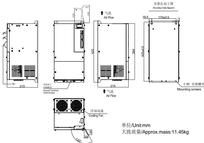
图 3.1.9 伺服驱动器结构尺寸 8
