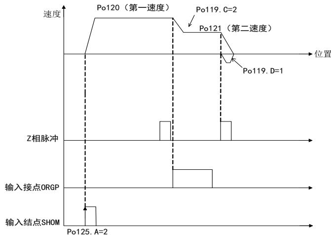
图 6.4.27 原点检索第一速度正转寻找原点
