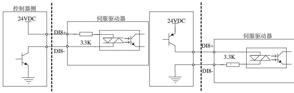
图 4.3.15 DI8 接线图示
