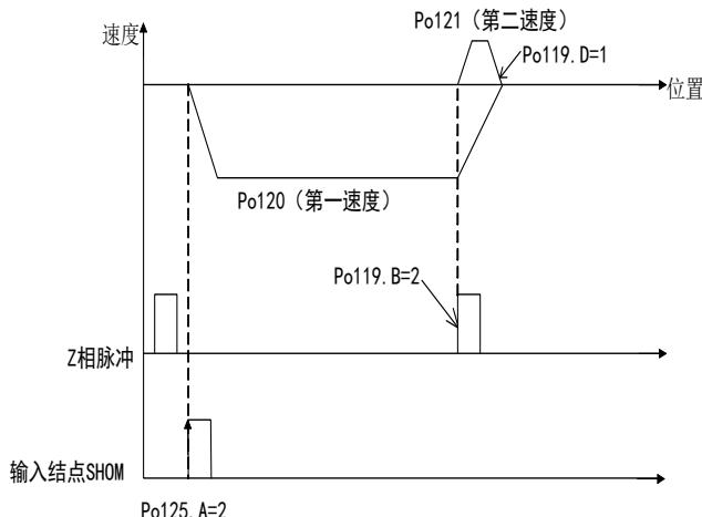
图 6.4.30 原点检索第一速度反转寻找原点
