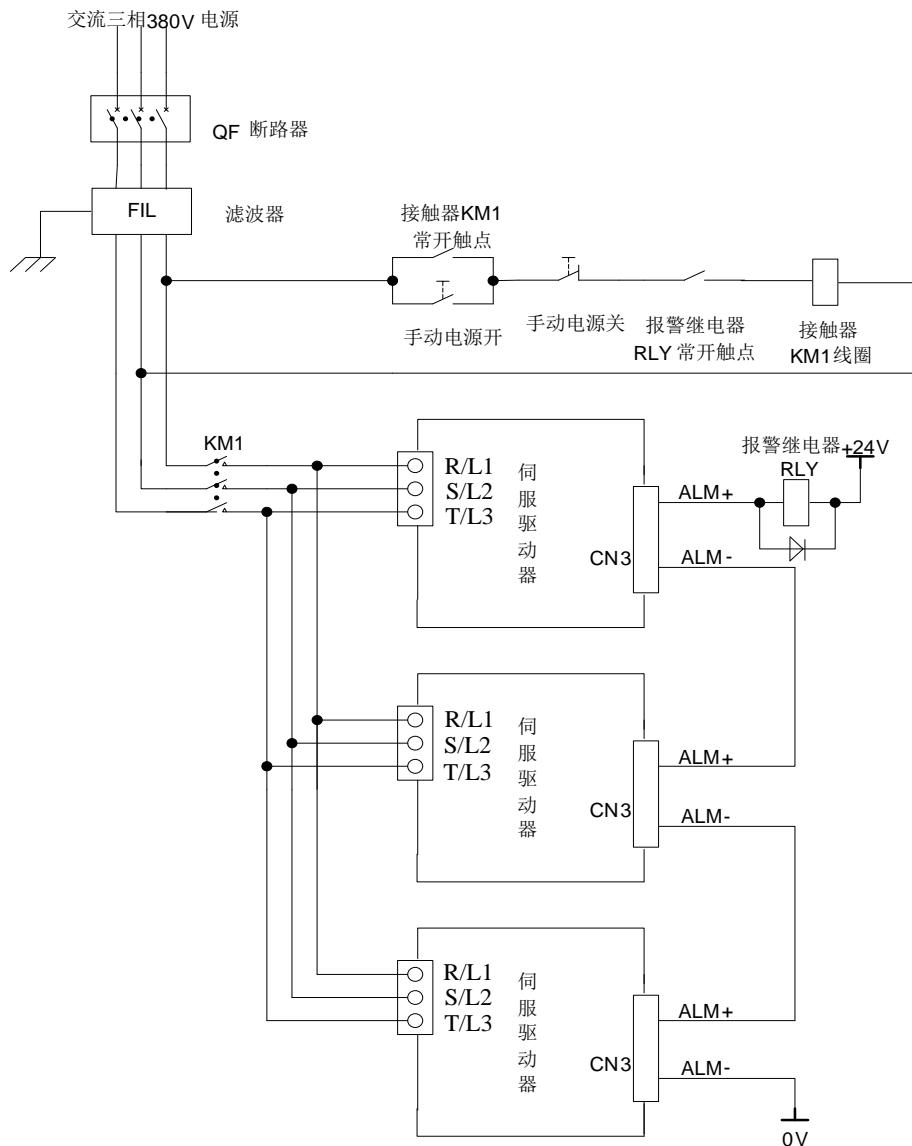
图 4.3.24 380V 多台联机时的接线
