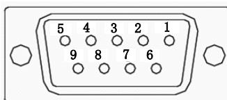
图 4.2.1 绝对值型编码器端子排列示意图
