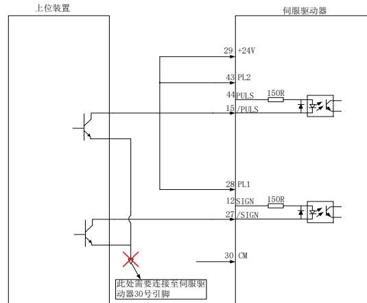
图 4.3.9 24V 集电极开路接线错误示意图 3
