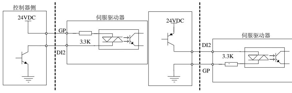
图 4.3.14 有源接点接口电路
