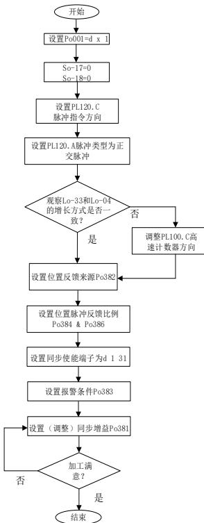
图 6.4.42 龙门同步功能设置流程图
