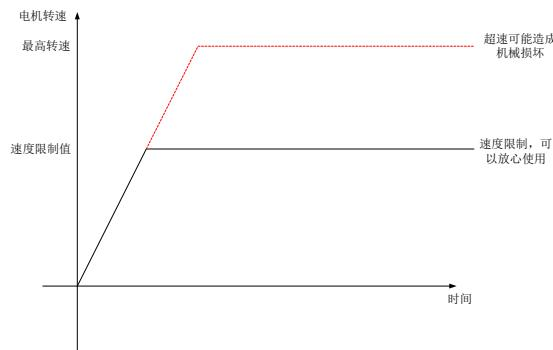
图 6.3.5 转矩模式下速度限制示意图
