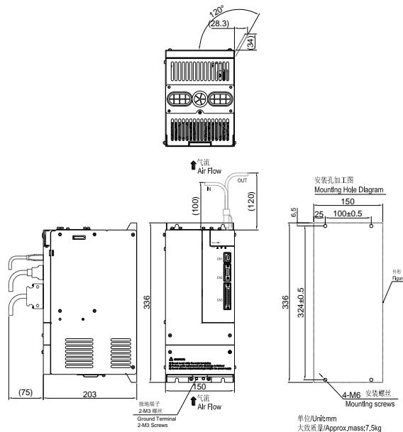
图 3.1.7 伺服驱动器结构尺寸 6
