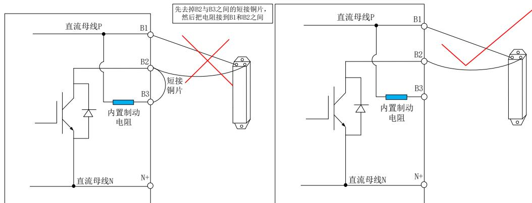
图 6.1.17 伺服制动电阻接线示意图
