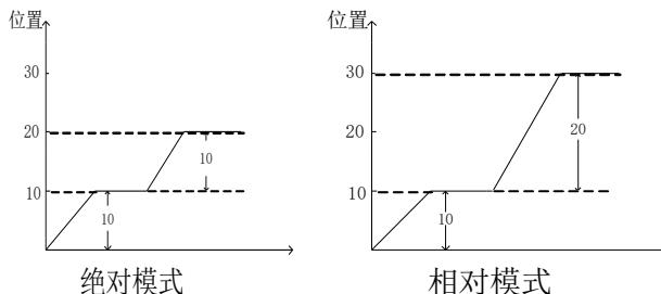
图 6.4.8 相对模式与绝对模式路径图
