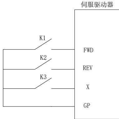
图 6.1.4 三线式运转模式 2 接线示意图
