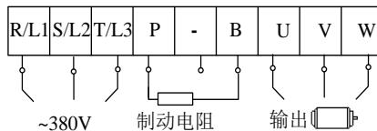
图 4.1.4 380V 伺服功率端子接线示意图
