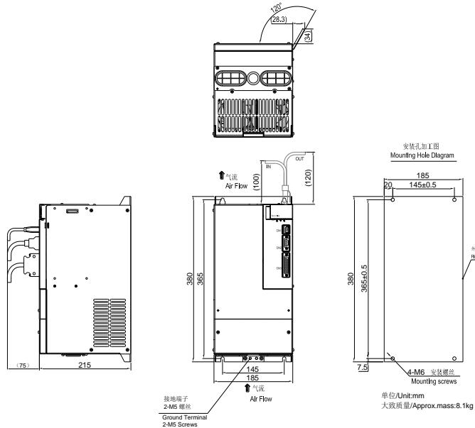
图 3.1.8 伺服驱动器结构尺寸 7
