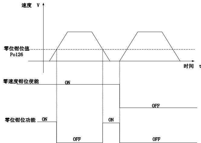
图 6.2.9 零速度钳位波形示意图
