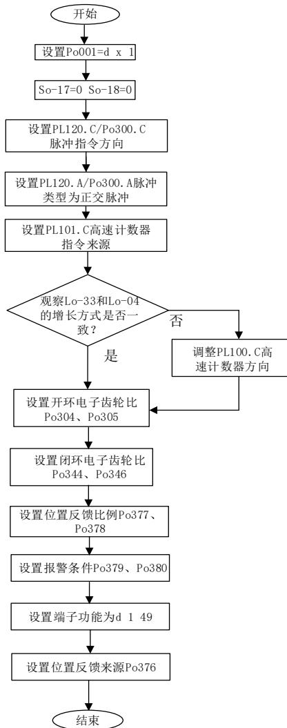
图 6.4.38 全闭环功能设置流程图
