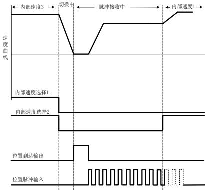
图 6.5.1 速度及位置脉冲模式切换模式时序
