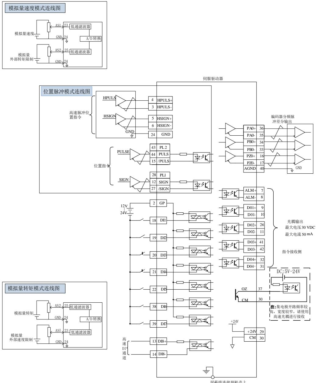
图 4.3.1 三种模式下接线示意图
