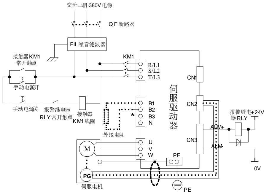
图 4.1.8 380V 驱动器典型主电路配线图
