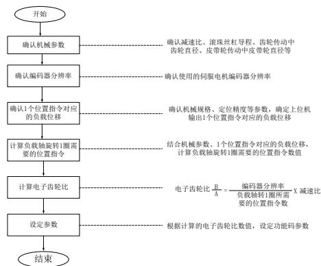
图 6.4.17 电子齿轮比设置步骤流程图
