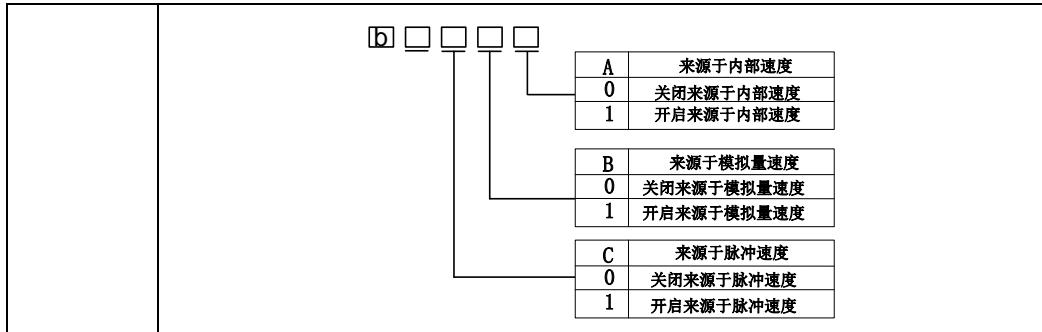
当速度指令来源于脉冲速度时，电机速度等于脉冲信号经过电子齿轮比折算之后的速度。
