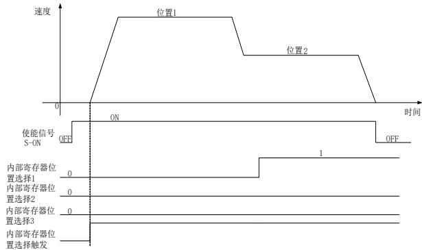
图 6.4.13 多段位置循环无间隔时间时序图
