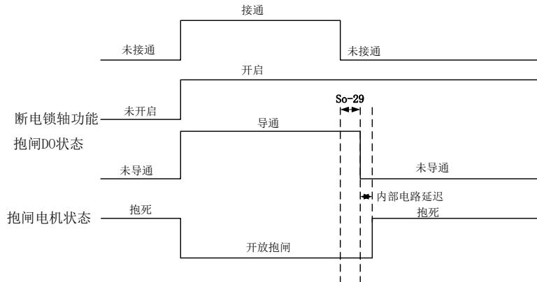
图 6.1.10 断电开启锁轴功能的时序图
