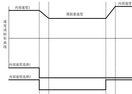
图 6.5.8 模拟量速度及内部速度模式时序图
