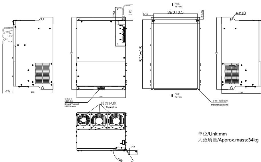
图 3.1.12 伺服驱动器结构尺寸 11
