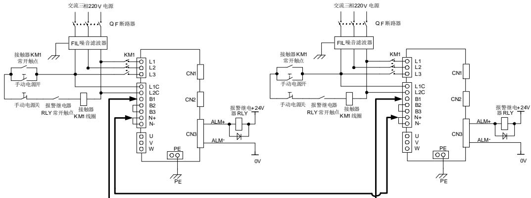
图 4.1.9 220V 驱动器共直流母线配线图
