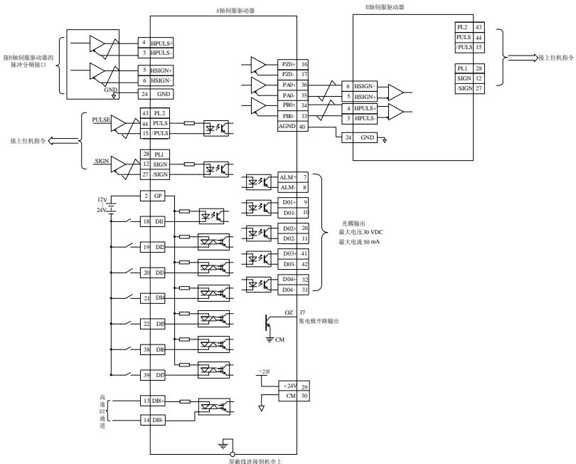
图 6.4.44 龙门同步典型接线图
