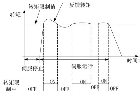
图 6.3.6 转矩限制中输出示意图
