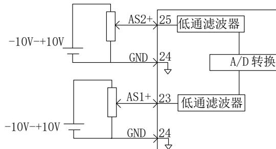
图 4.3.11 模拟量输入接口电路
