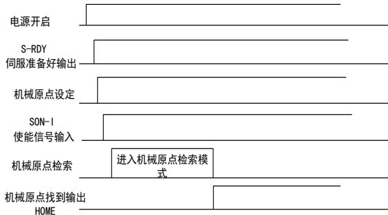
图 6.4.33 机械原点检索模式启动时序图
