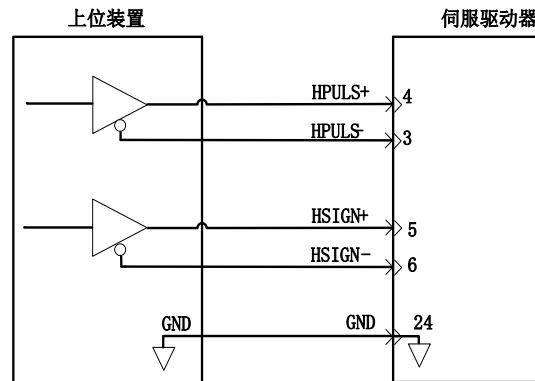
图 4.3.10 高速脉冲输入接口电路
