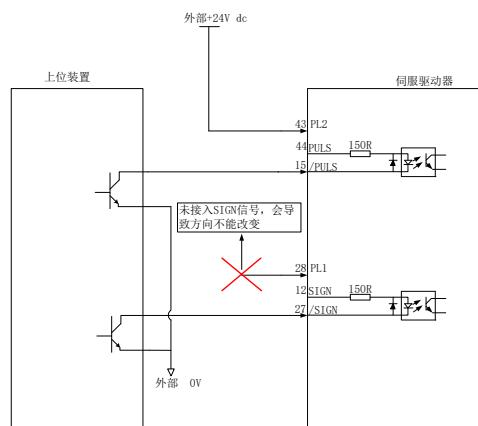
图 4.3.8 24V 集电极开路接线错误示意图 2
