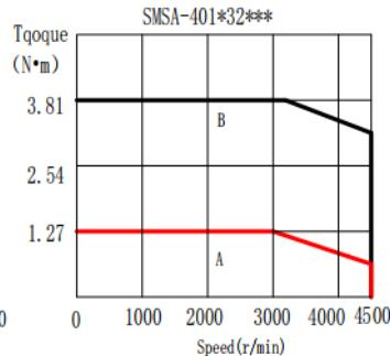
80 法兰伺服电机转矩-转速特性曲线
