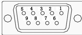
图 4.2.5 Biss-C 型编码器端子排列示意图
