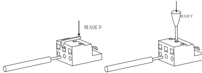
图 4.1.5 主电路端子使用方法
