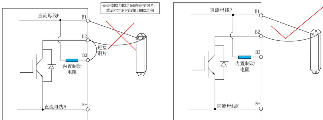
图 6.1.17 伺服制动电阻接线示意图
