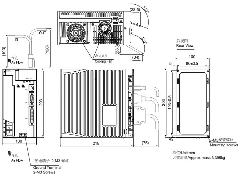
图 3.1.5 伺服驱动器结构尺寸 5
