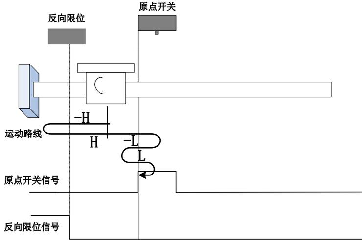
开始回零时 ORGP=0，以反向高速开始回零，遇到限位开关，自动反向，正向高速运行，遇到 ORGP 上升沿后，减速反向运行，反向低速遇到 ORGP 下降沿后，反向，正向低速运行中遇到 ORGP 上升沿折返到上升沿；
