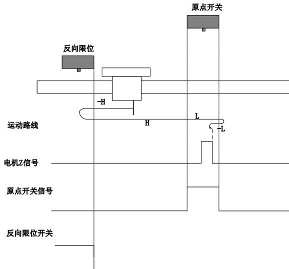
开始回零时 ORGP=0，以反向高速开始回零，遇到限位开关，自动反向，正向高速运行，遇到 ORGP 上升沿后，减速，正向低速运行，遇到 ORGP 下降沿后，反向，反向低速运行，遇到 ORGP 上
