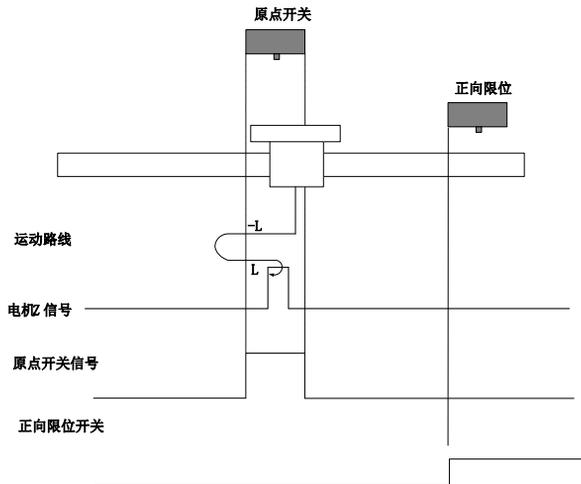
回零启动时 ORGP=1，则直接反向低速开始回零，遇到 ORGP 下降沿后，反向，正向低速，遇到
