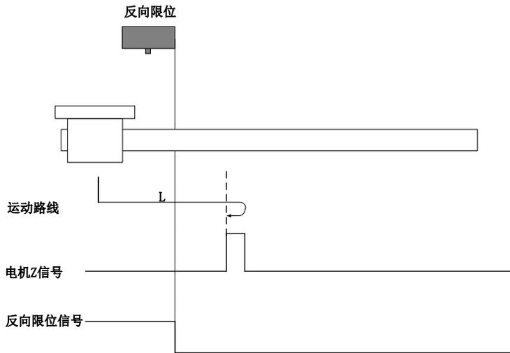
回零启动时 R-INH=1，直接正向低速开始回零，遇到 R-INH 下降沿后的 Z 信号折返到 Z 信号；
