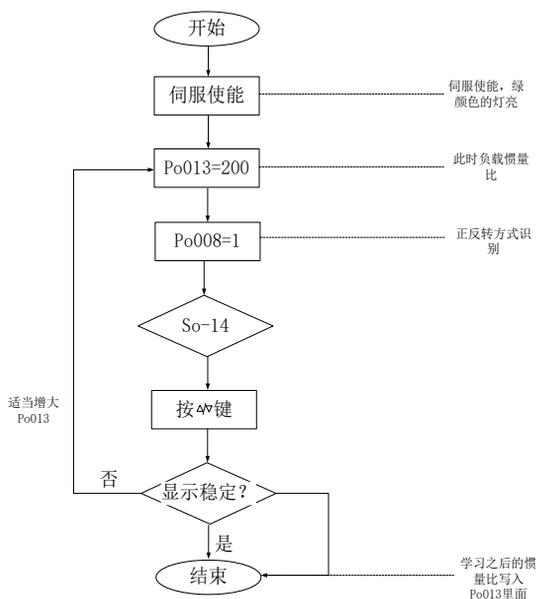
图 8.2.1 离线式转动惯量设置流程图
