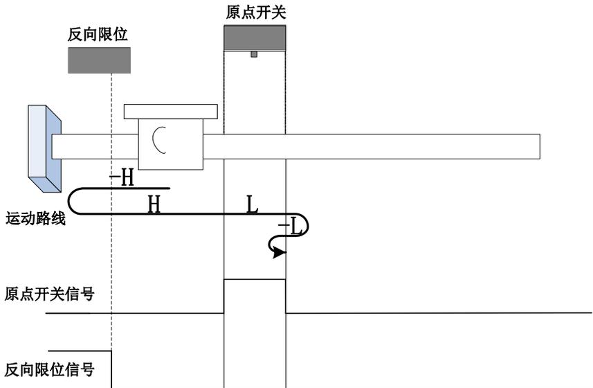
开始回零时 ORGP=0，以反向高速开始回零，遇到限位开关，自动反向，正向高速运行，遇到 ORGP 上升沿后，减速，正向低速运行，遇到 ORGP 下降沿后，反向，反向低速运行，遇到 ORGP 上
