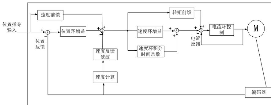
图 8.3.1 伺服驱动器内部框架图
