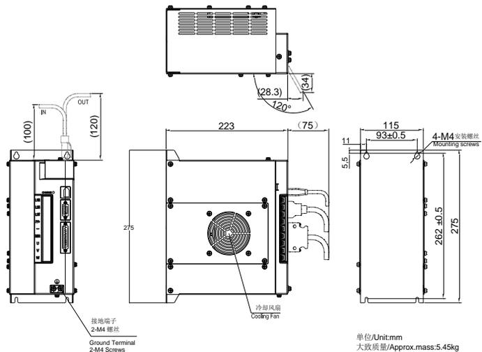
图 3.1.6 伺服驱动器结构尺寸 6
