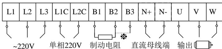
图 4.1.3 220V 伺服功率端子接线示意图
