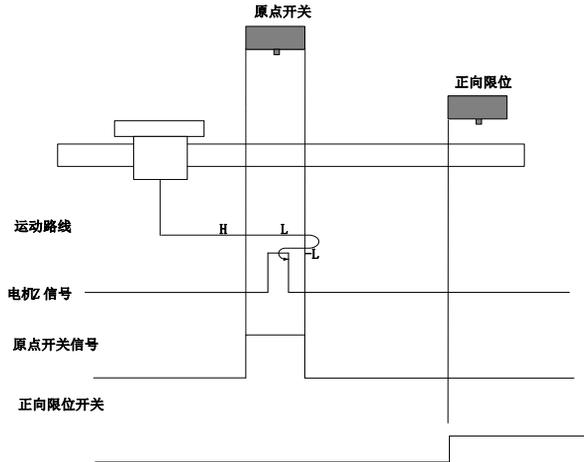
开始回零时 ORGP=0，以正向高速开始回零，若未遇到限位开关，遇到 ORGP 上升沿后，减速，正向低速运行，遇到 ORGP 下降沿后，反向，反向低速运行，遇到 ORGP 上升沿后的 Z 信号折返到 Z 信号；
