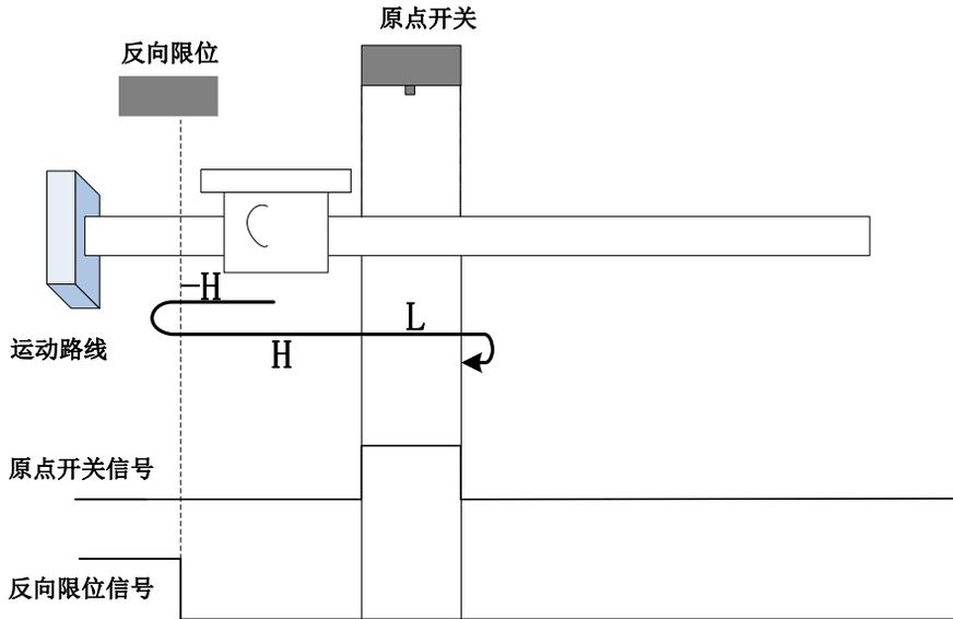
开始回零时 ORGP=0，以反向高速开始回零，遇到限位开关，自动反向，正向高速运行，遇到 ORGP 上升沿后，减速，继续正向低速运行，遇到 ORGP 下降沿折返到下降沿；
