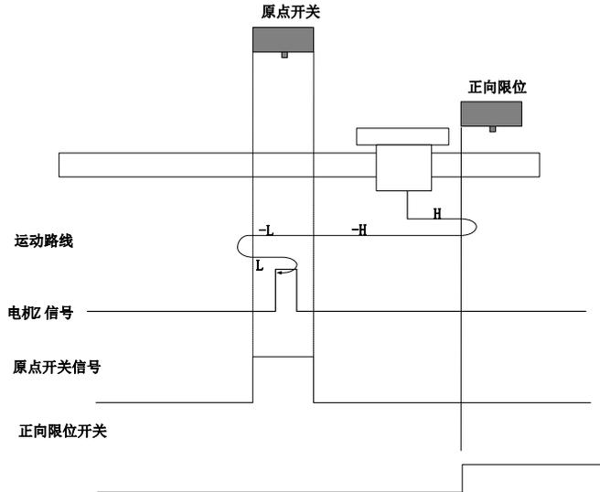
开始回零时 ORGP=0，以正向高速开始回零，若遇到限位开关，自动反向，反向高速运行，遇到 ORGP 上升沿后，减速，反向低速运行，遇到 ORGP 下降沿后，反向，正向低速，遇到 ORGP 上升沿后的信号 Z 折返到 Z 信号；
