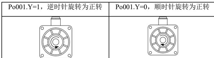
图 6.1.6 电机旋转方向示意图
