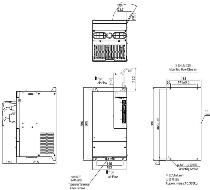
图 3.1.8 伺服驱动器结构尺寸 8
