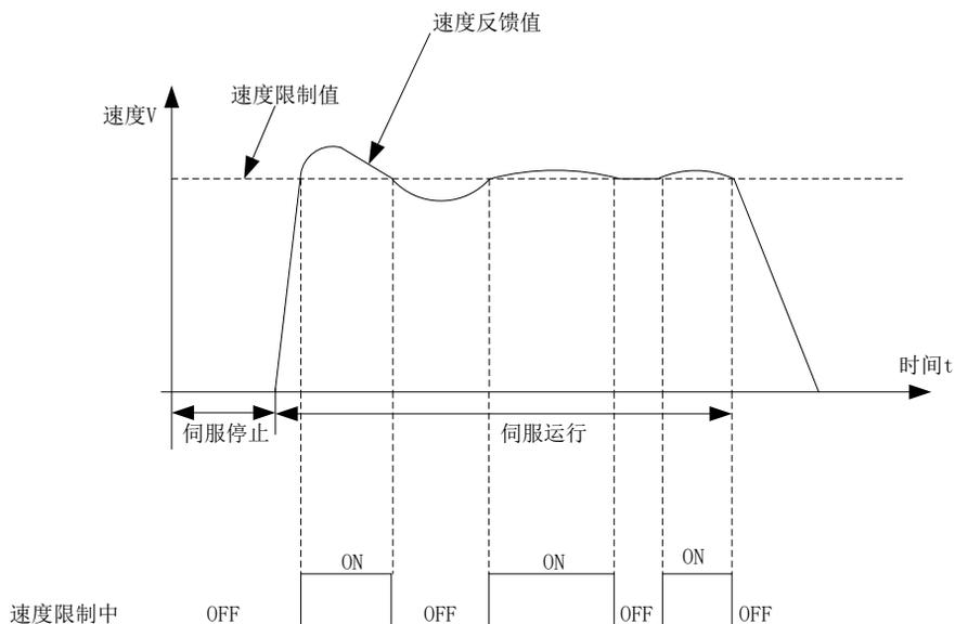
图 7.3.2 转矩模式下速度限制中输出示意图
