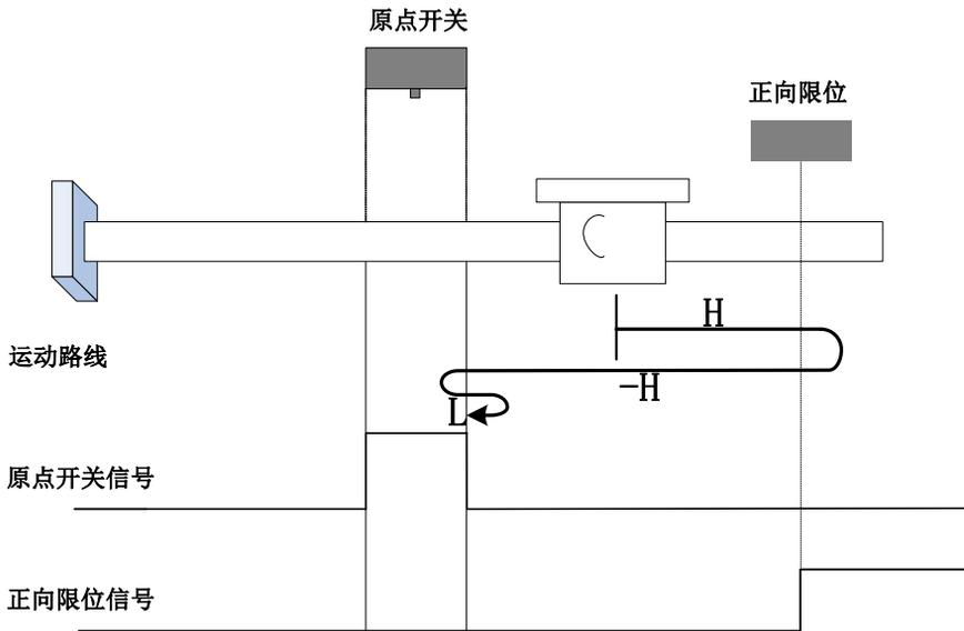
开始回零时 ORGP=0，以正向高速开始回零，遇到限位开关，自动反向，反向高速运行，遇到 ORGP 上升沿后，减速反向即恢复正向运行，正向低速遇到 ORGP 下降沿折返到下降沿：
