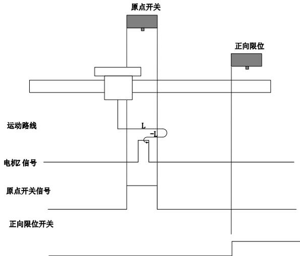
回零启动时 ORGP=1，则直接正向低速开始回零，遇到 ORGP 下降沿后，反向，反向低速运行中，遇到 ORGP 上升沿后的 Z 信号折返到 Z 信号；
