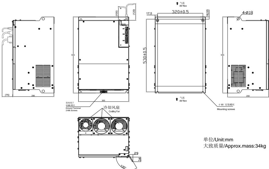
图 3.1.12 伺服驱动器结构尺寸 12
