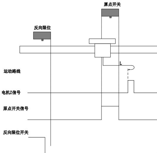
回零启动时 ORGP=1，则直接正向低速开始回零，遇到 ORGP 下降沿后的 Z 信号折返到 Z 信号；
