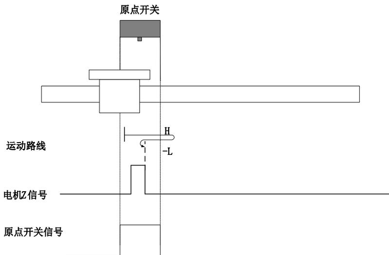
回零启动时 ORGP=1，以正向高速开始回零，遇到 ORGP 下降沿后，减速，反向，反向低速运行，遇到 ORGP 上升沿后的 Z 信号折返到 Z 信号；
