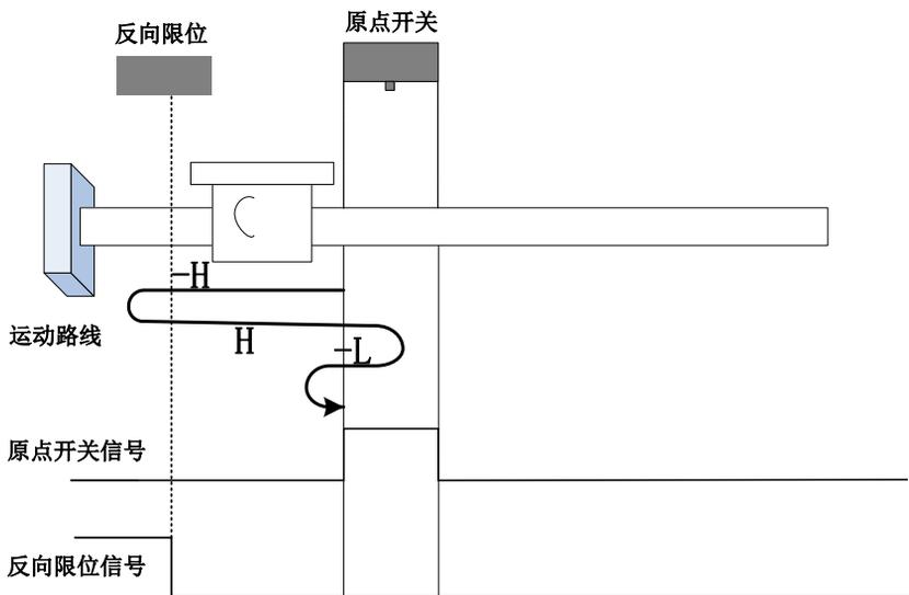
开始回零时 ORGP=0，以反向高速开始回零，遇到限位开关，自动反向，正向高速运行，遇到 ORGP 上升沿后，减速反向运行，反向低速遇到 ORGP 下降沿折返点下降沿：
