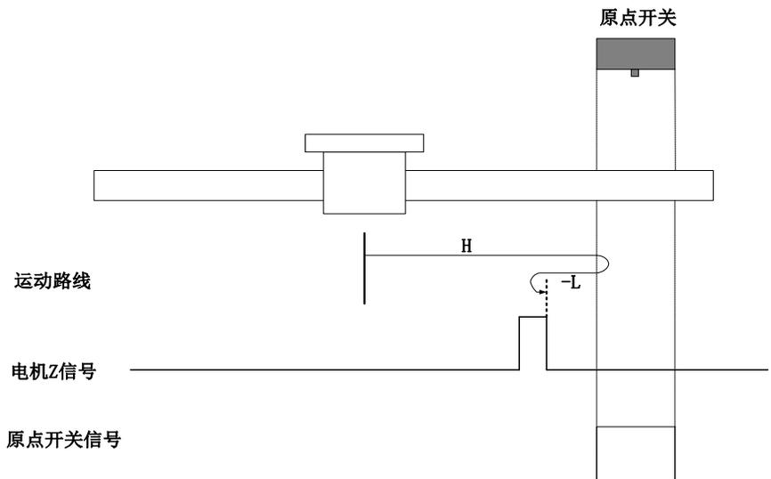
开始回零时  $ORGP=0$ ，以正向高速开始回零，遇到  $ORGP$  上升沿后，减速，反向，反向低速运行，遇到  $ORGP$  下降沿后，继续运行，之后遇到 Z 信号折返到 Z 信号；
