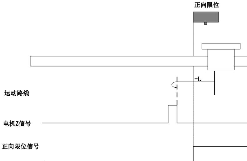
回零启动时  $F\text{-INH}=1$ ，直接反向低速开始回零，遇到  $F\text{-INH}$  下降沿后 Z 信号折返到 Z 信号；
