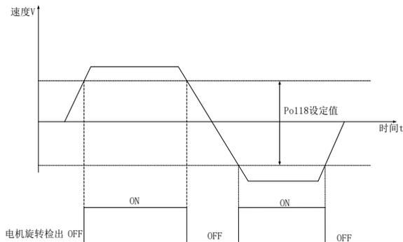
图 7.2.6 旋转检出信号输出示意图
