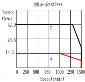
180 法兰伺服电机转矩-转速特性曲线
