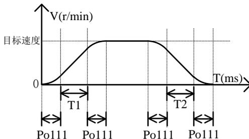
图 7.2.3 S 曲线平滑功能的示意图
