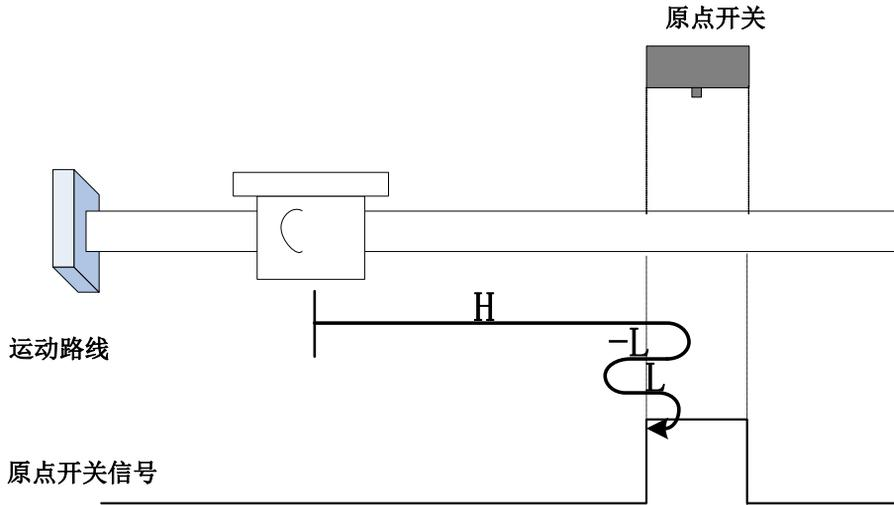
开始回零时 ORGP=0，以正向高速开始回零，未遇到限位开关，遇到 ORGP 上升沿后，减速，反向，反向低速运行，遇到 ORGP 下降沿后，反向，正向低速运行，遇到 ORGP 上升沿折返到上升沿；
