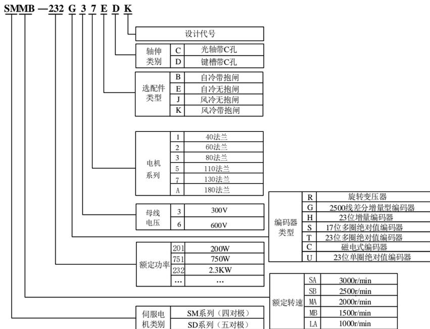
图 2.2.1 伺服电机命名规则 (180 及以下法兰电机)
