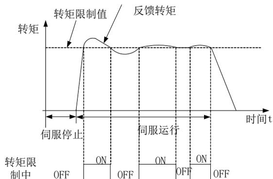
图 7.2.9 转矩限制中输出示意图
