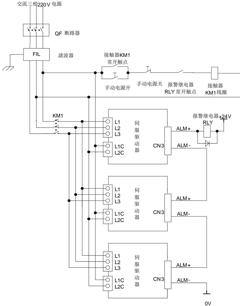
图 4.3.24 220V 多台联机时的接线
