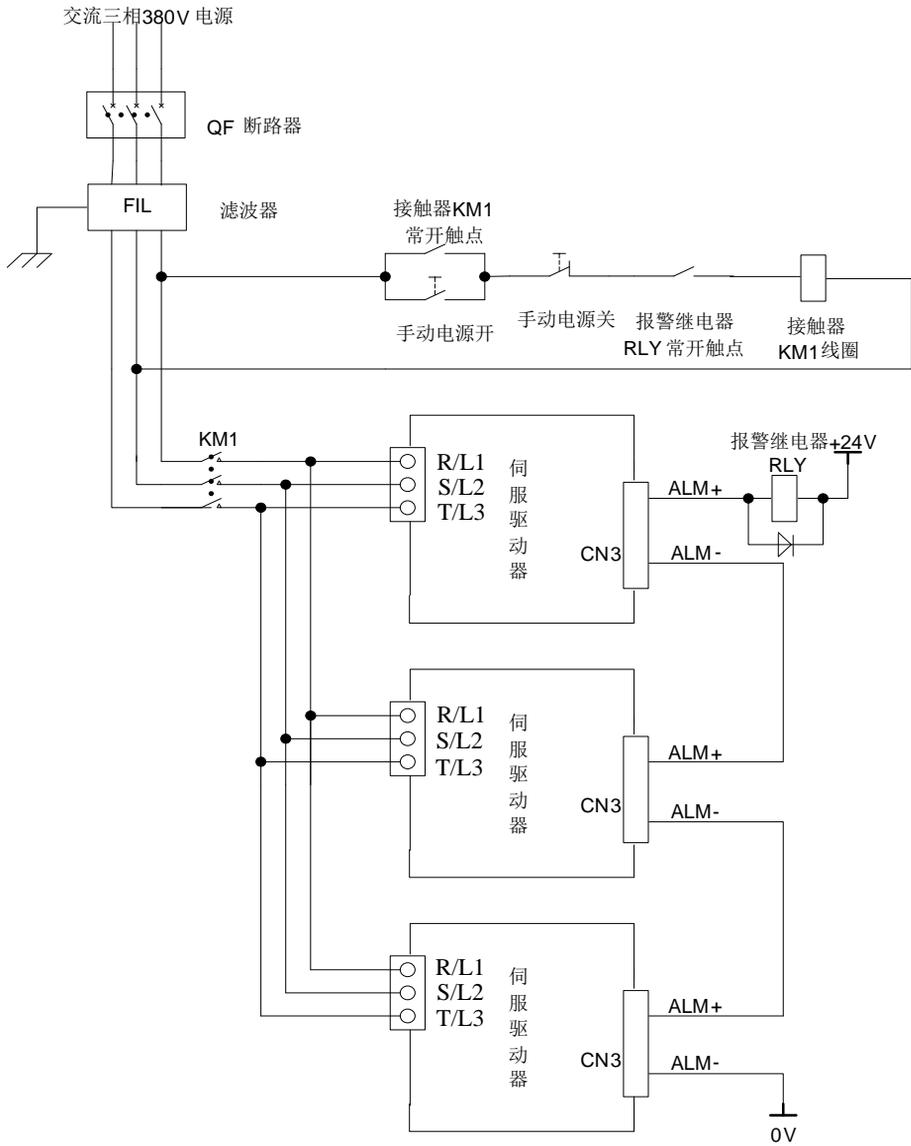
图 4. 3. 25 380V 多台联机时的接线
