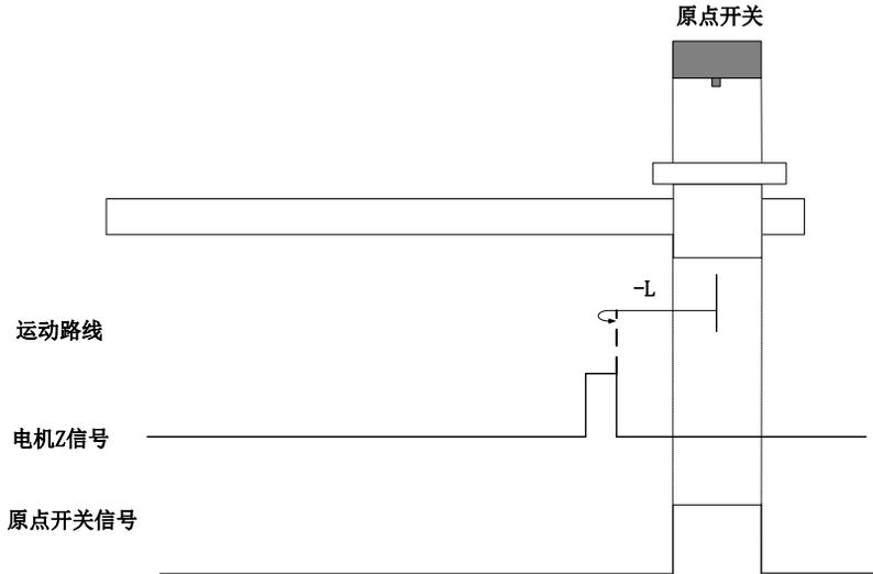
回零启动时  $ORGP=1$ ，直接反向低速开始回零，遇到  $ORGP$  下降沿后的 Z 信号折返到 Z 信号；
