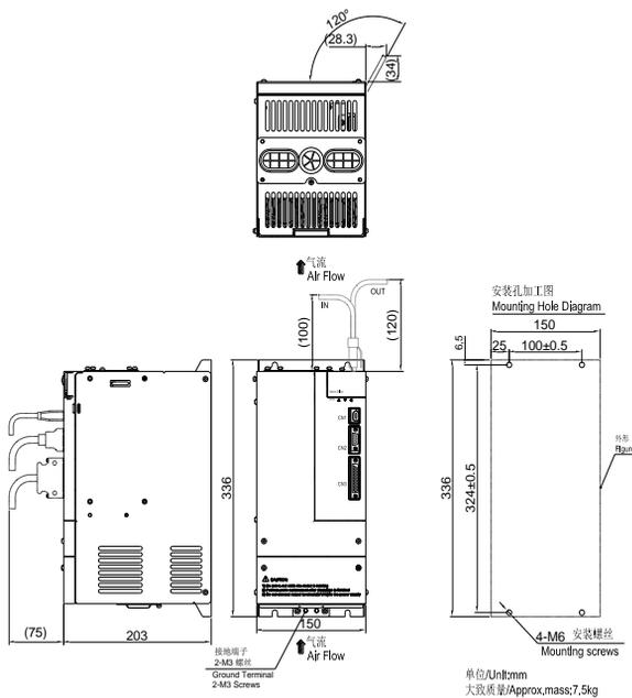
图 3.1.7 伺服驱动器结构尺寸 7
