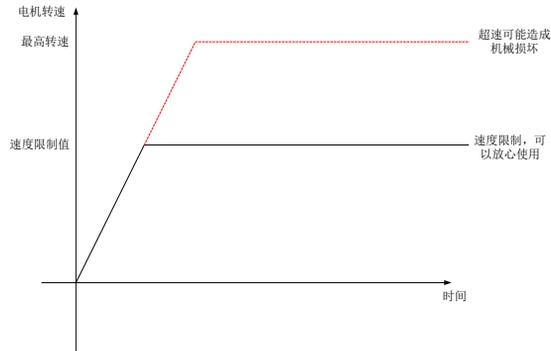
图 7.2.8 转矩模式下速度限制示意图
