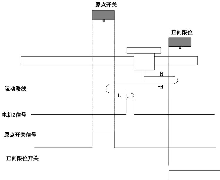
开始回零时 ORGP=0，以正向高速开始回零，若遇到限位开关，自动反向，反向高速运行，遇到 ORGP 上升沿后，减速反向即恢复正向运行，正向低速遇到 ORGP 下降沿后的 Z 信号折返到 Z 信号；
