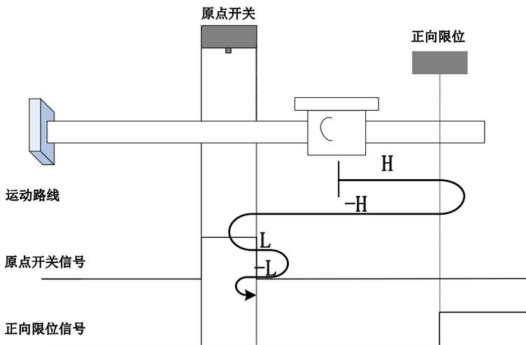
开始回零时 ORGP=0，以正向高速开始回零，遇到限位开关，自动反向，反向高速运行，遇到 ORGP 上升沿后，减速反向即恢复正向运行，正向低速遇到 ORGP 下降沿后，反向，反向低速运行中遇
