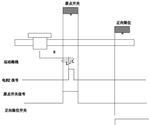
开始回零时 ORGP=0，以正向高速开始回零，若未遇到限位开关，遇到 ORGP 上升沿后，减速，反向，反向低速运行，遇到 ORGP 下降沿后，反向，正向低速运行，遇到 ORGP 上升沿后的 Z 信号折
