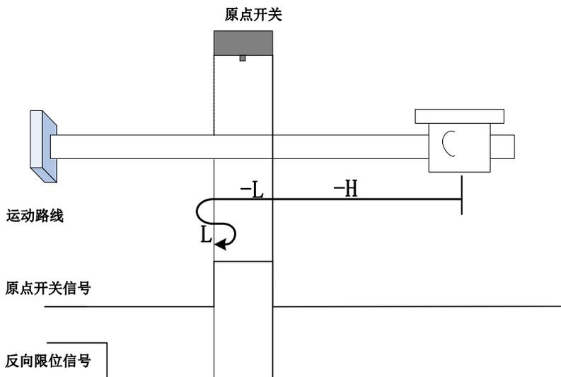
开始回零时 ORGP=0，以反向高速开始回零，未遇到限位开关，遇到 ORGP 上升沿后，减速，反向低速运行，遇到 ORGP 下降沿后，反向，正向低速运行，遇到 ORGP 上升沿折返到上升沿；
