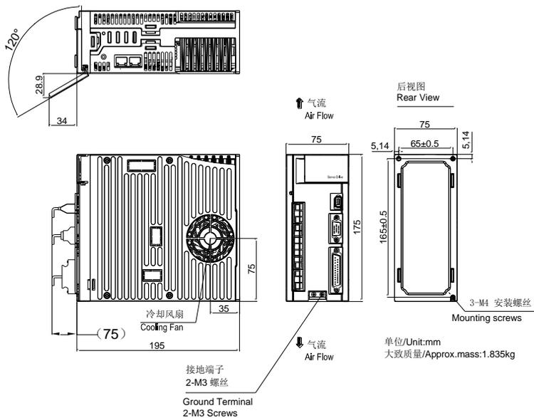
图 3.1.4 伺服驱动器结构尺寸 4
