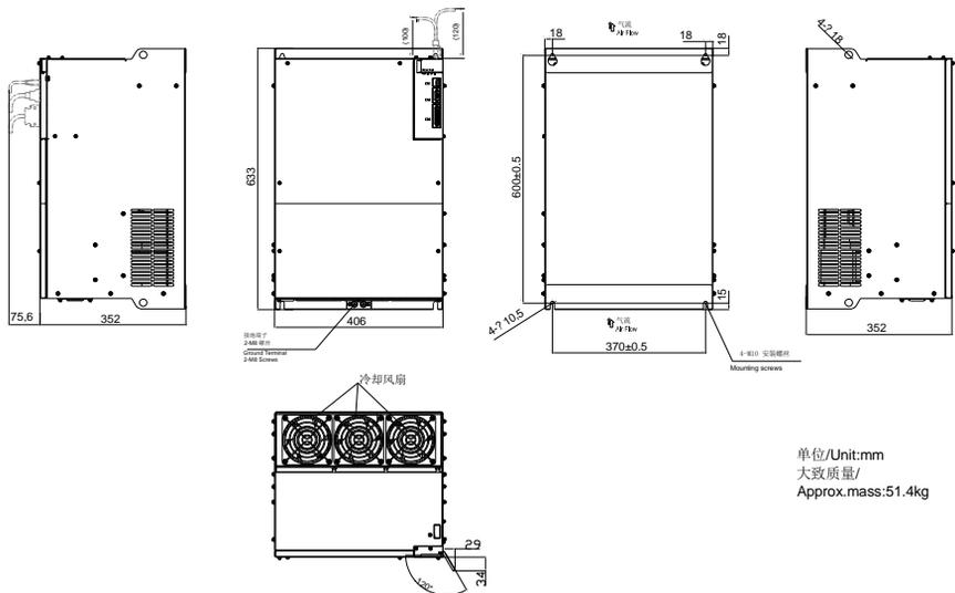
图 3.1.13 伺服驱动器结构尺寸 13
