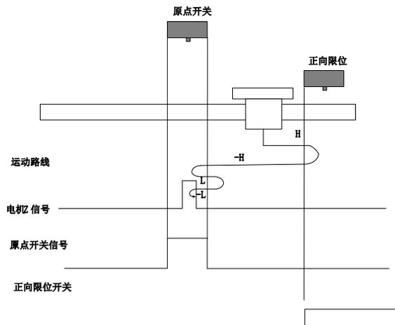
开始回零时 ORGP=0，以正向高速开始回零，若遇到限位开关，自动反向，反向高速运行，遇到
