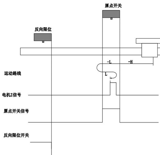
开始回零时 ORGP=0，以反向高速开始回零，若未遇到限位开关，遇到 ORGP 上升沿后，减速，反向低速运行，遇到 ORGP 下降沿后，反向，正向低速运行，遇到 ORGP 上升沿后的 Z 信号折返到 Z 信号；
