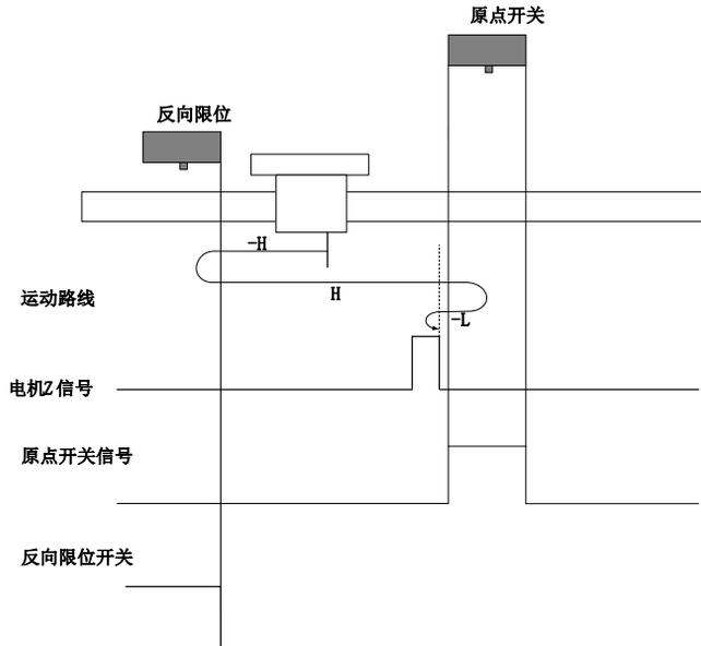
开始回零时 ORGP=0，以反向高速开始回零，遇到限位开关，自动反向，正向高速运行，遇到 ORGP 上升沿后，减速反向运行，反向低速遇到 ORGP 下降沿后的 Z 信号折返到 Z 信号；
