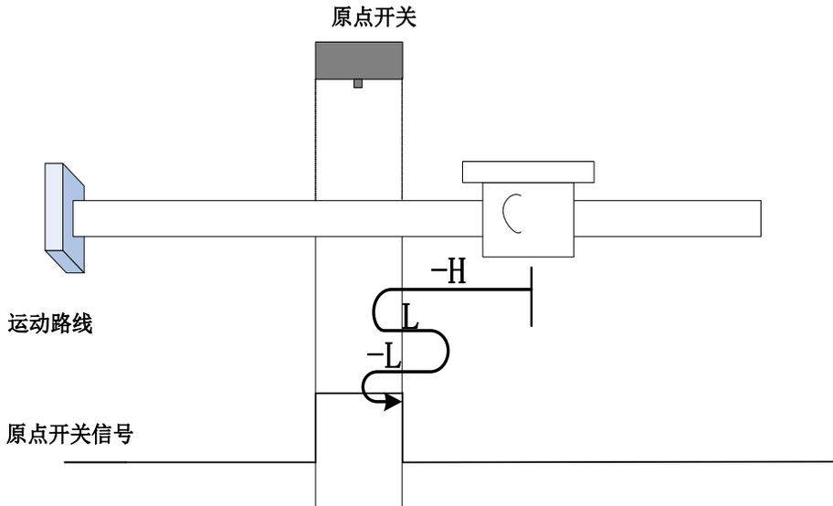
开始回零时 ORGP=0，以反向高速开始回零，未遇到限位开关，遇到 ORGP 上升沿后，减速，反向，正向低速运行，遇到 ORGP 下降沿后，反向，反向低速运行，遇到 ORGP 上升沿折返到上升沿；
