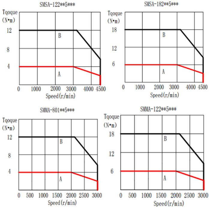
130 法兰伺服电机转矩-转速特性曲线
