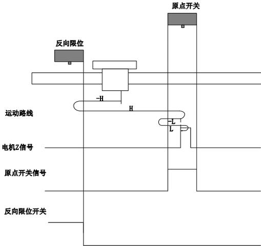
开始回零时 ORGP=0，以反向高速开始回零，遇到限位开关，自动反向，正向高速运行，遇到 ORGP 上升沿后，减速反向运行，反向低速遇到 ORGP 下降沿后，反向，正向低速运行中遇到 ORGP 上升沿后的 Z 信号折返到 Z 信号；
