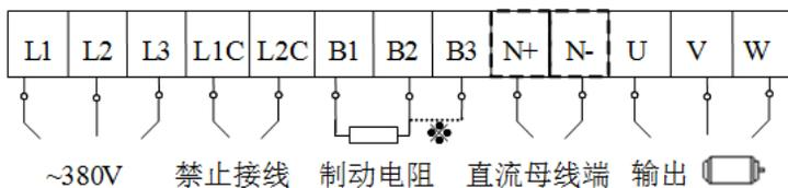
图 4.1.4.1 380V 伺服功率端子接线示意图
