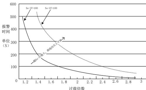
图 7.3.1 电机过载曲线与报警时间曲线图
