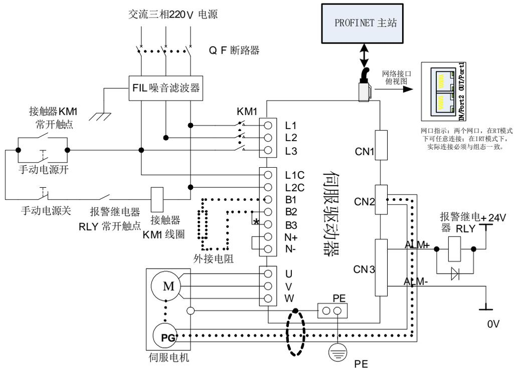
图 4.1.7 220V 驱动器典型主电路配线图
