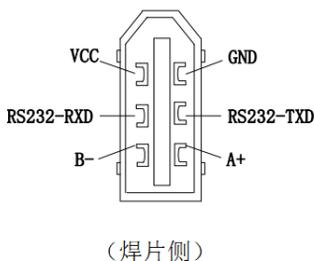
图 4.3.22 通讯口 CN1 插头端子排列顺序图
