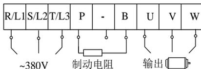
图 4.1.4.2 380V 伺服功率端子接线示意图
