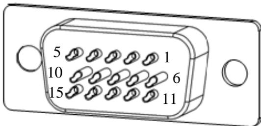
图 4.2.3 增量型编码器端子排列示意图
