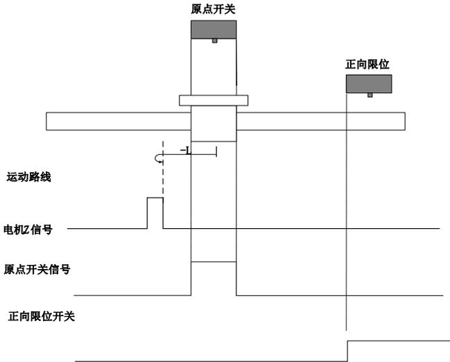
回零启动时 ORGP=1，则直接反向低速开始回零，遇到 ORGP 下降沿后的 Z 信号折返到 Z 信号；
