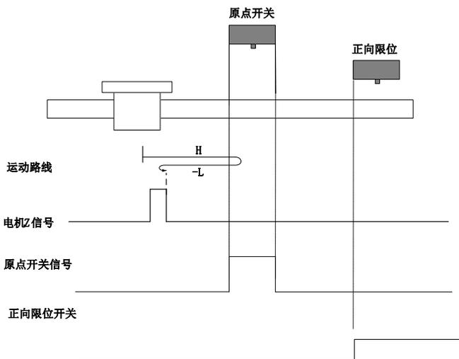
开始回零时 ORGP=0，以正向高速开始回零，若未遇到限位开关，遇到 ORGP 上升沿后，减速，反向，反向低速运行，遇到 ORGP 下降沿后的 Z 信号折返到 Z 信号；
