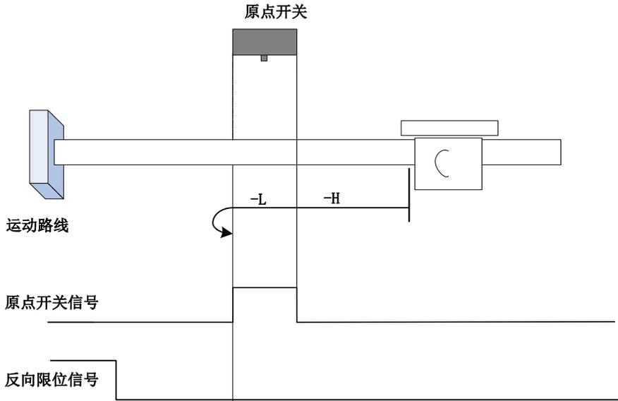
开始回零时 ORGP=0，以反向高速开始回零，未遇到限位开关，遇到 ORGP 上升沿后，减速，反向低速运行，遇到 ORGP 下降沿折返到下降沿：
