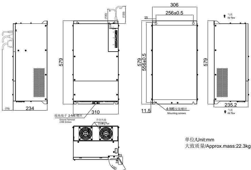
图 3.1.11 伺服驱动器结构尺寸 11
