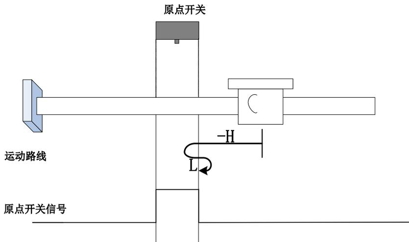
开始回零时  $ORGP=0$ ，以反向高速开始回零，遇到  $ORGP$  上升沿后，减速，反向，正向低速运
