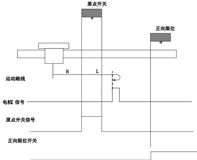
开始回零时 ORGP=0，以正向高速开始回零，若未遇到限位开关，遇到 ORGP 上升沿后，减速，正向低速运行，遇到 ORGP 下降沿后，继续正向低速运行，之后遇到的 Z 信号折返到 Z 信号；
