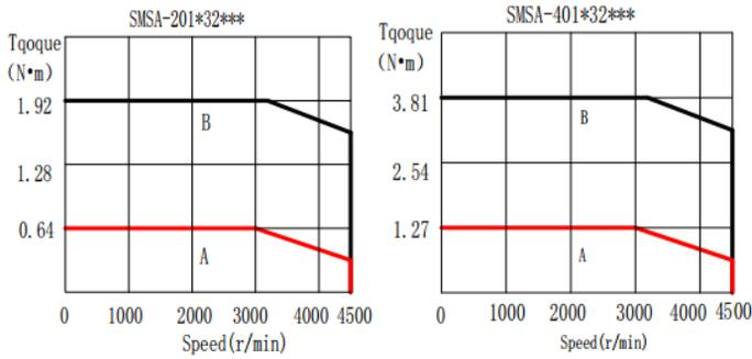
80 法兰伺服电机转矩-转速特性曲线
