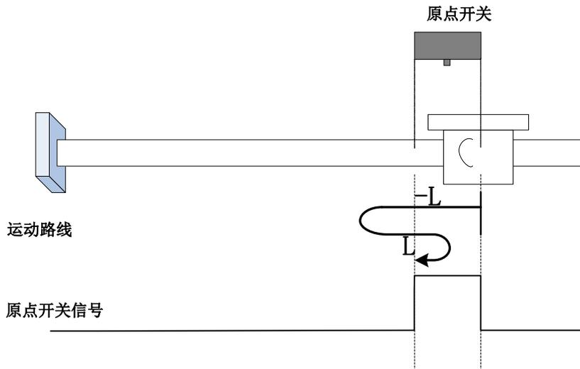
回零启动时  $ORGP=1$ ，则直接反向低速开始回零，遇到  $ORGP$  下降沿后，反向，正向低速，遇到  $ORGP$  上升沿折返到上升沿；
