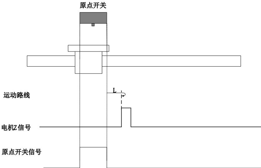
回零启动时 ORGP=1，则直接正向低速开始回零，遇到 ORGP 下降沿后的 Z 信号折返到 Z 信号；
