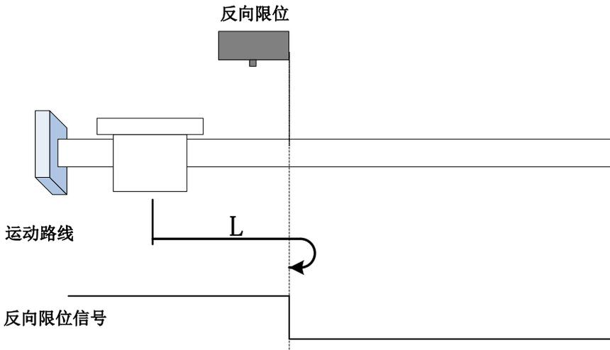
回零启动时 R-INH=1，直接正向低速开始回零，遇到 R-INH 下降沿后折返到下降沿。
