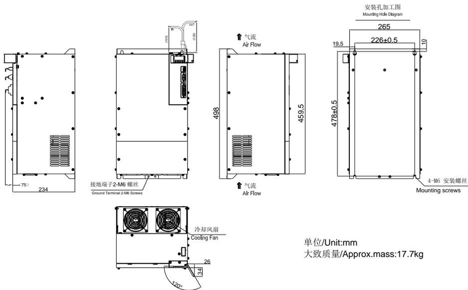
图 3.1.10 伺服驱动器结构尺寸 10
