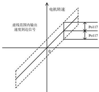
图 7.2.5 速度到达信号输出示意图
