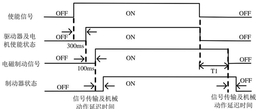
图 6.1.9 电磁抱闸制动时序图
