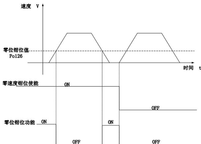
图 7.2.4 零速度钳位波形示意图
