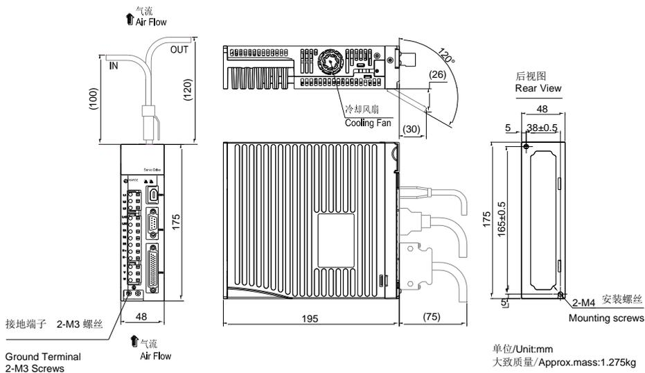
图 3.1.3 伺服驱动器结构尺寸 3
