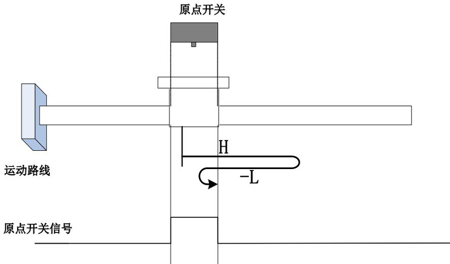
回零启动时  $ORGP=1$ ，以正向高速开始回零，遇到  $ORGP$  下降沿后，减速，反向，反向低速运行，遇到  $ORGP$  上升沿折返到上升沿；
