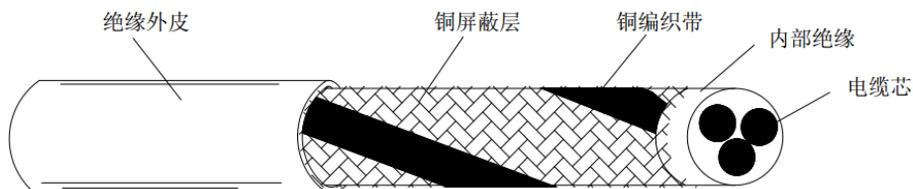
图 4.5.2 屏蔽线缆编制密度示意图
