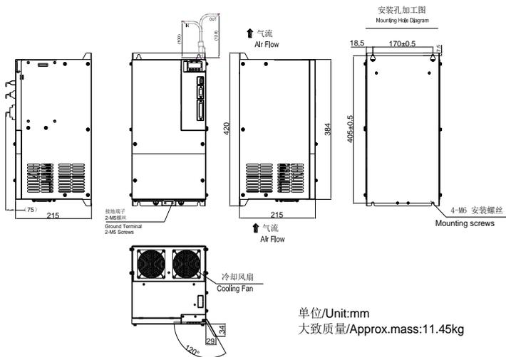
图 3.1.9 伺服驱动器结构尺寸 9
