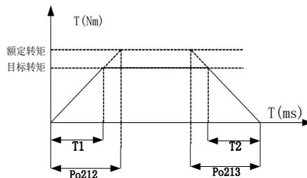
图 7.2.7 转矩模式下速度平滑功能示意图
