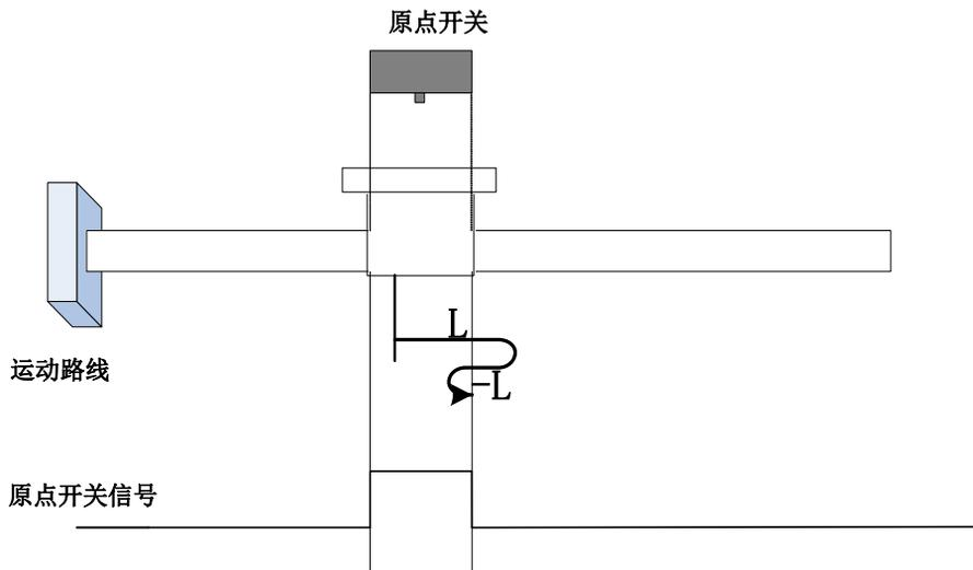
回零启动时  $ORGP=1$ ，则直接正向低速开始回零，遇到  $ORGP$  下降沿后，反向，反向低速，遇到  $ORGP$  上升沿折返到上升沿；
