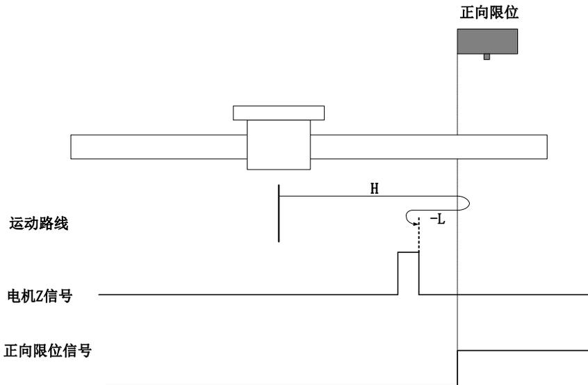
开始回零时 F-INH=0，以正向高速开始回零，遇到 F-INH 上升沿后，减速，反向，反向低速运行，遇到 F-INH 下降沿后的 Z 信号折返到 Z 信号；
