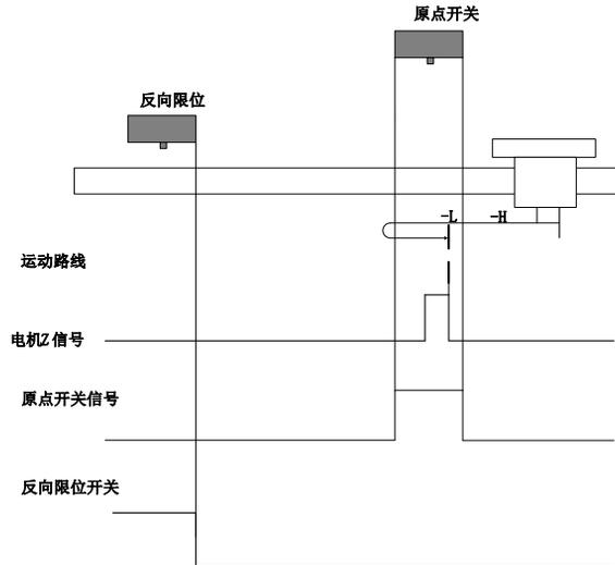
开始回零时 ORGP=0，以反向高速开始回零，未遇到限位开关，遇到 ORGP 上升沿后，减速，反向低速运行，遇到 ORGP 下降沿后，继续反向低速运行，之后遇到的 Z 信号折返到 Z 信号；
