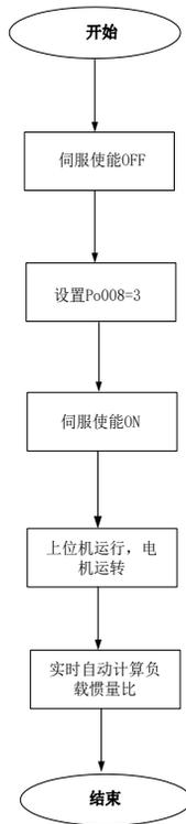
图 8.2.2 在线式转动惯量设置流程图
