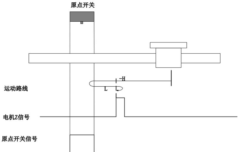
开始回零时 ORGP=0，以反向高速开始回零，遇到 ORGP 上升沿后，减速，反向，正向低速运行，遇到 ORGP 下降沿后的 Z 信号折返到 Z 信号；
