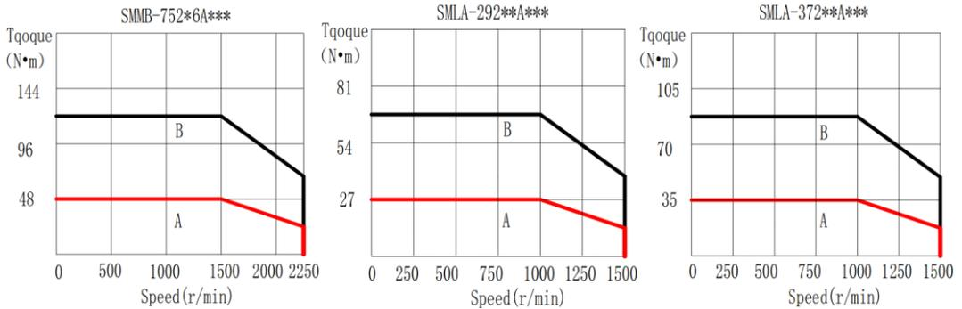
测试条件：1、60/80 法兰伺服电机安装在 260mm×260mm×28mm 铸铁法兰盘上测试；
