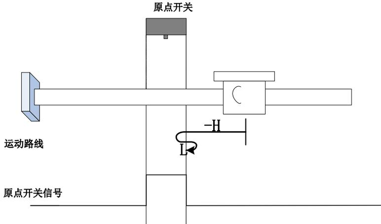
开始回零时 ORGP=0，以反向高速开始回零，未遇到限位开关，遇到 ORGP 上升沿后，减速，反向，正向低速运行，遇到 ORGP 下降沿折返到下降沿；
