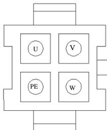
图 4. 4. 1 4 芯航电源安普插头示意图
