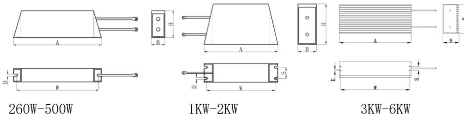
图 6.1.18 伺服制动电阻接线示意图
