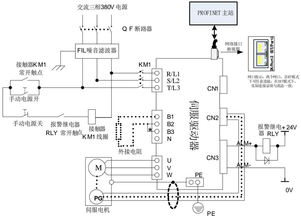
图 4.1.8 380V 驱动器典型主电路配线图
