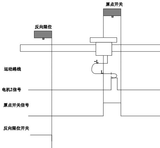
回零启动时 ORGP=1，则直接反向低速开始回零，遇到 ORGP 下降沿后，反向，正向低速运行
