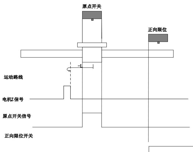
回零启动时  $ORGP=1$ ，则直接反向低速开始回零，遇到  $ORGP$  下降沿后的 Z 信号折返到 Z 信号；
