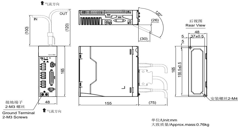
图 3.1.3 伺服驱动器结构尺寸 1
