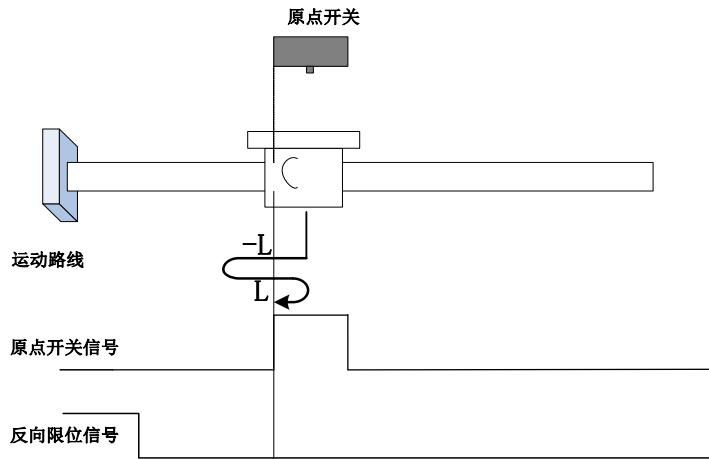
回零启动时 ORGP=1，则直接反向低速开始回零，遇到 ORGP 下降沿后，反向，正向低速运行中，遇到 ORGP 上升沿折返到上升沿；
