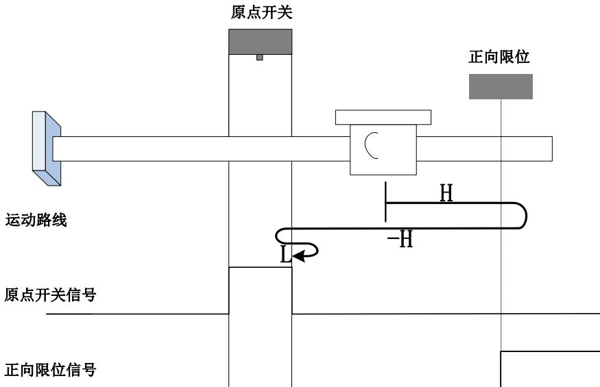
开始回零时 ORGP=0，以正向高速开始回零，遇到限位开关，自动反向，反向高速运行，遇到 ORGP 上升沿后，减速反向即恢复正向运行，正向低速遇到 ORGP 下降沿折返到下降沿；
