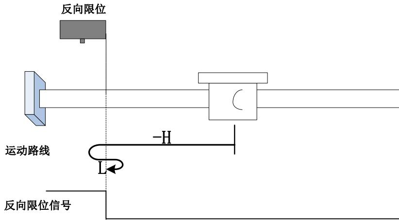
开始回零时 R-INH=0，以反向高速开始回零，遇到 R-INH 上升沿后，减速，反向，正向低速运行，遇到 R-INH 下降沿后折返到下降沿；
