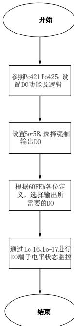
图 7.10.3 DO 信号强制输入设定步骤示意图
