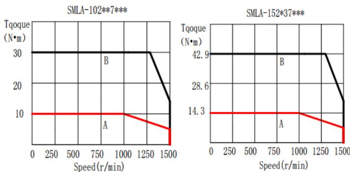
180 法兰伺服电机转矩-转速特性曲线
