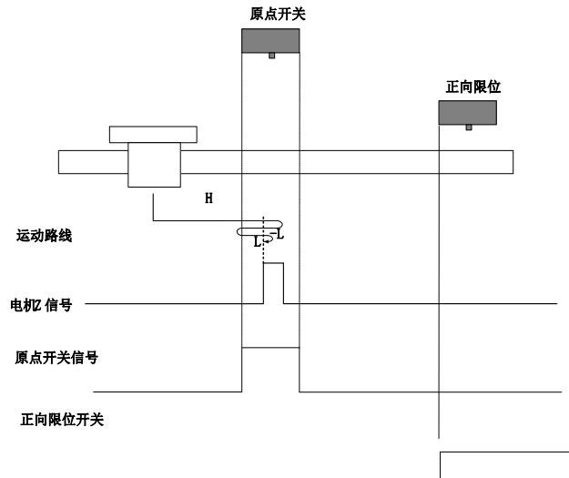
开始回零时  $ORG_P=0$ , 以正向高速开始回零, 若未遇到限位开关, 遇到  $ORG_P$  上升沿后, 减速, 反向, 反向低速运行, 遇到  $ORG_P$  下降沿后, 反向, 正向低速运行, 遇到  $ORG_P$  上升沿后的 Z 信号折返到 Z 信号;
