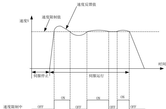
图 7.10.4 转矩模式下速度限制中输出示意图
