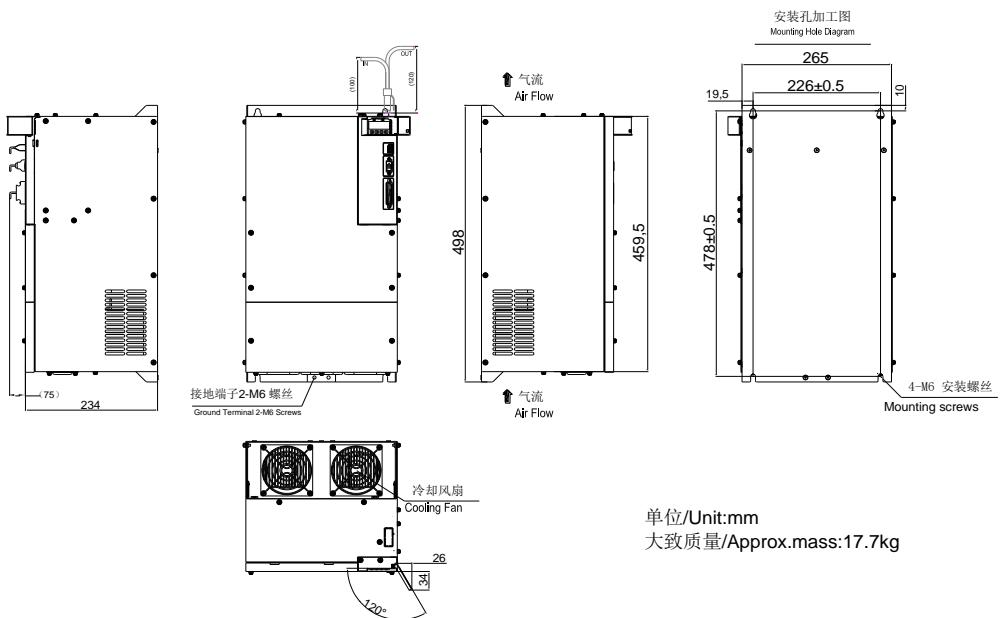
图 3.1.10 伺服驱动器结构尺寸 8
