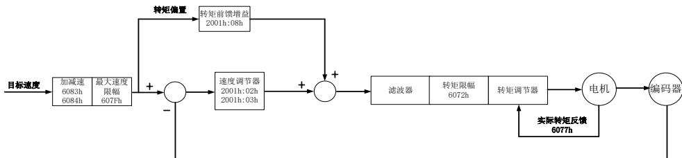
图 7.4.1 轮廓速度模式 (PV) 控制框图
