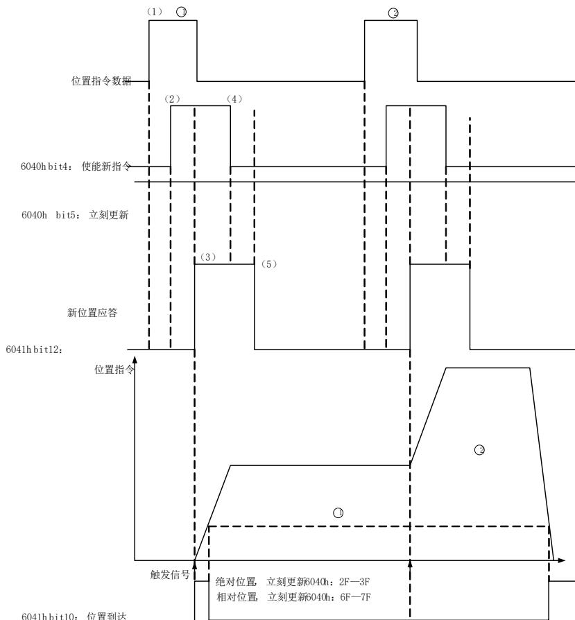
图 7.3.2 立刻更新型时序图与电机运行曲线
