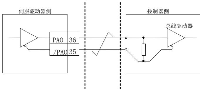
图 4.3.11 编码器分频输出的差分芯片接口电路
