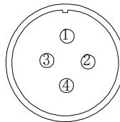
图 4.4.2 4 芯航电源航空插头示意图
