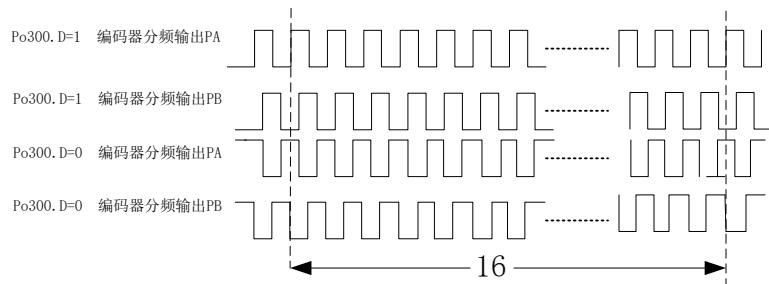
图 7.1.17 编码器信号分频示意图
