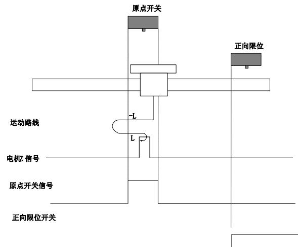
回零启动时  $ORG P=1$ ，则直接反向低速开始回零，遇到  $ORG P$  下降沿后，反向，正向低速，遇到  $ORG P$  上升沿后 Z 信号折返到 Z 信号；
