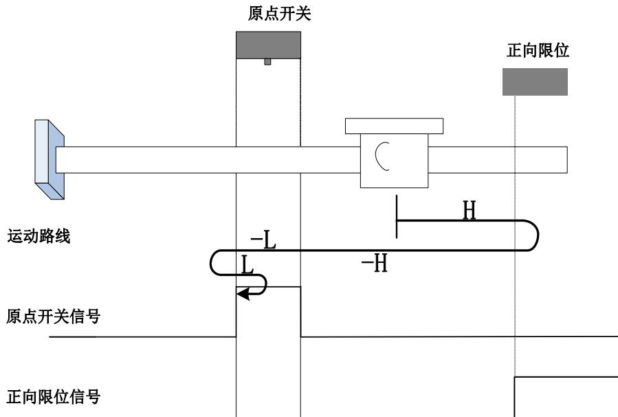
开始回零时  $ORGP=0$ ，以正向高速开始回零，遇到限位开关，自动反向，反向高速运行，遇到  $ORGP$  上升沿后，减速，反向低速运行，遇到  $ORGP$  下降沿后，反向，正向低速，遇到  $ORGP$  上升沿折返到上升沿；
