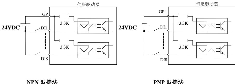
图 4.3.6 DI8 接线图示
