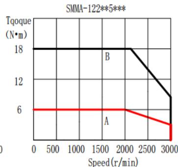
130 法兰伺服电机转矩-转速特性曲线
