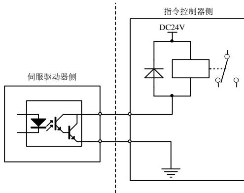
图 4.3.7 继电器输出接口正确电路示意图
