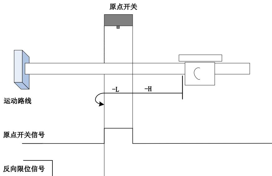
a) 回零启动时减速点信号无效，未遇到反向限位开关
