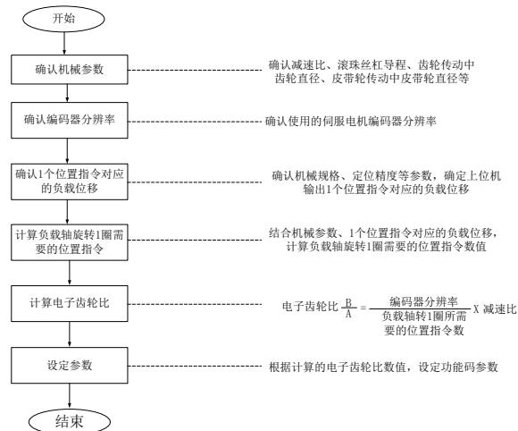
图 7.1.13 电子齿轮比设置步骤流程图
