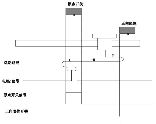
开始回零时  $ORG_P=0$ , 以正向高速开始回零, 若遇到限位开关, 自动反向, 反向高速运行, 遇到
