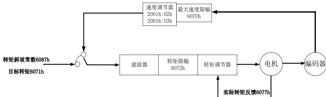
图 7.5.1 轮廓转矩模式 (PT) 控制框图
