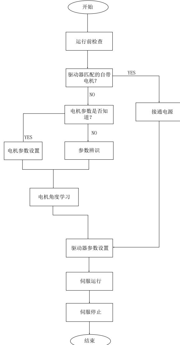
图 7.1 伺服驱动器设定流程简图
