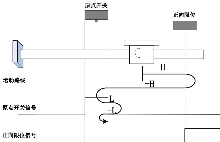
开始回零时 ORGP=0，以正向高速开始回零，遇到限位开关，自动反向，反向高速运行，遇到
