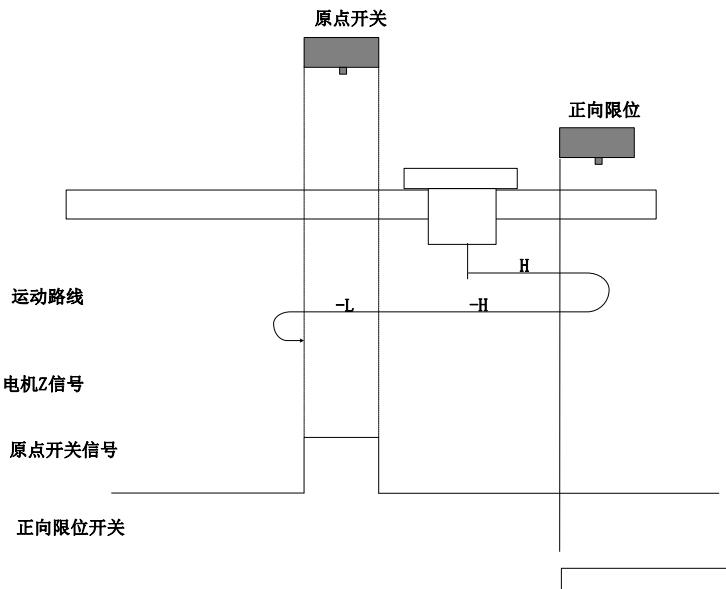
开始回零时 ORGP=0，以正向高速开始回零，遇到限位开关，自动反向，反向高速运行，遇到 ORGP 上升沿后，减速，继续反向低速运行，遇到 ORGP 下降沿折返到下降沿；
