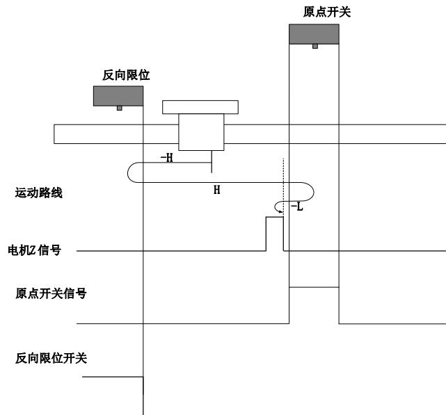
开始回零时 ORGP=0，以反向高速开始回零，遇到限位开关，自动反向，正向高速运行，遇到 ORGP 上升沿后，减速反向运行，反向低速遇到 ORGP 下降沿后的 Z 信号折返到 Z 信号；
