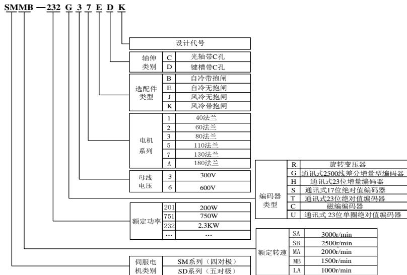
图 2.2.1 伺服电机命名規则 (180 及以下法兰电机)
