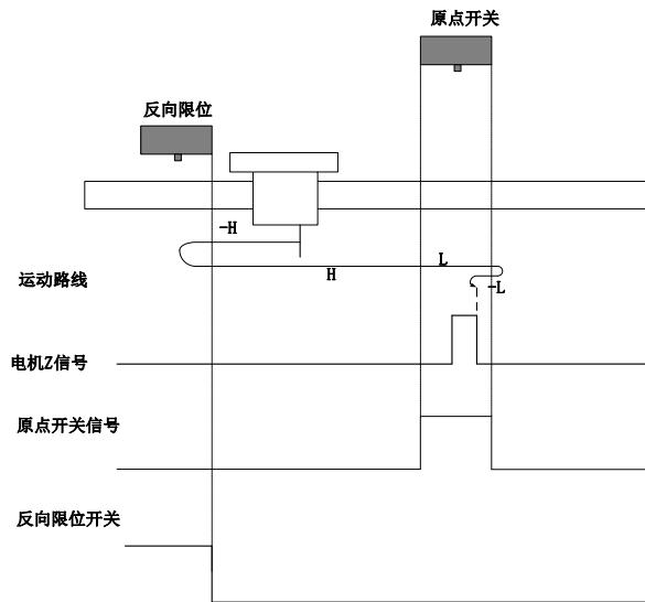
开始回零时 ORGP=0，以反向高速开始回零，遇到限位开关，自动反向，正向高速运行，遇到 ORGP 上升沿后，减速，正向低速运行，遇到 ORGP 下降沿后，反向，反向低速运行，遇到 ORGP 上升沿后 Z 信号折返到 Z 信号；
