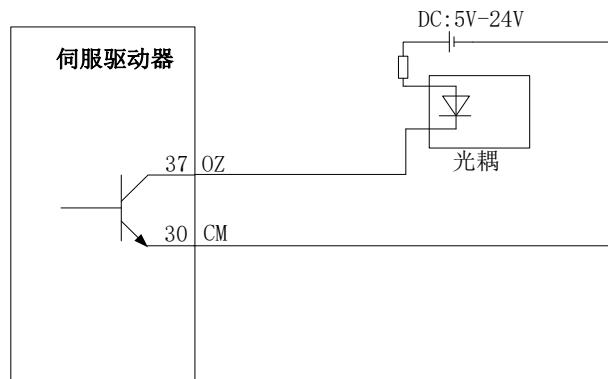
图 4.3.12 集电极 OZ 信号接口电路
