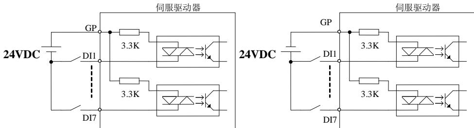
图 4.3.4 无源接点接口电路
