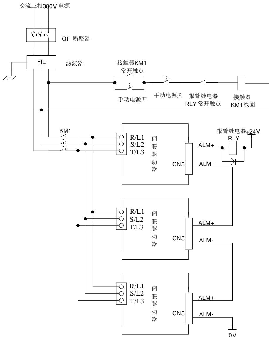
图 4.3.15 380V 多台联机时的接线
