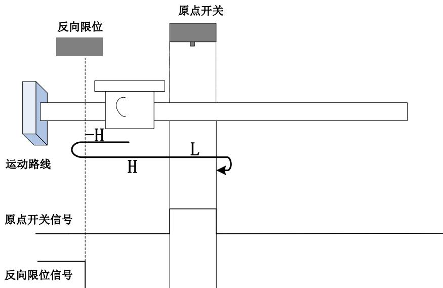
开始回零时 ORGP=0, 以反向高速开始回零, 遇到限位开关, 自动反向, 正向高速运行, 遇到
