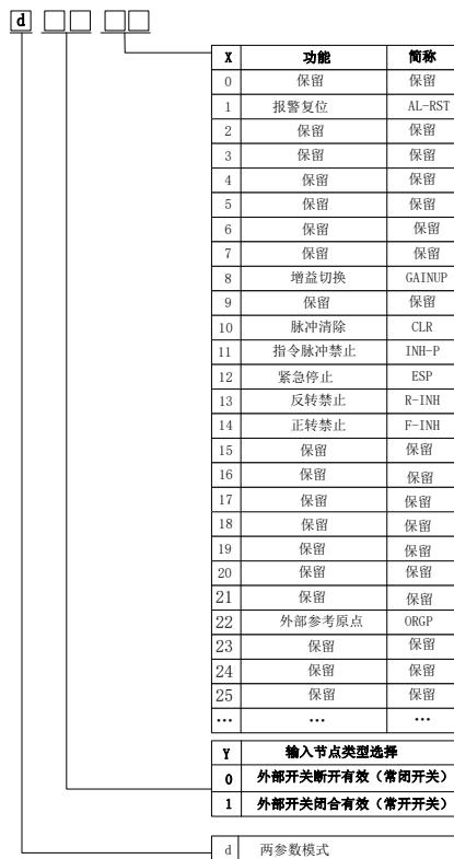
图 8.3.1 可编程输入端子功能设定示意图
