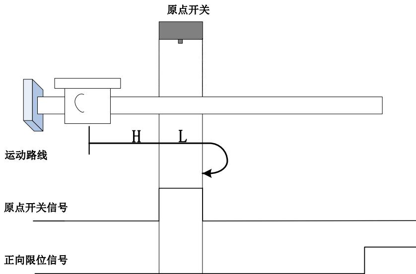
开始回零时 ORGP=0，以正向高速开始回零，未遇到限位开关，遇到 ORGP 上升沿后，减速，正向低速运行，遇到 ORGP 下降沿折返到下降沿；
