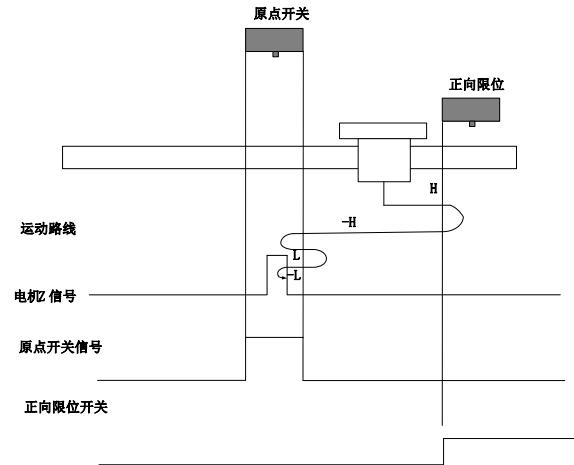
开始回零时 ORGP=0，以正向高速开始回零，若遇到限位开关，自动反向，反向高速运行，遇到 ORGP 上升沿后，减速反向即恢复正常运行，正向低速遇到 ORGP 下降沿后，反向，反向低速运行中遇到 ORGP 上升沿后的 Z 信号折返到 Z 信号；
