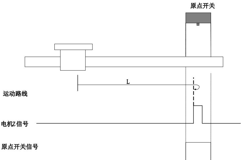
开始回零时 ORGP=0，直接正向低速开始回零，遇到 ORGP 上升沿后 Z 信号折返到 Z 信号；
