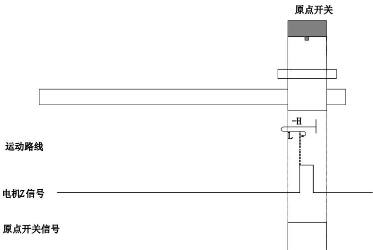
回零启动时 ORGP=1, 以反向高速开始回零, 遇到 ORGP 下降沿后, 减速, 反向, 正向低速运行, 遇到 ORGP 上升沿后的 Z 信号折返到 Z 信号;
