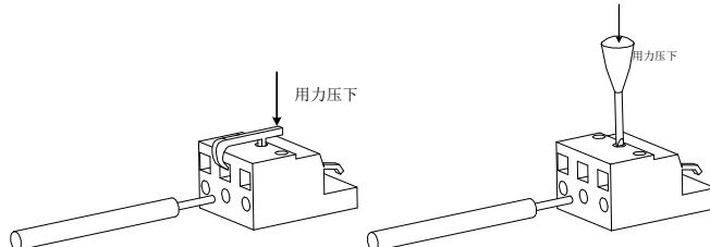
图 4.1.3 主电路端子使用方法
