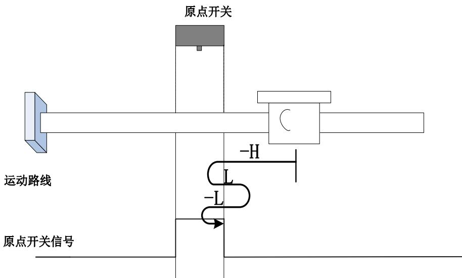
开始回零时 ORGP=0，以反向高速开始回零，未遇到限位开关，遇到 ORGP 上升沿后，减速，反
