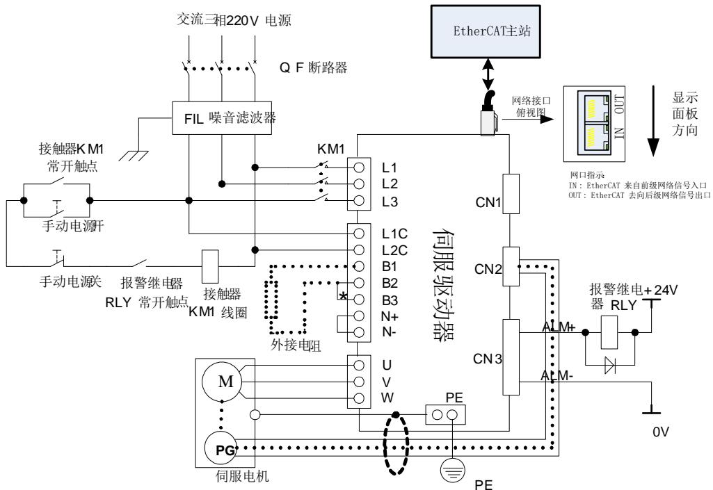
图 4.1.5 220V 驱动器典型主电路配线图
