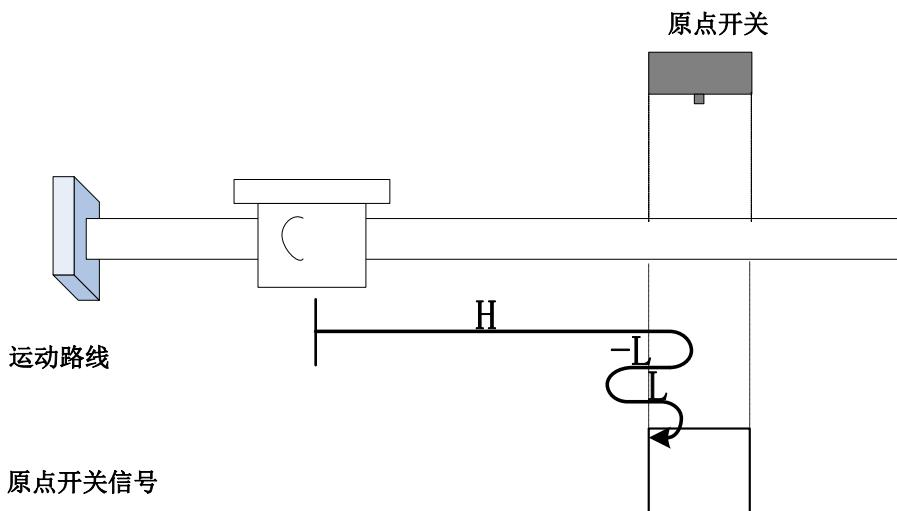
开始回零时 ORGP=0，以正向高速开始回零，未遇到限位开关，遇到 ORGP 上升沿后，减速，反
