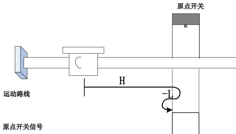
开始回零时 ORGP=0，以正向高速开始回零，未遇到限位开关，遇到 ORGP 上升沿后，减速，反向，反向低速运行，遇到 ORGP 下降沿折返到下降沿；
