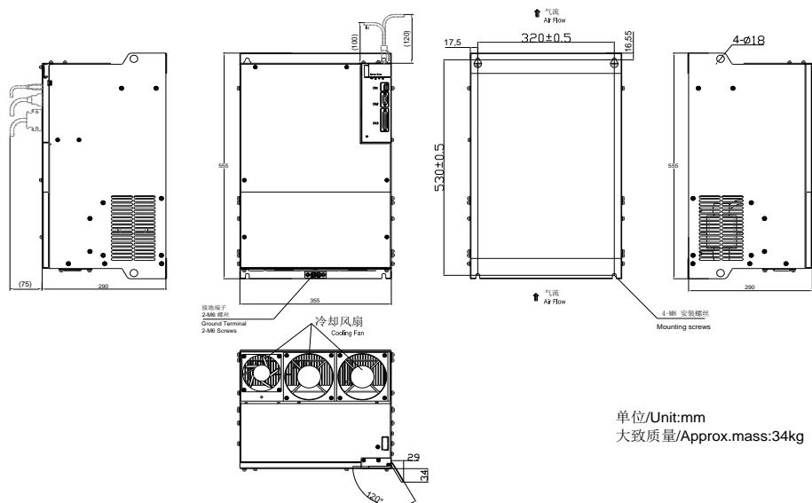
图 3.1.12 伺服驱动器结构尺寸 10
