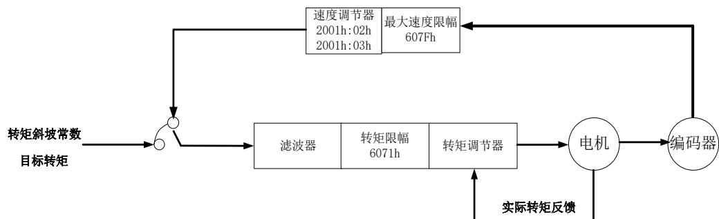
图 7.8.1 周期同步转矩 (CST) 控制框图
