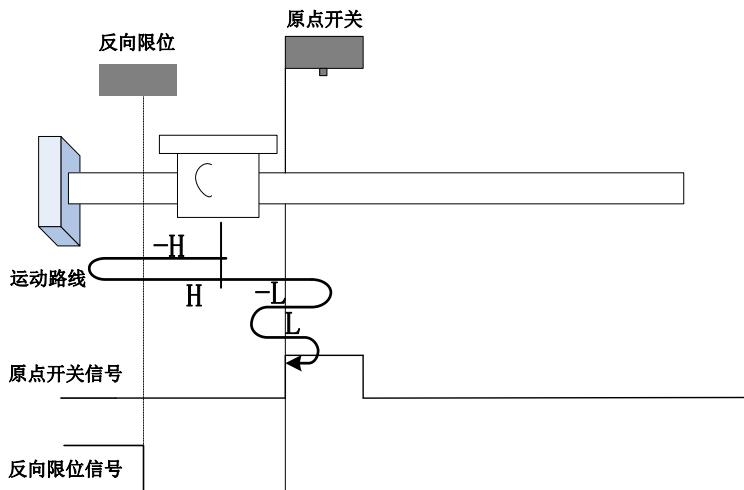
开始回零时 ORGP=0, 以反向高速开始回零, 遇到限位开关, 自动反向, 正向高速运行, 遇到 ORGP 上升沿后, 减速反向运行, 反向低速遇到 ORGP 下降沿后, 反向, 正向低速运行中遇到 ORGP
