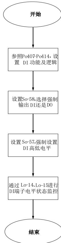
图 7.10.2 DI 信号强制输入设定步骤示意图
