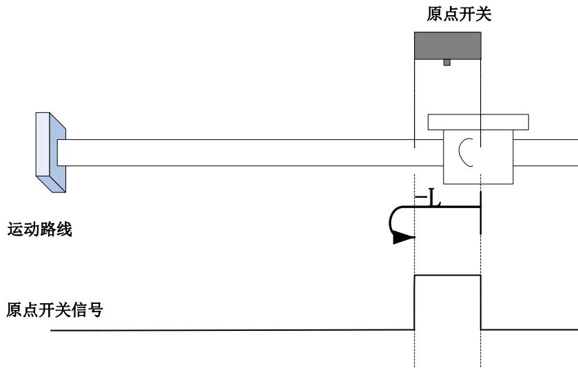
回零启动时 ORGP=1, 直接反向低速开始回零, 遇到 ORGP 下降沿折返到下降沿;
