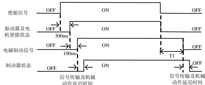
图 7.1.4 电磁抱闸制动时序图
