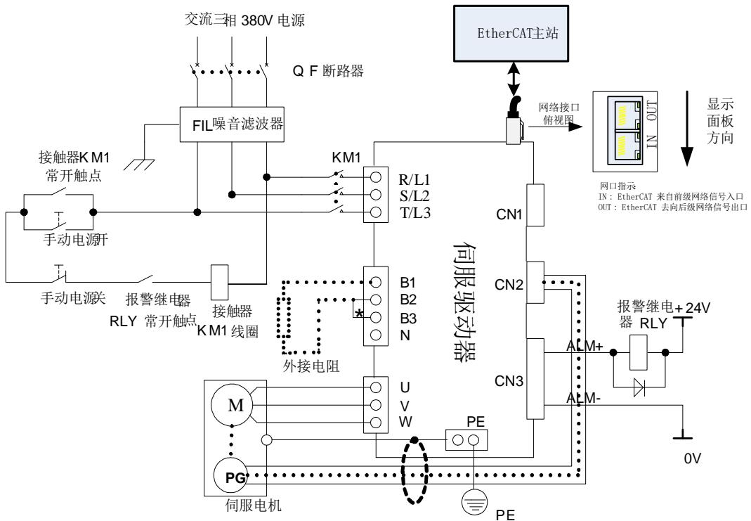
图 4.1.6 380V 驱动器典型主电路配线图
