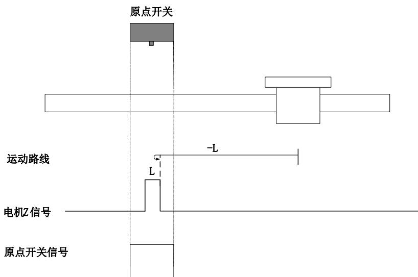
开始回零时 ORGP=0，直接反向低速开始回零，遇到 ORGP 上升沿后 Z 信号折返到 Z 信号；
