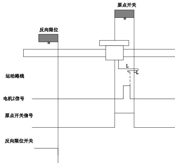
回零启动时 ORGP=1，则直接正向低速开始回零，遇到 ORGP 下降沿后，反向，反向低速，遇到 ORGP 上升沿后的 Z 信号折返到 Z 信号；
