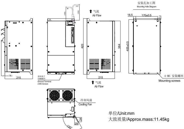
图 3.1.9 伺服驱动器结构尺寸 7
