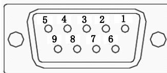
图 4.2.4 Biss-C 型编码器端子排列示意图
