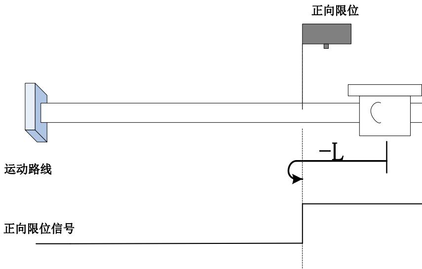
回零启动时 F-INH=1，直接反向低速开始回零，遇到 F-INH 下降沿停机折返到下降沿；
