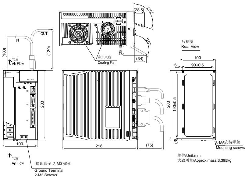
图 3.1.6 伺服驱动器结构尺寸 4
