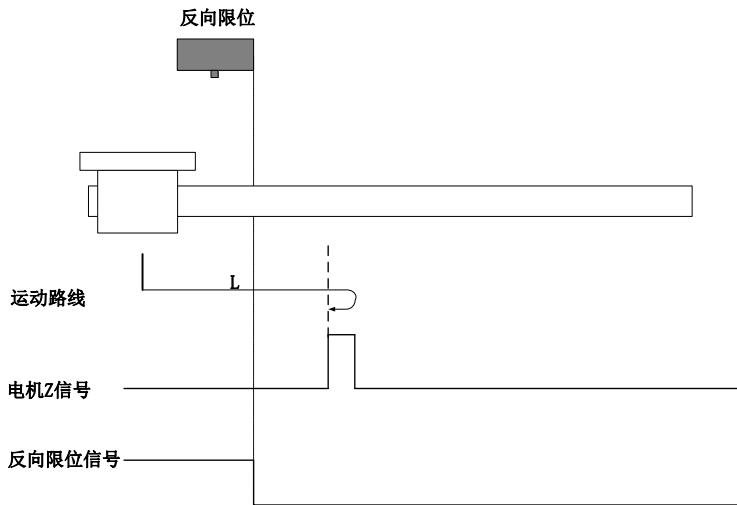
回零启动时 R-INH=1，直接正向低速开始回零，遇到 R-INH 下降沿后的 Z 信号折返到 Z 信号；
