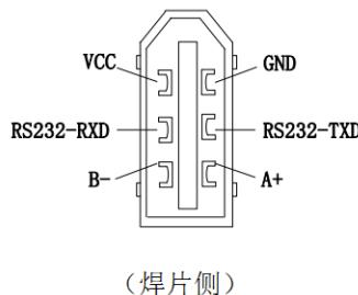
**图 4.3.13 通讯口 CN1 插头端子排列顺序图**
