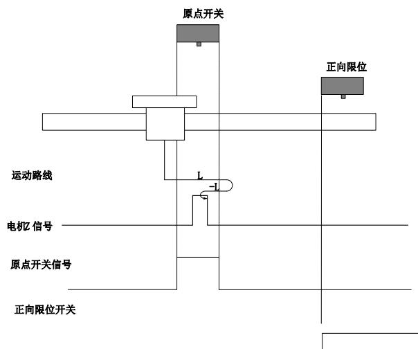
回零启动时 ORGP=1，则直接正向低速开始回零，遇到 ORGP 下降沿后，反向，反向低速运行
