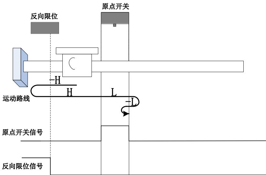
开始回零时  $ORGP=0$ ，以反向高速开始回零，遇到限位开关，自动反向，正向高速运行，遇到  $ORGP$  上升沿后，减速，正向低速运行，遇到  $ORGP$  下降沿后，反向，反向低速运行，遇到  $ORGP$  上升沿折返到上升沿；
