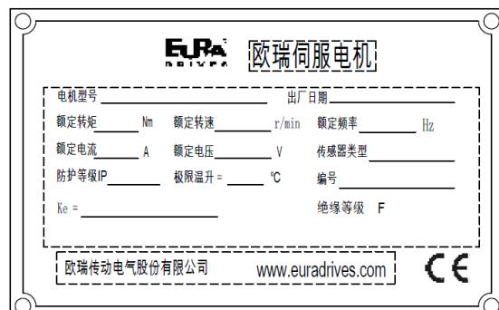
图 2.2.4 伺服电机铭牌示意图 (180 及 250 止口伺服电机)
