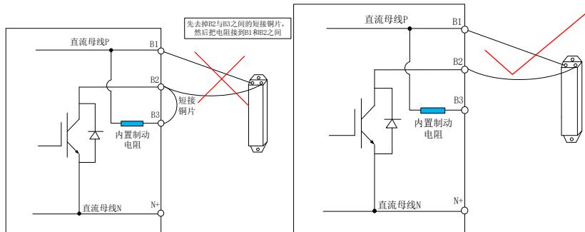
图 7.1.11 伺服制动电阻接线示意图
