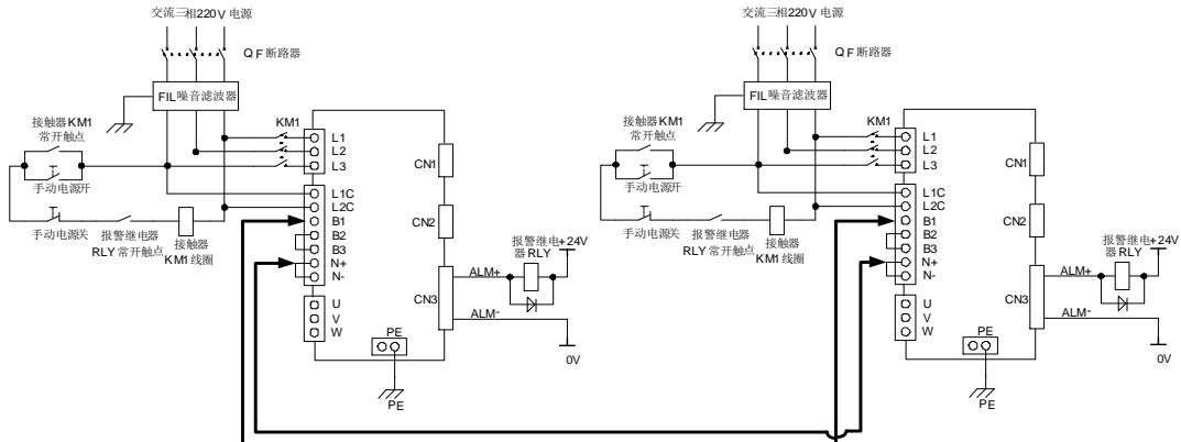
图 4.1.7 220V 驱动器共直流母线配线图
