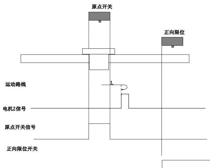
回零启动时 ORGP=1, 则直接正向低速开始回零, 遇到 ORGP 下降沿后的 Z 信号折返到 Z 信号;
