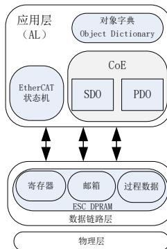
图 6.1.3 基于 CANOpen 应用层的 EtherCAT 通信结构
