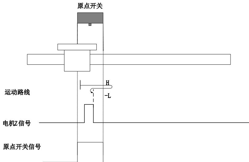
回零启动时 ORGP=1，以正向高速开始回零，遇到 ORGP 下降沿后，减速，反向，反向低速运行，遇到 ORGP 上升沿后的 Z 信号折返到 Z 信号；
