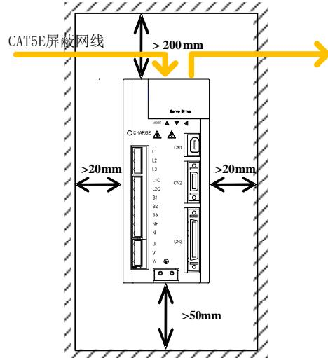
图 3.1.1 典型最小安装尺寸示意图
