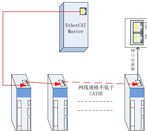
图 6.1.1 EtherCAT 网络连接示意图
