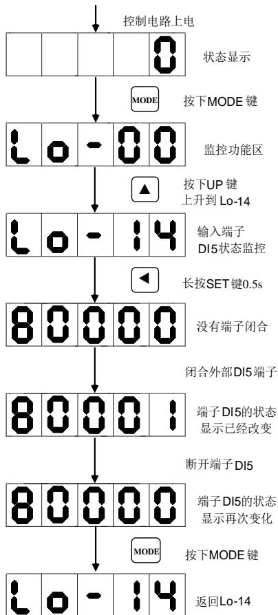
图 5.3.1 端子状态监控示意图
