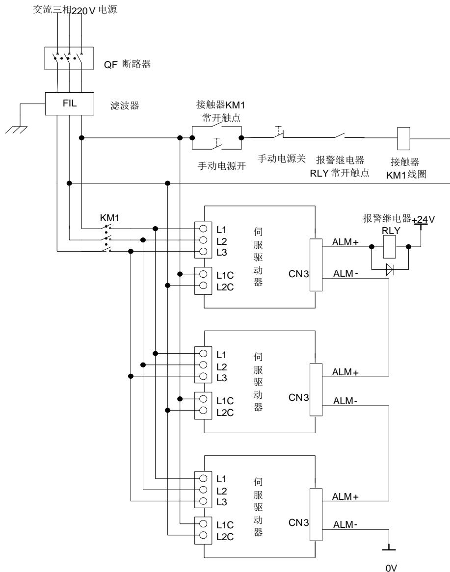
图 4.3.14 220V 多台联机时的接线
