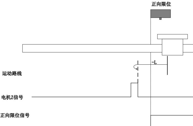
回零启动时 F-INH=1，直接反向低速开始回零，遇到 F-INH 下降沿后 Z 信号折返到 Z 信号；
