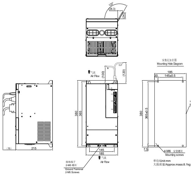
图 3.1.8 伺服驱动器结构尺寸 6
