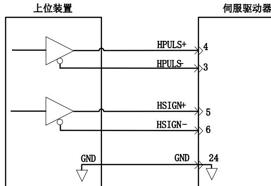
图 4.3.3 高速脉冲输入接口电路
