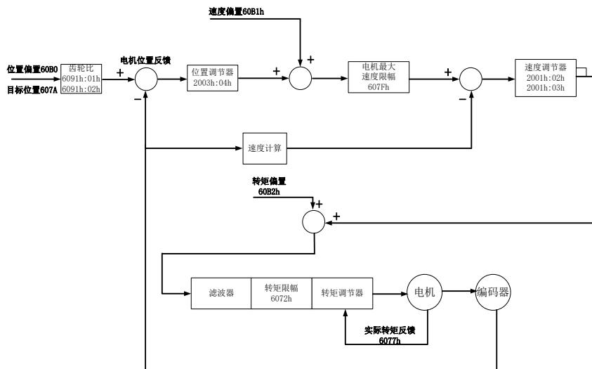
图 7.6.1 周期同步位置 (CSP) 控制框图
