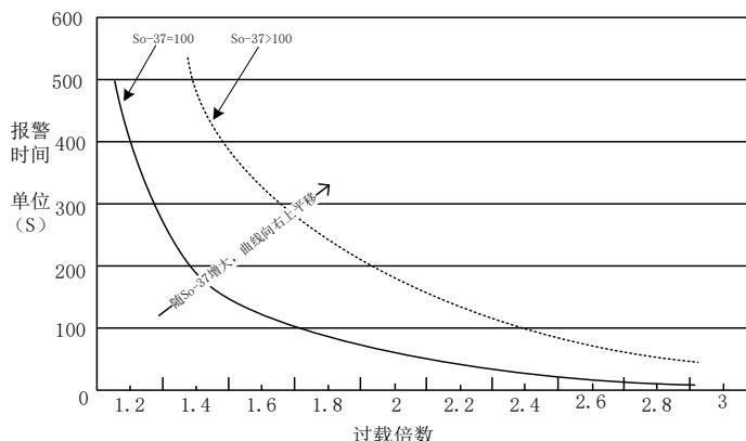
图 7.10.1 电机过载曲线与报警时间曲线图
