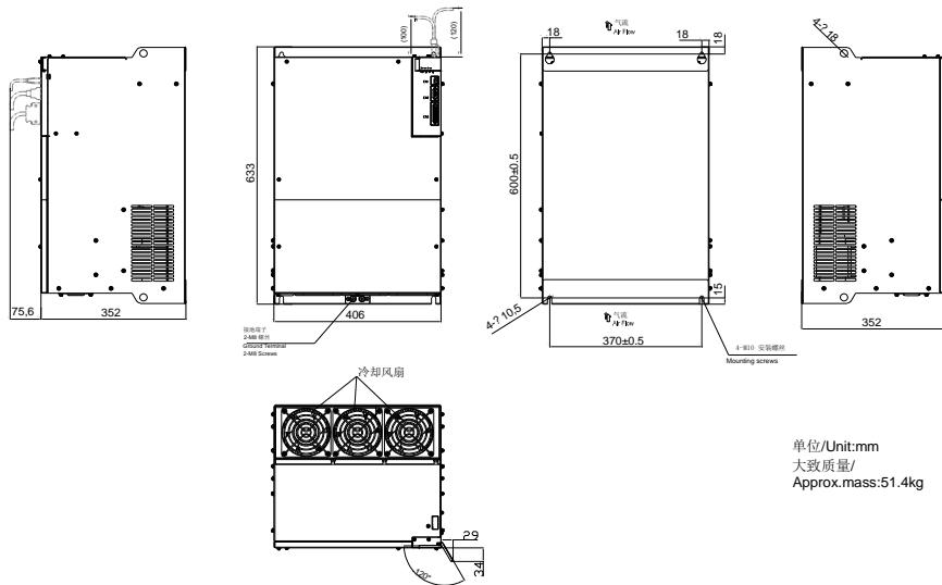
图 3.1.13 伺服驱动器结构尺寸 11
