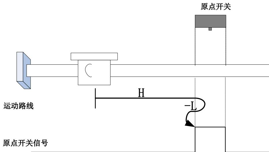
开始回零时 ORGP=0, 以正向高速开始回零, 遇到 ORGP 上升沿后, 减速, 反向, 反向低速运行, 遇到 ORGP 下降沿折返到下降沿;
