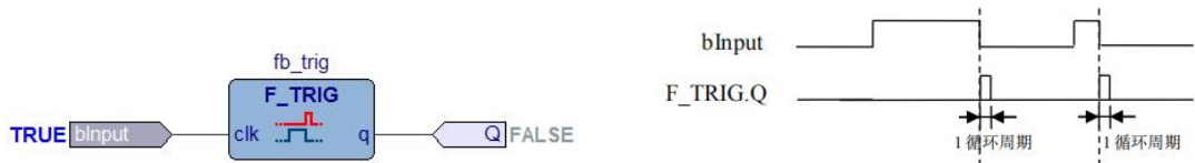
图 8.2 下降沿触发程序和时序
