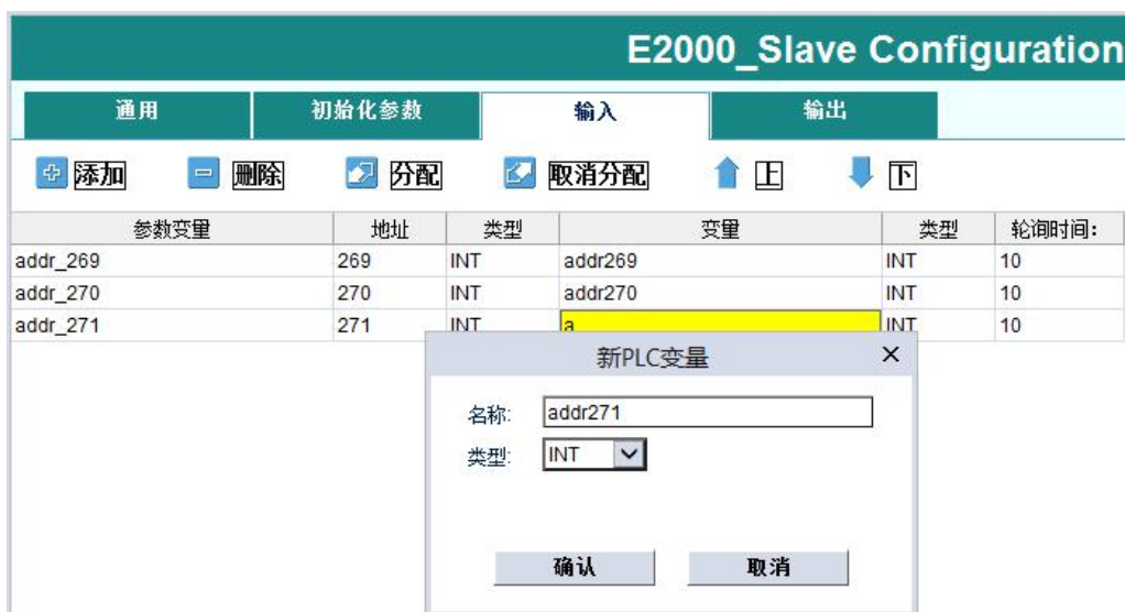
图 5.30 映射 PLC 变量
