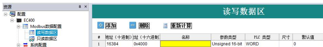
图 1.24 添加 modbus 通讯变量
