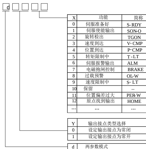
图 8.1.2 可编程输出端子功能设定示意图
