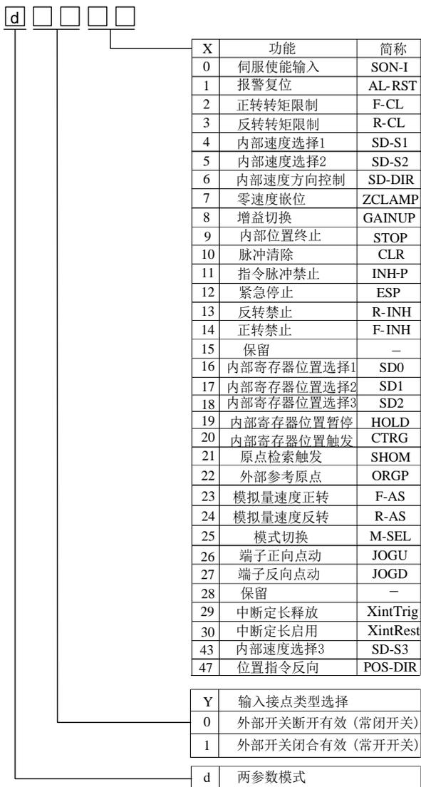
图 4-6-1 可编程输入端子功能设定示意图
