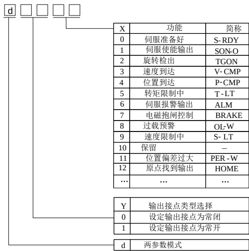
图 8.1.2 可编程输出端子功能设定示意图
