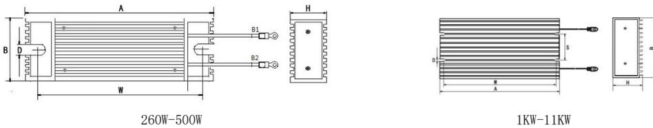
图 3-7 制动电阻尺寸图 (铝壳电阻)
