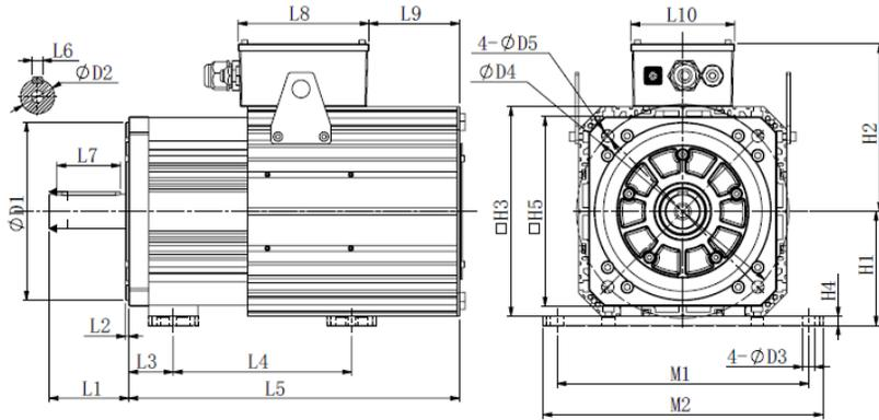
E机座伺服电机结构尺寸图 (mm)
