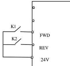
· 2：两线式运转模式 2：应用该模式时，FWD 为使能端子，方向由 REV 的状态来确定。（仅在 FA30=0 时候有效）
