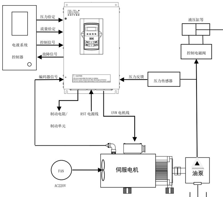
图 4-1 电液系统构成示意图
