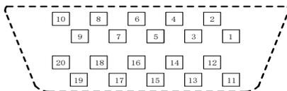
注：从焊片侧往驱动器侧看（8 芯编码器定义在普通增量编码器定义基础上去掉 U/V/W 即可）
