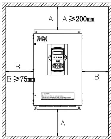
图 3-5 风冷驱动器安装示意
