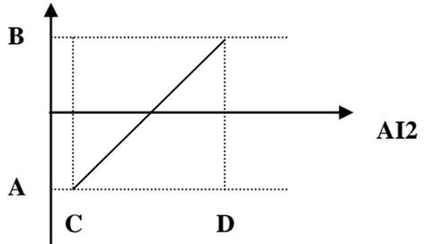
图 5-8 模拟给定与设定量的计算关系
