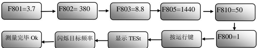
图 6-22 参数测量流程图
