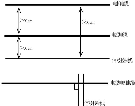
一般地, 控制线必须为屏蔽线, 并且屏蔽金属丝采用 360° 接地法接地。
