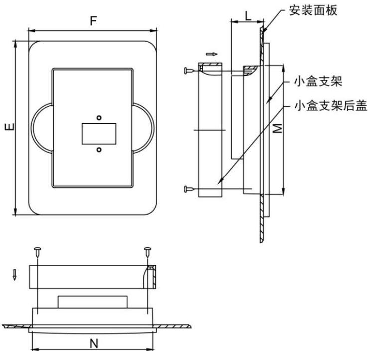
图 2-3 控制面板安装支架结构尺寸示意图
