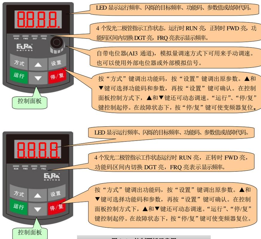
图 2-1 控制面板示意图
