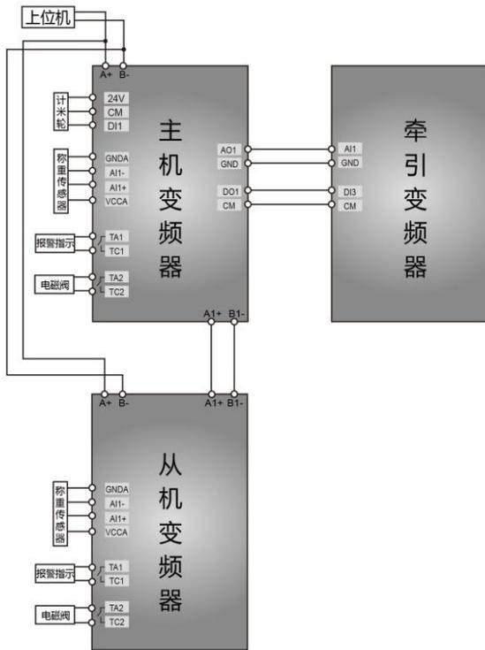
图 4-7 双层米克重控制系统连线图
