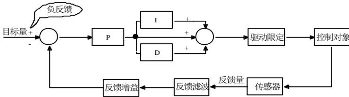
图 6-24 PID 控制算法示意图
