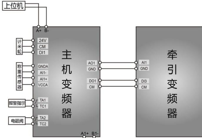
图 4-6 单层米克重控制系统连线图
