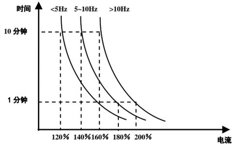
图 5-13 不同频率下的电机过载保护值
