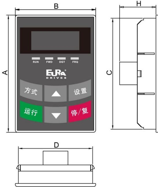
图 2-2 控制面板结构示意图
