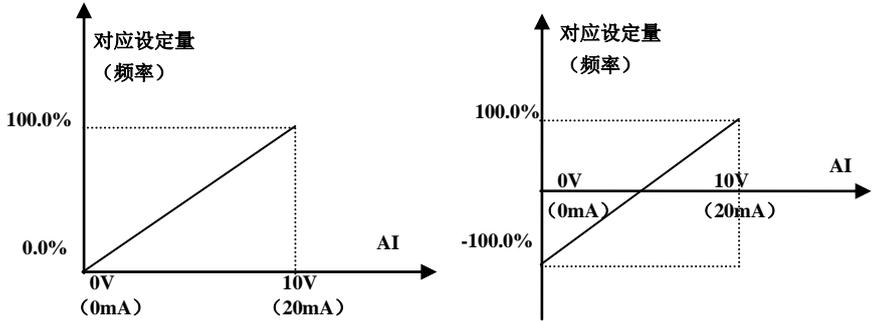
图 5-7 模拟给定与设定量的对应关系
