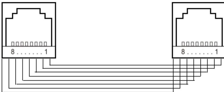
控制板与控制面板的接口是完全一致的，所以要求做远控线时两头的线序必须完全一致，如上图所示。
