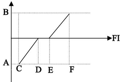
图 5-11 脉冲输入与设定量的计算关系
