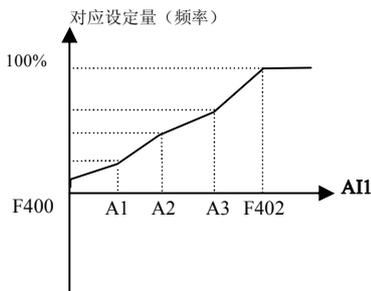
图 5-9 折线式模拟量输入与设定量关系
