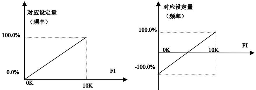
图 5-10 脉冲输入与设定量的对应关系
