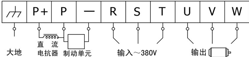
(上图为示意图，实际产品的功率端子可能与上图未完全一致，接线时务必注意！)
