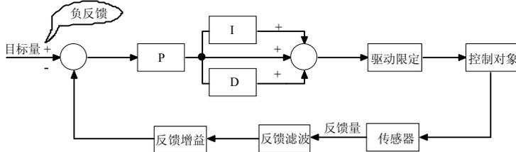
图 5-16 PID 控制算法示意图
