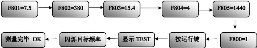
说明：选择自动矩补偿方式（F137=3），是为了自动提升低频力矩，需要测量被控电机定子电阻参数值，因此不能为了达到电机的同步运行，将一台变频器带动多台电机，若现场所需，必须使用一台变频器带动多台电机，请将 F137 设置为不等于 3 的其他参数。
