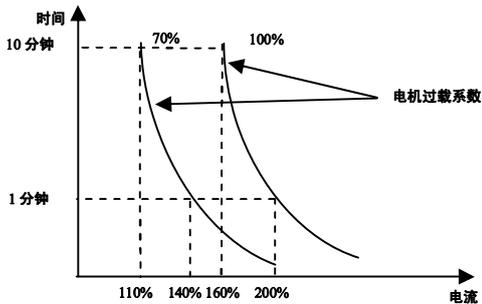
图 5-14 电机过载系数设定
