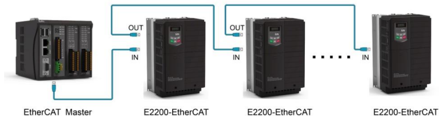
图 8-1 EtherCAT 组网连线图
