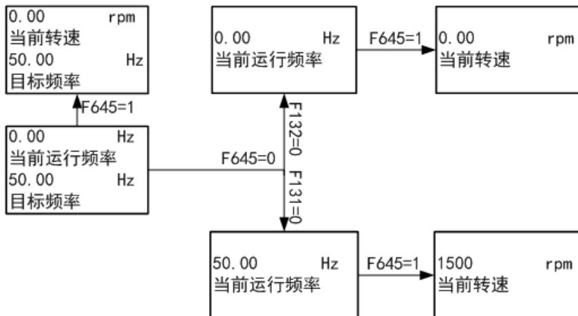
图 2-5 状态参数显示界面流程图
