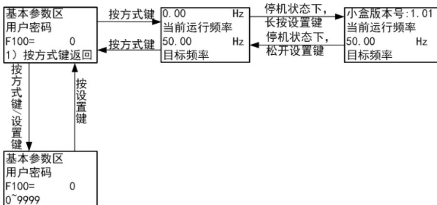
图 2-3 界面切换操作流程图
