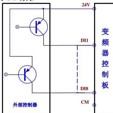
共源极连接方式是目前最为常用的一种方式，控制端子出厂值默认为共源极连接方式。因此用户根据需求进行相应的选择。
