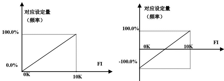
图 5-11 脉冲输入与设定量的对应关系
