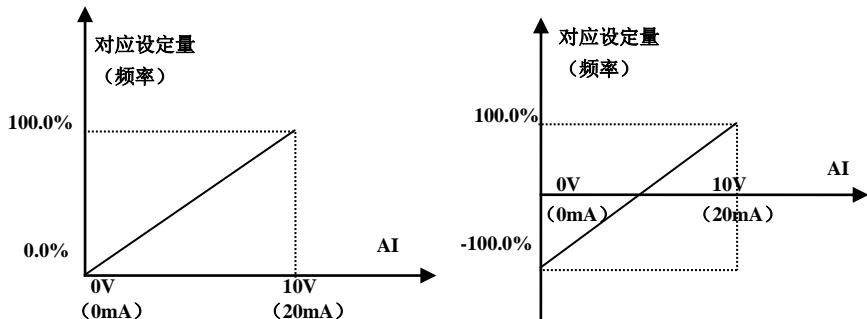
图 5-9 模拟给定与设定量的对应关系
