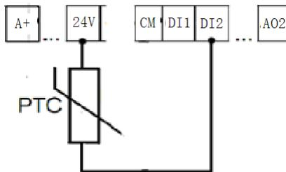
若客户使用 PTC 作为热保护，可按照以下操作。功能端子设置为 38 时，当拨码开关在 NPN 侧，PTC 电阻应接 CM 与 DI<sub>x</sub> 端；当拨码开关在 PNP 侧，PTC 电阻应该接 DI<sub>x</sub> 与 24V。PTC 电阻的阻值要求保护时对应的阻值 16.5K。
