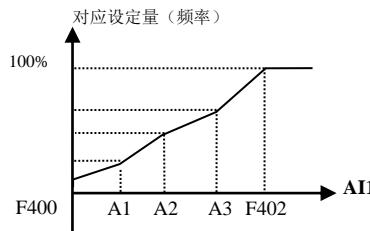
图 5-13 折线式模拟量输入与设定量关系
