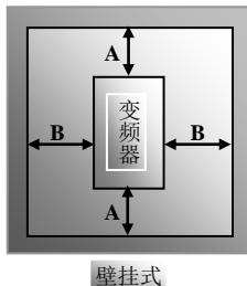
下表给出了变频器安装的间隙尺寸（推荐值）。
