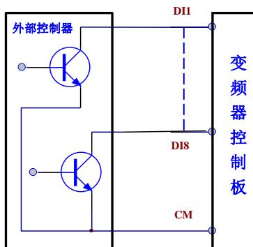
若实现共漏极连接方式，需要将控制板上拨动开关达到“PNP”端，具体接线方式如 3、4：
