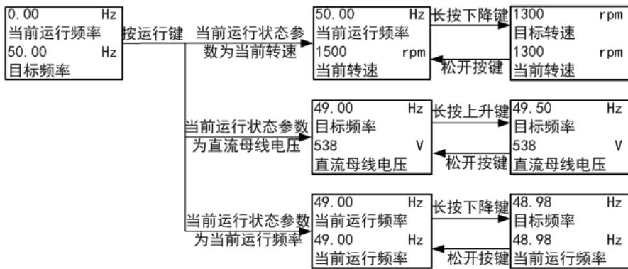
图 2-6 目标频率/目标转速调节流程图
