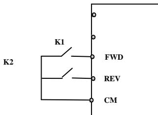
2: 两线式运转模式 2: 应用该模式时, FWD 为使能端子, 方向由 REV 的状态来确定。
