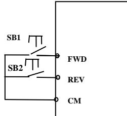
注: SB1 脉冲触发正转运行, 再次脉冲触发停止运行;
