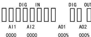
其中，第一行表示输入、输出，第二行前 8 个方框代表 DI 端子的状态，从左至右依次对应 DI1~DI8 端子，当端子无效时，状态如上所示为实方框；当端子有效时，则相应方框变为黑方框，例如，
