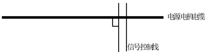
一般地，控制线必须为屏蔽线，并且屏蔽金属丝采用 360° 接地法接地。
