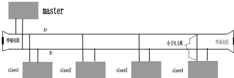
RS485 网络中的任何一点都不能直接接地。网络中的所有设备都要通过自己的接地端良好接地。需要注意的是, 在任何情况下接地线都不能形成封闭回路。通讯系统连接图
