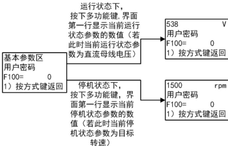
图 2-4 编程界面操作流程图
