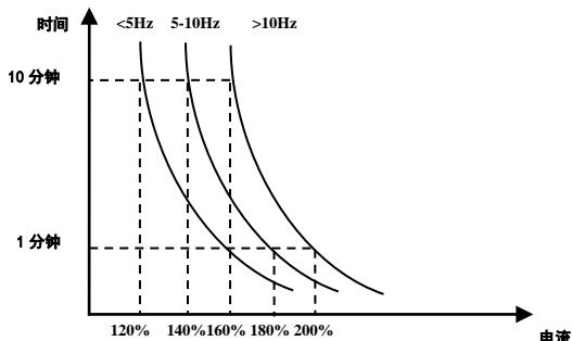
图 5-17 不同频率下的电机过载保护值
