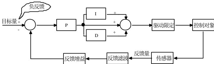
图 5-20 PID 控制算法示意图
