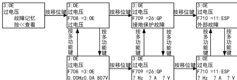
图 2-7 故障界面操作流程图
