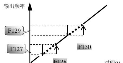
图 5-2 频率回避示意图
