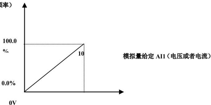
图 6-8 模拟给定与设定量的对应关系
