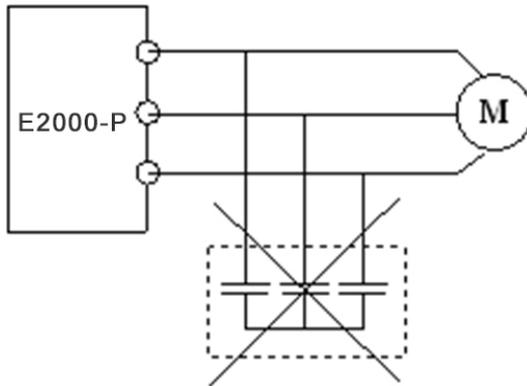
图 1-4 变频器输出端禁止使用电容器
