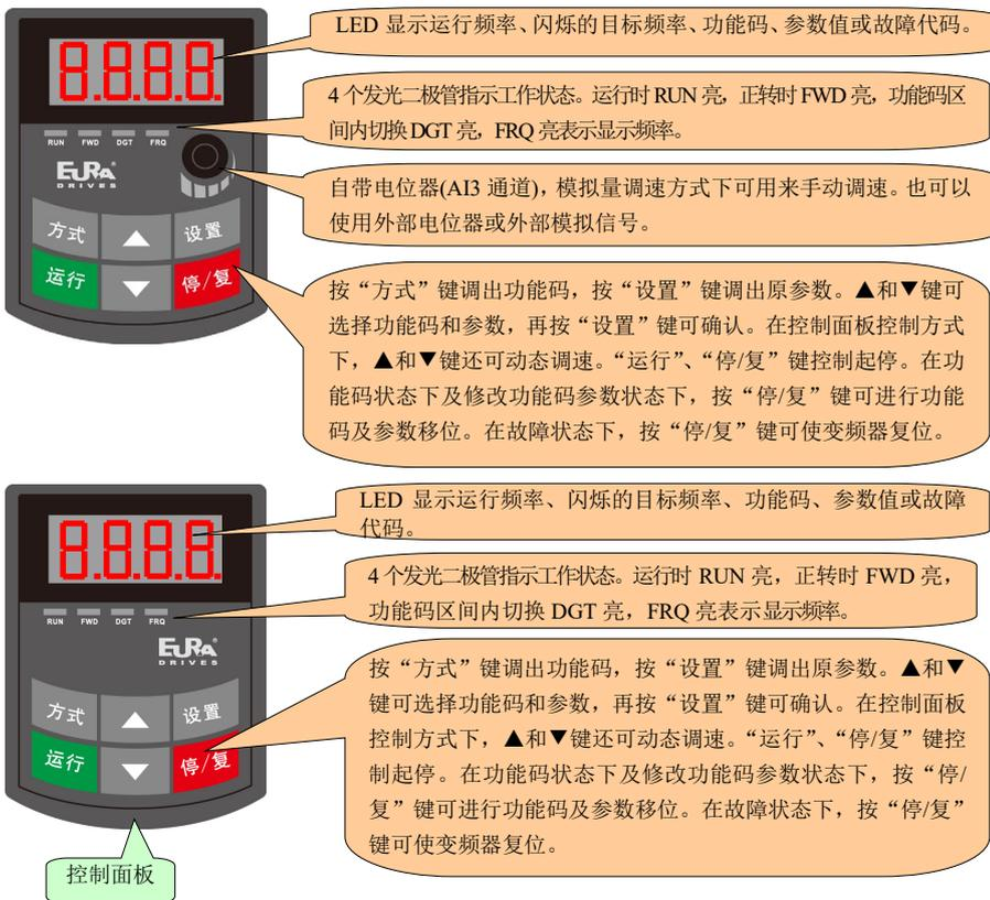
图 3-1 控制面板示意图
