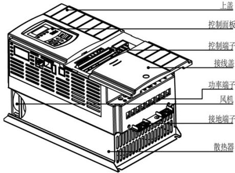
图 2-4 产品外形及结构部件图
