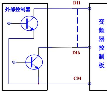
图 4-9 有源共源极接线方式示意图
