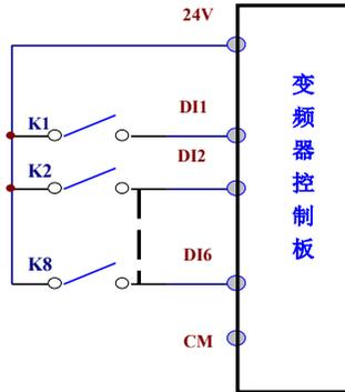
图 4-10 无源共漏极接线方式示意图
