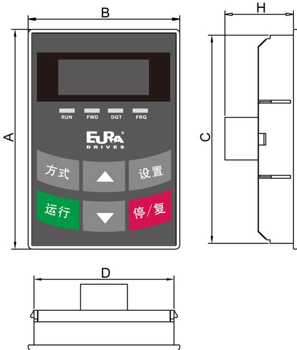
图 3-3 控制面板结构示意图
