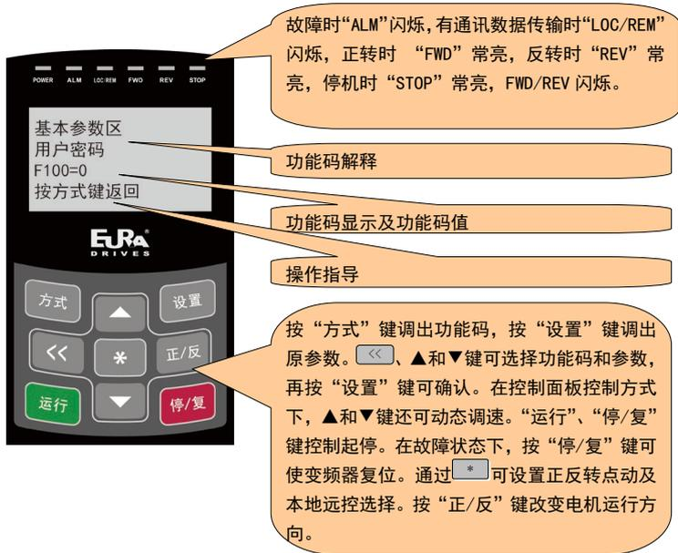
图 3-2 控制面板示意图
