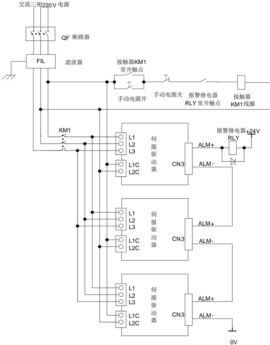
图 4.3.23 220V 多台联机时的接线
