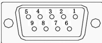
图 4.2.1 绝对值型编码器端子排列示意图
