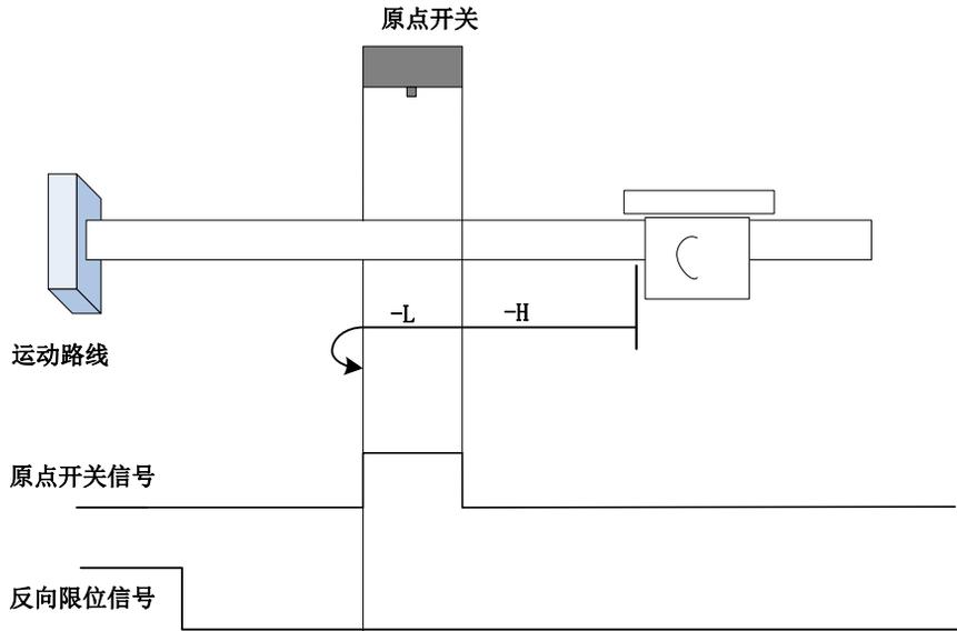
开始回零时 ORGP=0，以反向高速开始回零，未遇到限位开关，遇到 ORGP 上升沿后，减速，反向低速运行，遇到 ORGP 下降沿折返到下降沿；
