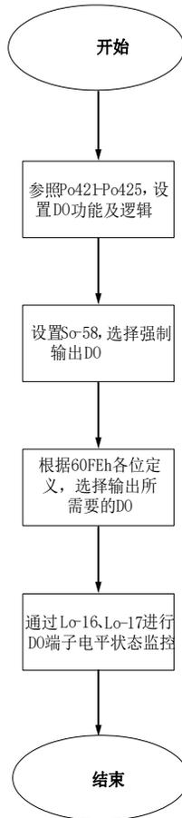
图 7.3.3 DO 信号强制输入设定步骤示意图
