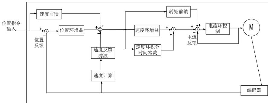
图 9.3.1 伺服驱动器内部框架图
