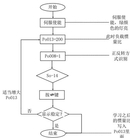
图 9.2.1 离线式转动惯量设置流程图
