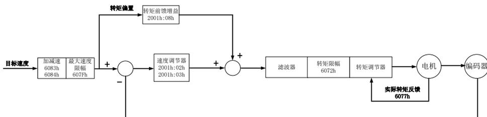
图 7.4.1 轮廓速度模式（PV）控制框图
