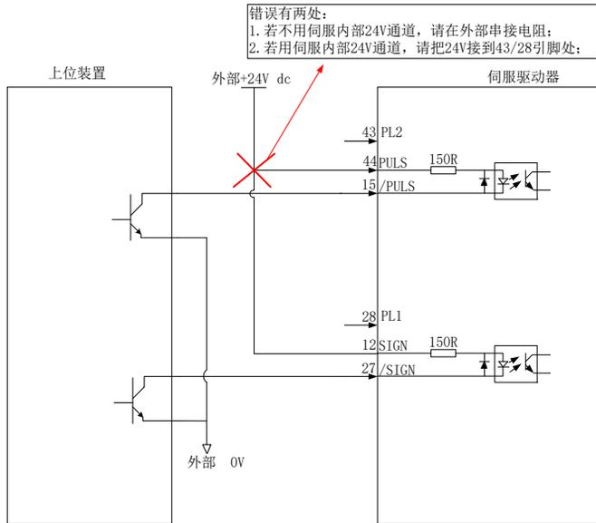
图 4.3.7 24V 集电极开路接线错误示意图 1
