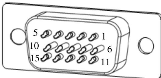
图 4.2.3 增量型编码器端子排列示意图
