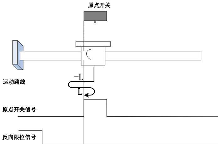
回零启动时 ORGP=1，则直接反向低速开始回零，遇到 ORGP 下降沿后，反向，正向低速运行中，遇到 ORGP 上升沿折返到上升沿；
