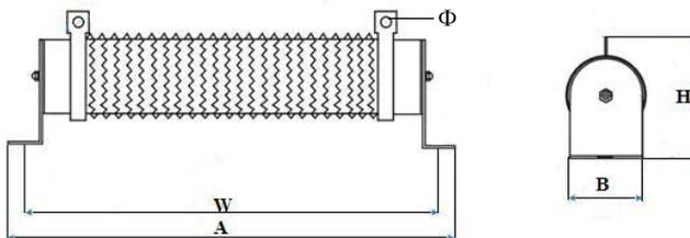
图 7.1.13 伺服制动电阻接线示意图
