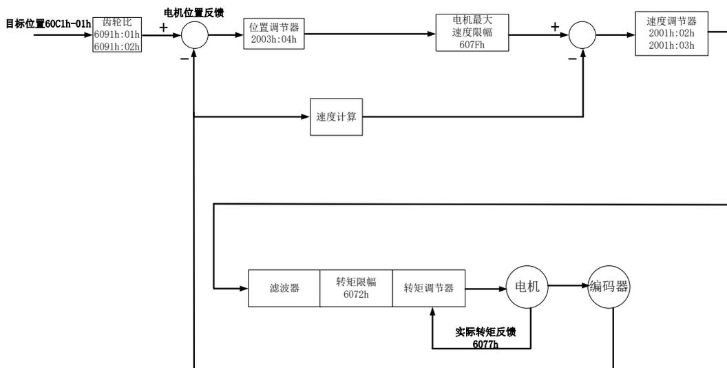
图 7.6.1 位置插补模式 (IP) 控制框图
