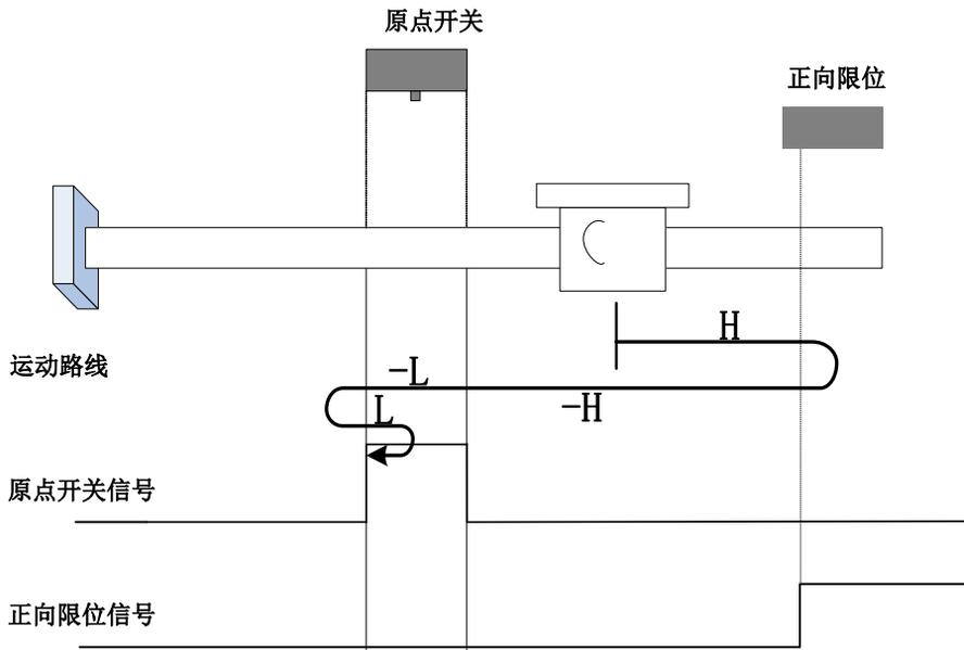
开始回零时 ORGP=0，以正向高速开始回零，遇到限位开关，自动反向，反向高速运行，遇到 ORGP 上升沿后，减速，反向低速运行，遇到 ORGP 下降沿后，反向，正向低速，遇到 ORGP 上升沿
