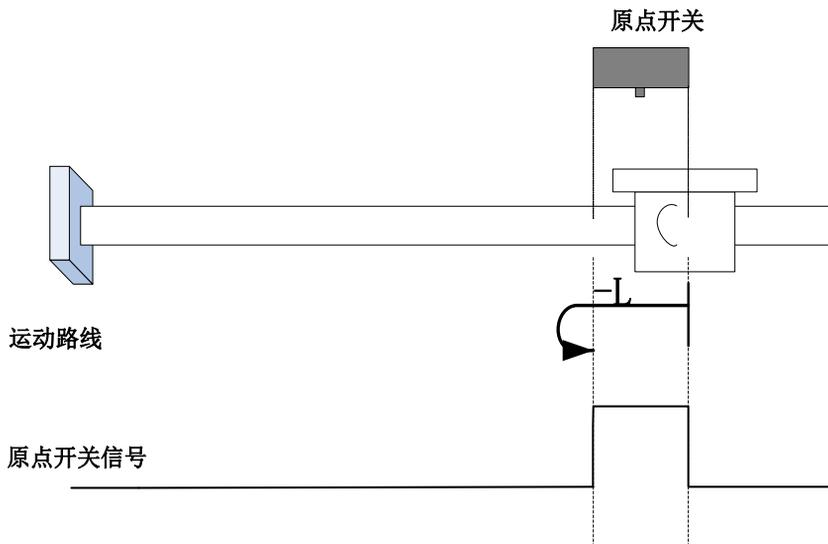
回零启动时  $ORGP=1$ ，直接反向低速开始回零，遇到  $ORGP$  下降沿折返到下降沿；
