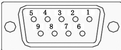
图 4.2.2 旋转变压器编码器端子排列示意图
