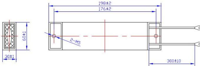
图 7.1.12 伺服制动电阻接线示意图
