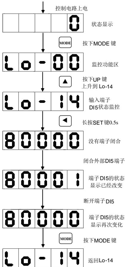
图 5.3.1 端子状态监控示意图
