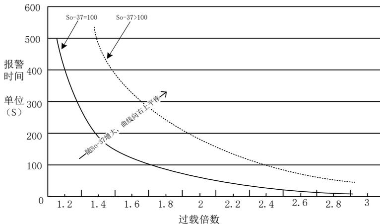
图 7.3.1 电机过载曲线与报警时间曲线图
