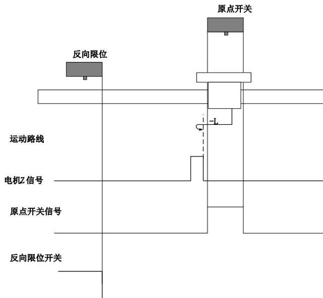
回零启动时 ORGP=1，则直接反向低速开始回零，遇到 ORGP 下降沿后的第一个 Z 停机；
