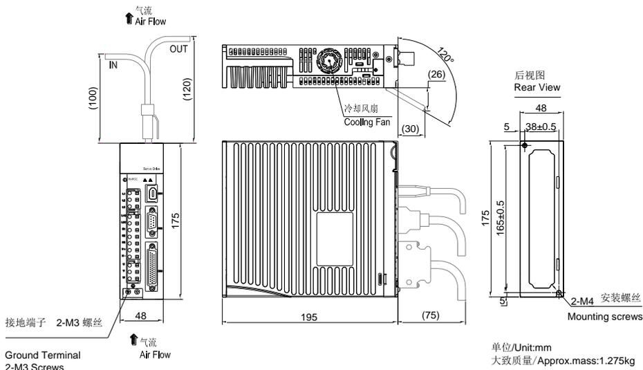
图 3.1.4 伺服驱动器结构尺寸 2
