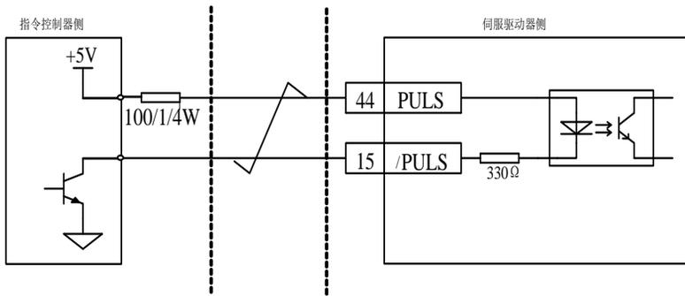
图 4.3.5 5V 集电极开路脉冲输入接口电路
