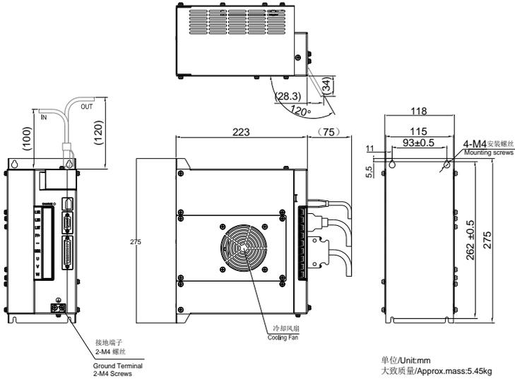
图 3.1.7 伺服驱动器结构尺寸 5
