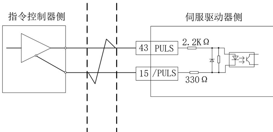
图 4.3.4 24V 差分脉冲输入接口电路
