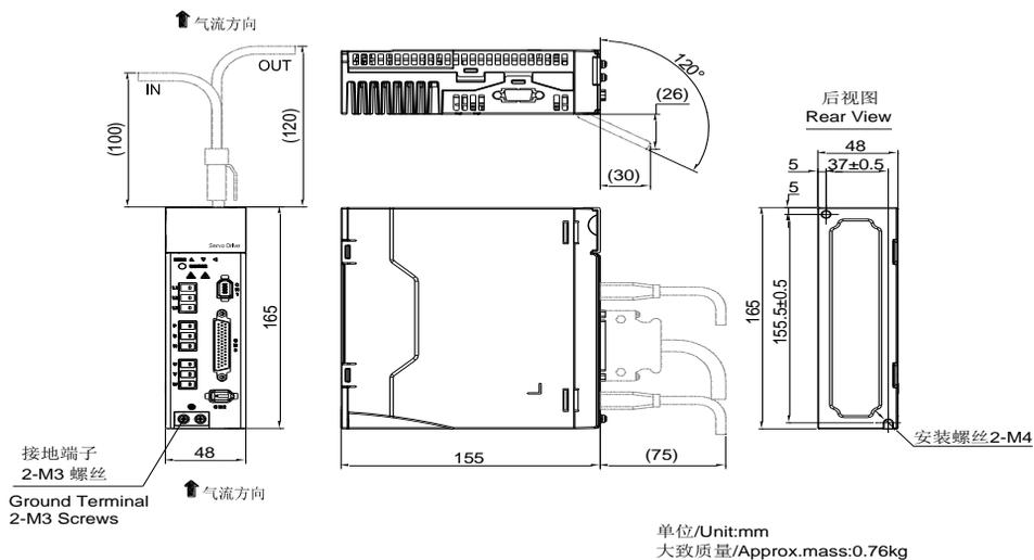
图 3.1.3 伺服驱动器结构尺寸 1
