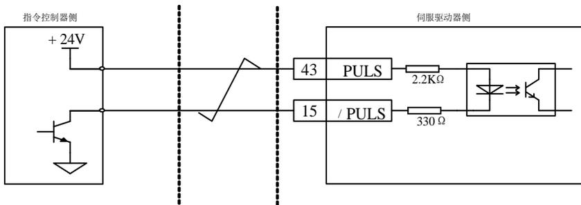
图 4.3.6 24V 集电极开路脉冲输入接口电路
