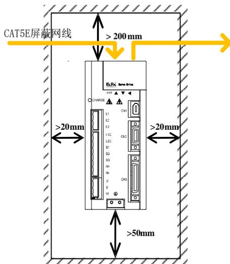
图 3.1.1 典型最小安装尺寸示意图
