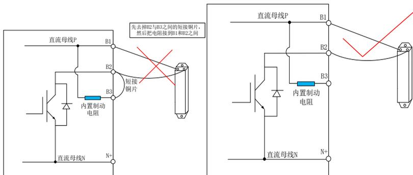
图 7.1.11 伺服制动电阻接线示意图
