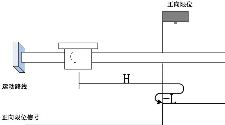
开始回零时  $F-INH=0$ ，以正向高速开始回零，遇到  $F-INH$  上升沿后，减速，反向，反向低速运行，遇到  $F-INH$  下降沿后折返到下降沿；
