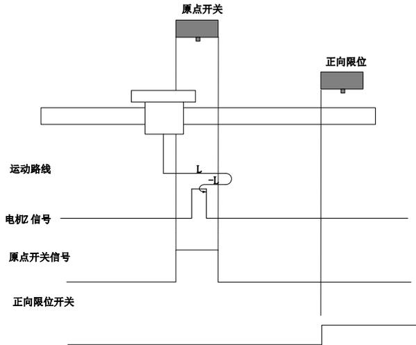
回零启动时  $ORGP=1$ ，则直接正向低速开始回零，遇到  $ORGP$  下降沿后，反向，反向低速运行中，遇到  $ORGP$  上升沿后的  $Z$  信号折返到  $Z$  信号；
