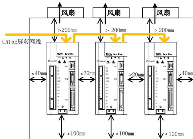
图 3.1.2 多台并列安装最小安装尺寸示意图
