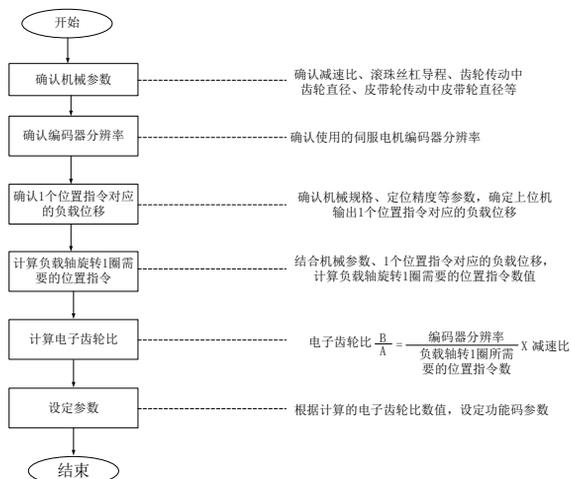
图 7.2.1 电子齿轮比设置步骤流程图
