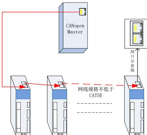
图 6. 1. 1CANopenfs 网络连接示意图
