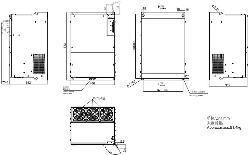
图 3.1.13 伺服驱动器结构尺寸 11
