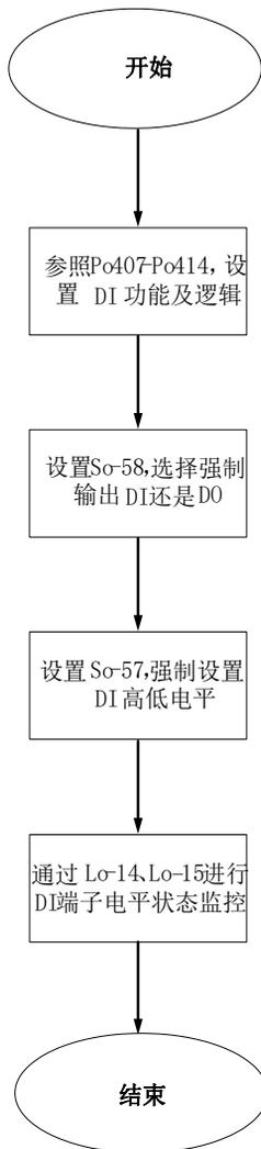
图 7.3.2 DI 信号强制输入设定步骤示意图
