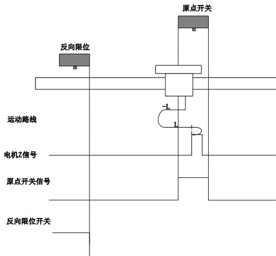
回零启动时 ORGP=1，则直接反向低速开始回零，遇到 ORGP 下降沿后，反向，正向低速运行中，遇到 ORGP 上升沿后 Z 信号折返到 Z 信号；
