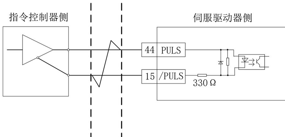
图 4.3.3 5V 差分脉冲输入接口电路
