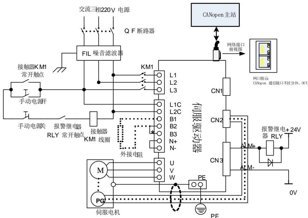
图 4.1.4 220V 驱动器典型主电路配线图
