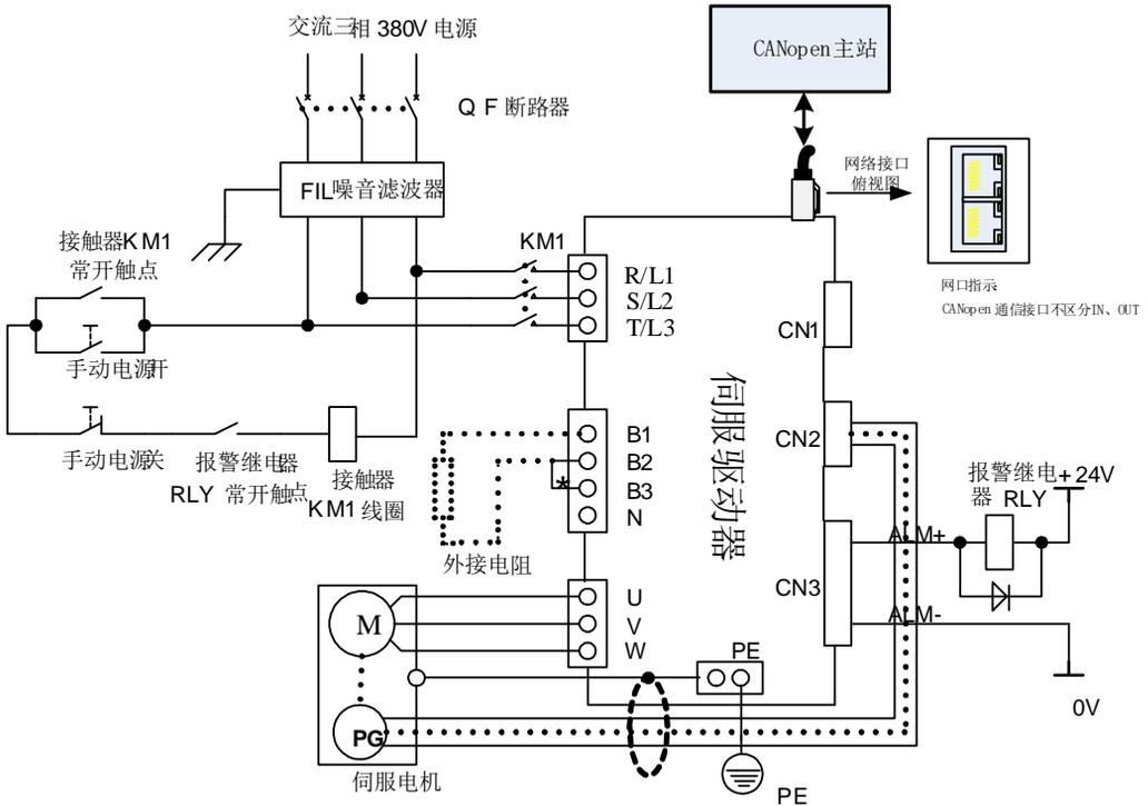
图 4.1.5 380V 驱动器典型主电路配线图
