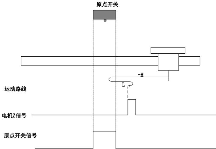
开始回零时 ORGP=0, 以反向高速开始回零, 若未遇到限位开关, 遇到 ORGP 上升沿后, 减速, 反向, 正向低速运行, 遇到 ORGP 下降沿后的 Z 信号折返到 Z 信号;
