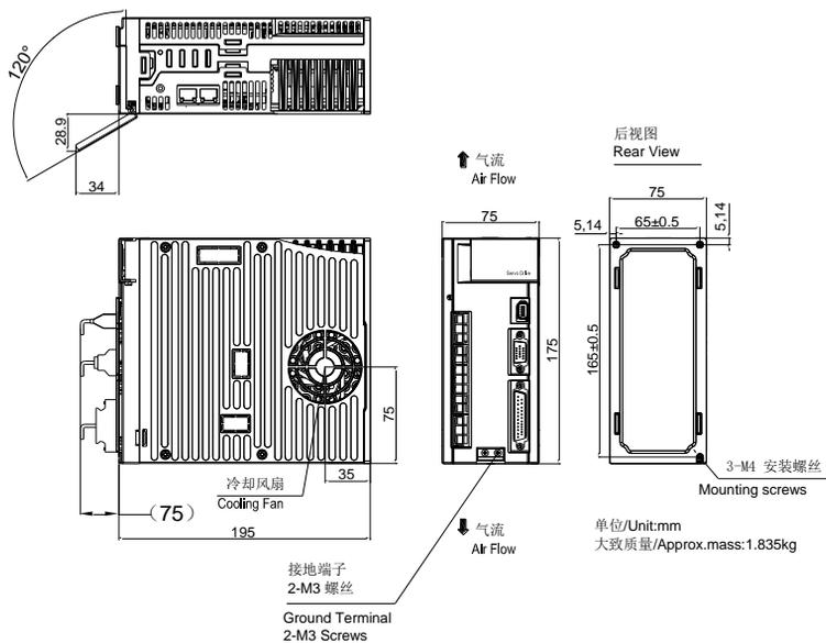
图 3.1.5 伺服驱动器结构尺寸 3
