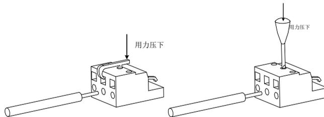
图 4.1.3 主电路端子使用方法
