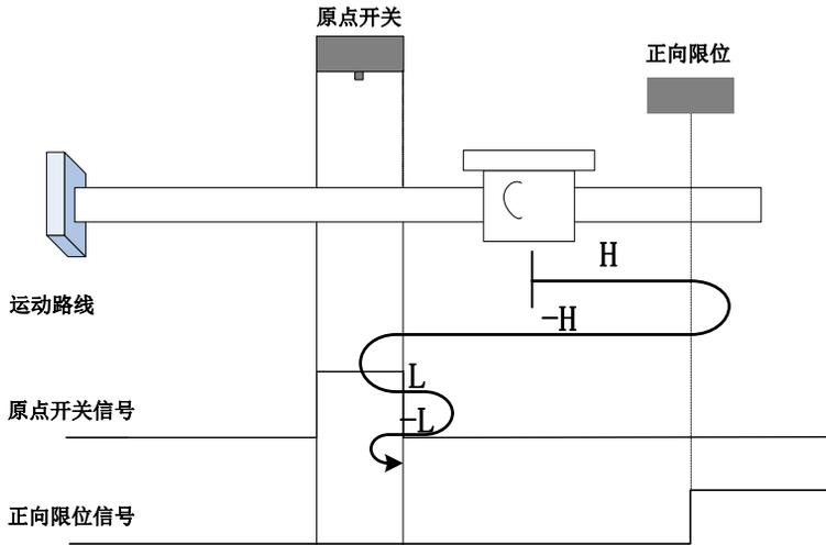
开始回零时 ORGP=0，以正向高速开始回零，遇到限位开关，自动反向，反向高速运行，遇到 ORGP 上升沿后，减速反向即恢复正向运行，正向低速遇到 ORGP 下降沿后，反向，反向低速运行中遇到 ORGP 上升沿折返到上升沿；
