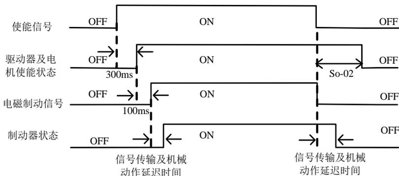
图 7.1.3 电磁抱闸制动时序图
