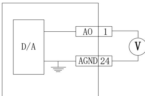
图 4.3.12 模拟量监控输出接口
