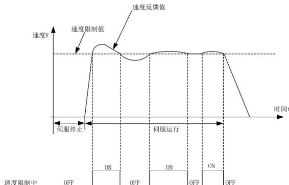
图 7.3.3 转矩模式下速度限制中输出示意图
