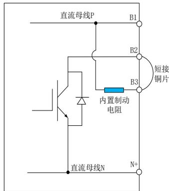
图 7.1.10 伺服内部能耗制动示意图
