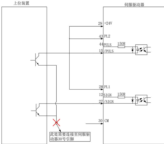
图 4.3.9 24V 集电极开路接线错误示意图 3
