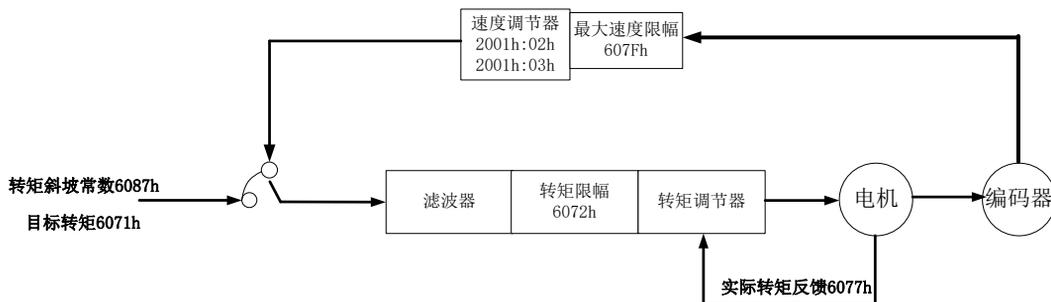
图 7.5.1 轮廓转矩模式 (PT) 控制框图
