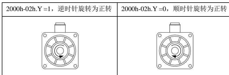
图 7.1.1 电机旋转方向示意图
