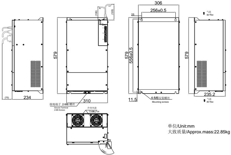
图 3.1.11 伺服驱动器结构尺寸 9
