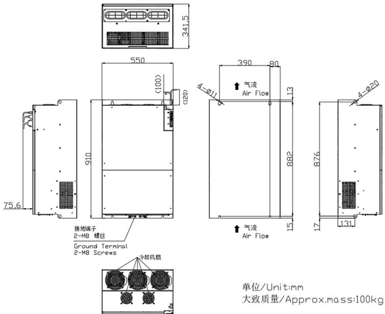
图 3.1.13 伺服驱动器结构尺寸 12
