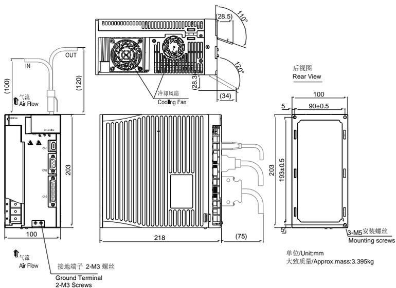
图 3.1.6 伺服驱动器结构尺寸 4
