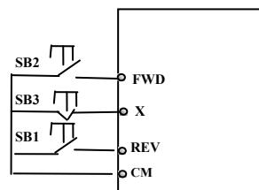
4: 三线式运转模式 2: 该模式下使能端子为 X, 运行命令由 FWD 来给出, 方向由 REV 状态来决定, 停机命令通过断开 X 来完成。
