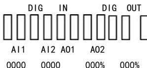
其中，第一行表示输入、输出，第二行前 8 个方框代表 DI 端子的状态，从左至右依次对应 DI1~DI8 端子，当端子无效时，状态如上所示为实方框；当端子有效时，则相应方框变为黑方框，
