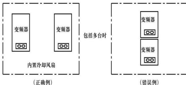
图 1-3 变频器安装在控制柜内示意图
