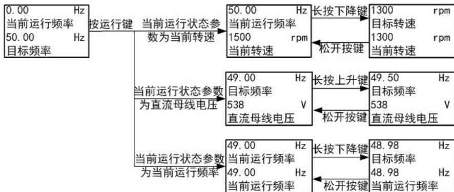
图 3-7 目标频率/目标转速调节流程图
