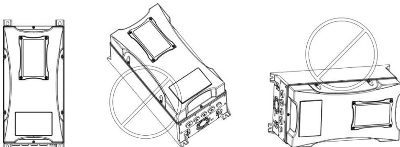
图 1-2 变频器垂直安装示意图
