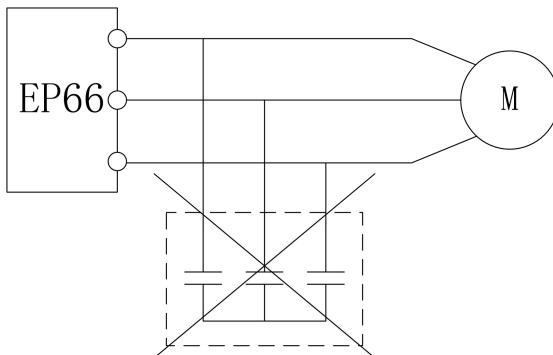
图 1-4 变频器输出端禁止使用电容器
