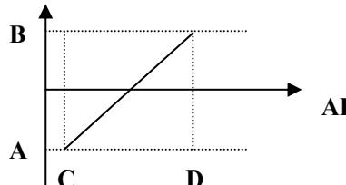
图 6-15 模拟给定与设定量的计算关系
