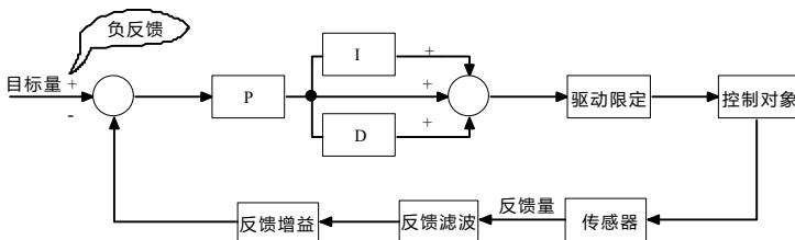
图 6-25 PID 控制算法示意图
