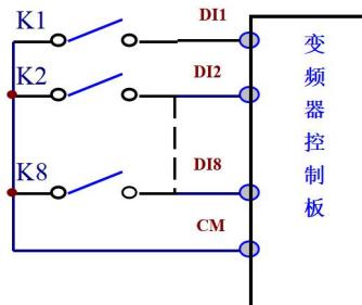
图 4-4 无源共源极接线方式示意图
