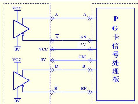
差分输出编码器（此处 VCC=5V, 使用差分编码器需要在整机体现，或单独按照订货号选型）。
