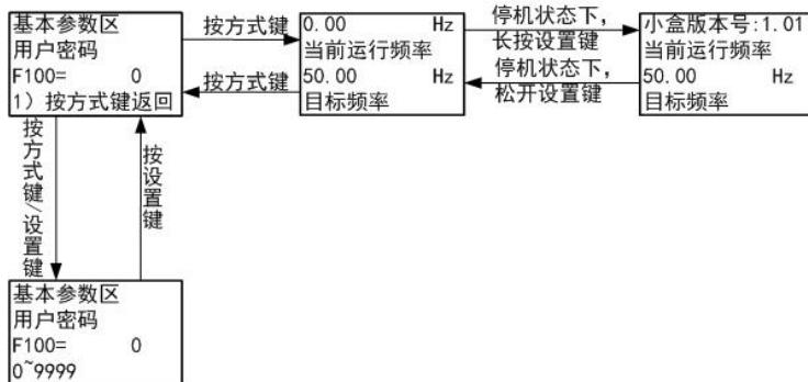
图 3-4 界面切换操作流程图
