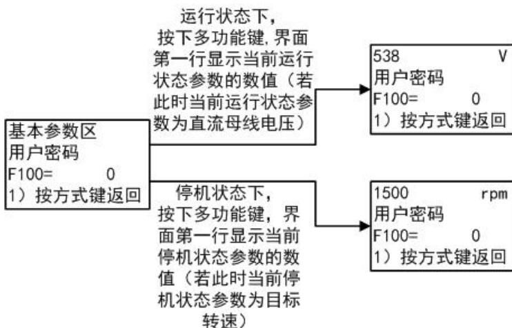
图 3-5 编程界面操作流程图
