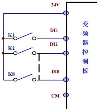
图 4-6 无源共漏极接线方式示意图
