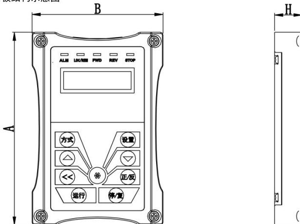
图 3-2 控制面板结构示意图
