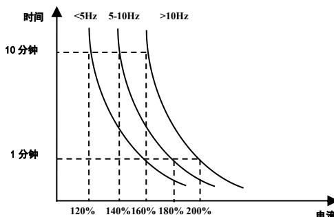
图 6-22 不同频率下的电机过载保护值
