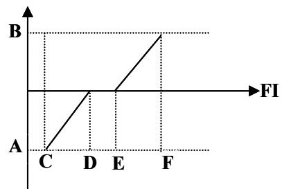
图 6-17 脉冲输入与设定量的计算关系
