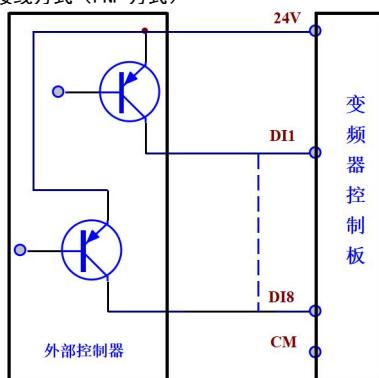
图 4-7 有源共漏极接线方式示意图
