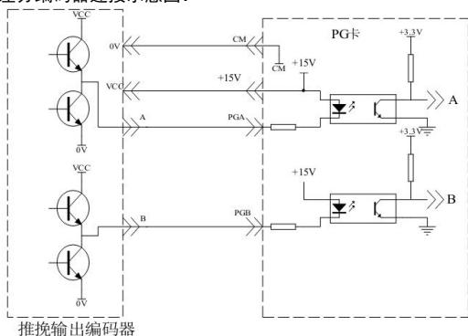
注：外接集电极输出编码器时，PG 卡上的 SW4 需要拨在 ON 上，为出厂状态，外接推挽输出编码器时，PG 卡上的 SW4 需要拨在 OFF 状态。
