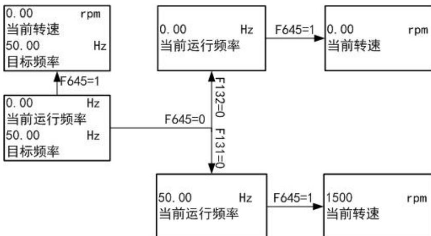
图 3-6 状态参数显示界面流程图
