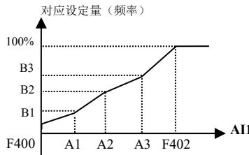
图 6-18 折线式模拟量输入与设定量关系
