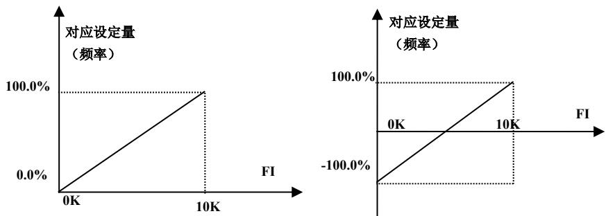
图 6-16 脉冲输入与设定量的对应关系
