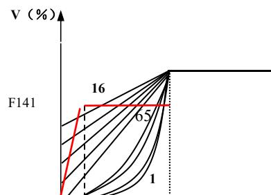
· 转矩补偿在转速追踪过程中无效，在电压恢复过程中按照设定加减速值运行到目标频率期间有效。
