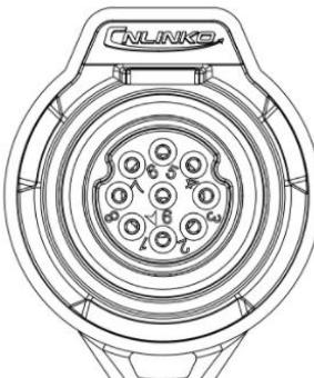
图 4-8 旋转变压器编码器航插排列示意图
