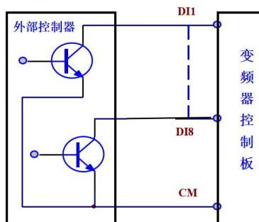
图 4-5 有源共源极接线方式示意图
