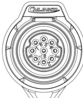
图 4-9 绝对值编码器航插排列示意图
