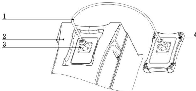
图 2-4 远控线外形及结构部件图
