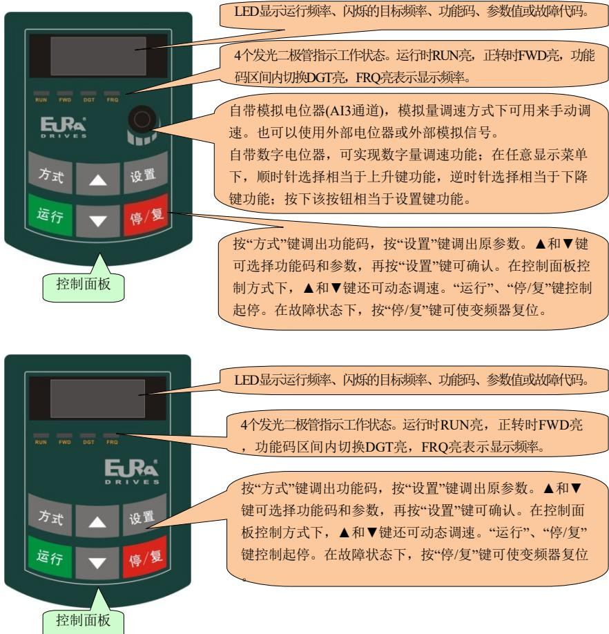
图2-1 控制面板示意图
