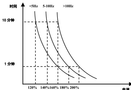
图 5-17 不同频率下的电机过载保护值
