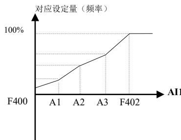
图 5-13 折线式模拟量输入与设定量关系
