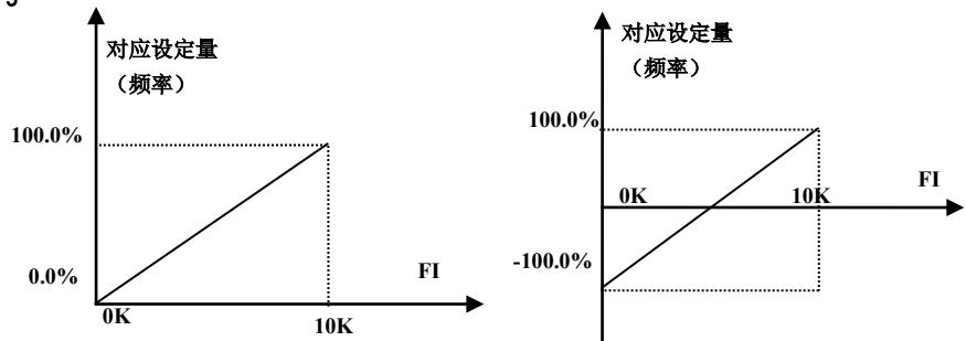
图5-11 脉冲输入与设定量的对应关系
