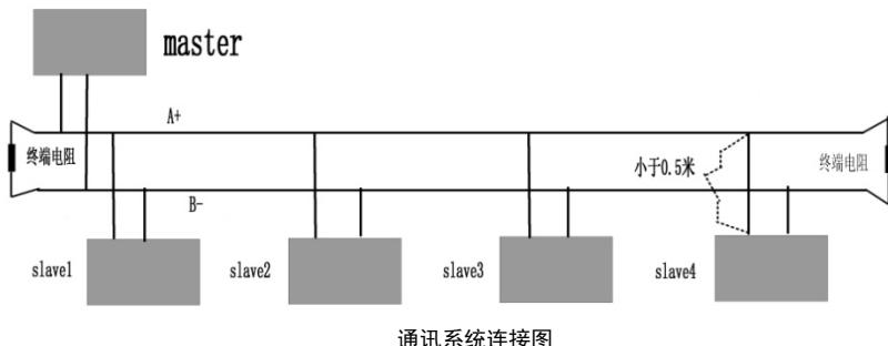
接线时要考虑计算机/PLC 的驱动能力及计算机/PLC 与变频器之间的距离。如果驱动能力不足需要自行加装中继器。
