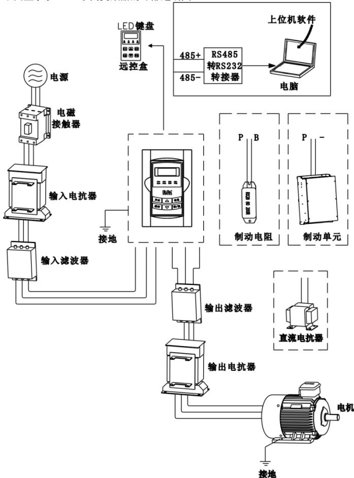
注意：(1) 30kW 及以下机型标配内置了制动单元，如果负载惯性不太大，可以只配制动电阻即可。
