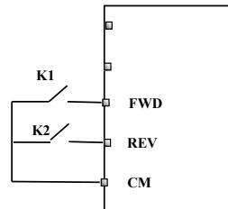
2：两线式运转模式 2：应用该模式时，FWD 为使能端子，方向由 REV 的状态来确定。
