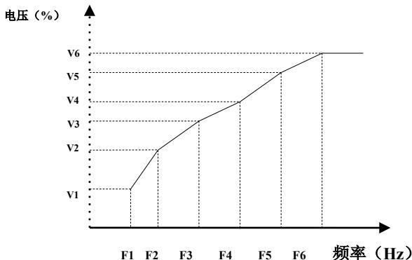
图 5-4 VVVF 曲线设定示意图
