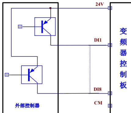
共源极连接方式是目前最为常用的一种方式，控制端子出厂值默认为共源极连接方式。因此用户根据需求进行相应的选择。
