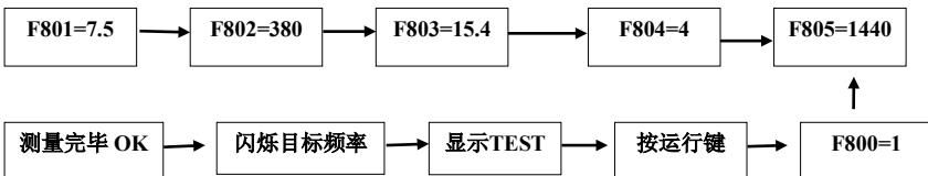
说明：选择自动矩补偿方式（F137=3），是为了自动提升低频力矩，需要测量被控电机定子电阻参数，因此不能为了达到电机的同步运行，将一台变频器带动多台电机，若现场所需，必须使用一台变频器带动多台电机，请将 F137 设置为不等于 3 的其他参数。
