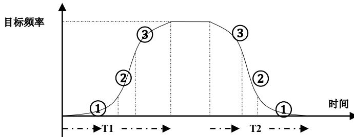
图 5-6 S 曲线加减速示意图
