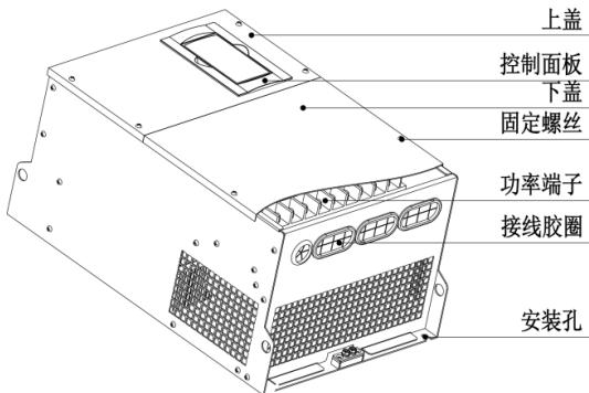
图 1-5 金属壳产品外形及结构部件图
