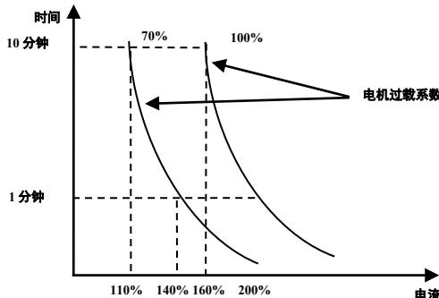
图 5-16 电机过载系数设定
