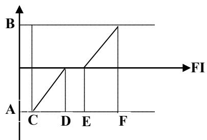
图5-12 脉冲输入与设定量的计算关系
