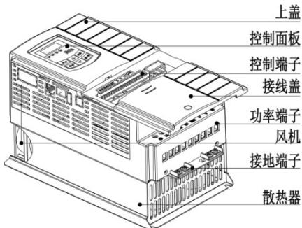
图 1-4 塑壳产品外形及结构部件图
