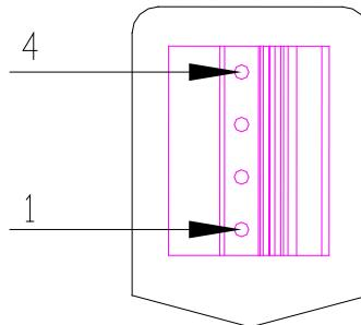
安规短接跳线接插件 J1 示意图
