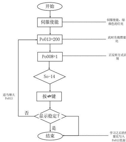
图 7.2.1 离线式转动惯量设置流程图
