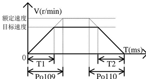
图 6.2.7 软启动功能的示意图
