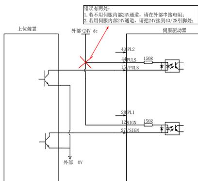
图 4.3.6 24V 集电极开路接线错误示意图 1
