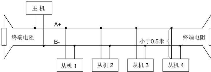
图 10.1.2 终端电阻的连接图
