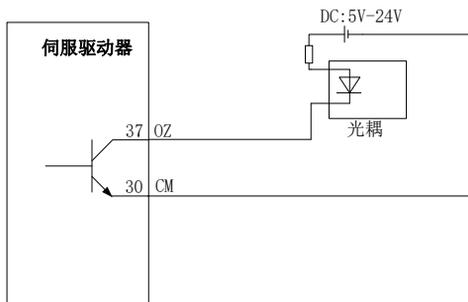
图 4.3.16 集电极 OZ 信号接口电路
