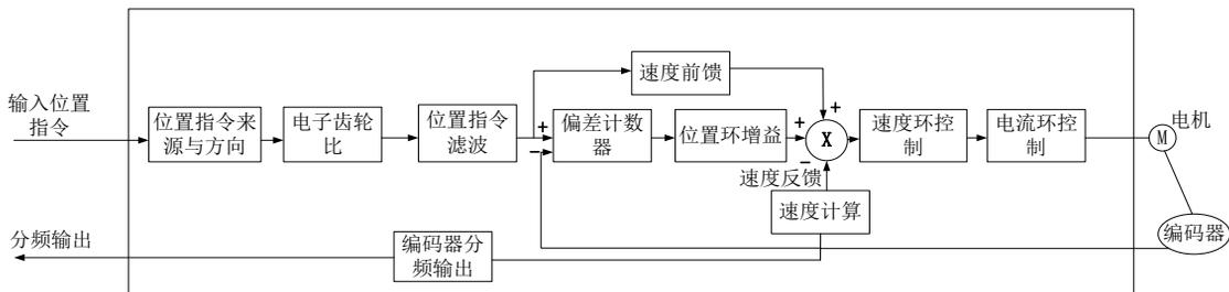
图 6.4.1 位置脉冲模式内部框图
