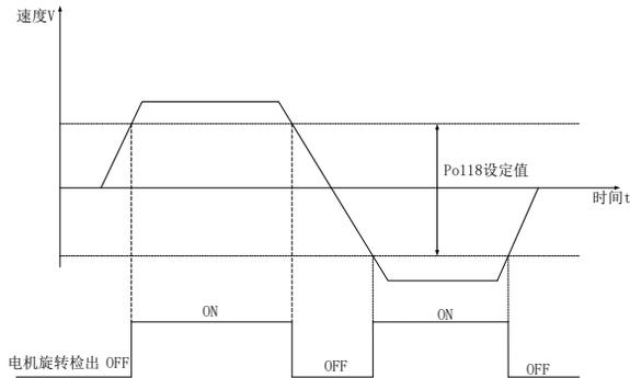
图 6.2.11 旋转检出信号输出示意图
