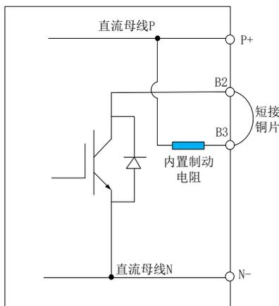
图 6.1.16 伺服内部能耗制动示意图
