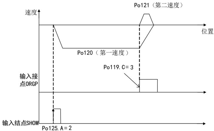
图 6. 4. 32 原点检索第一速度正转寻找原点
