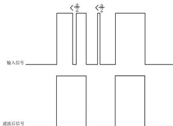
图 6.4.5 脉冲指令滤波示意图
