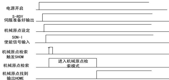
图 6. 4. 34 接入输入点时的时序图
