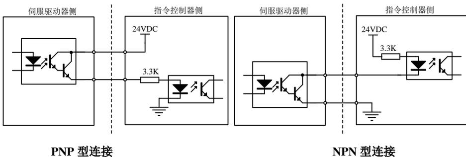
图 4.3.15 光电耦合器输出接口电路
