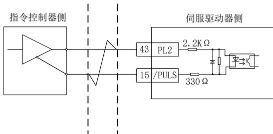
图 4.3.3 24V 差分脉冲输入接口电路
