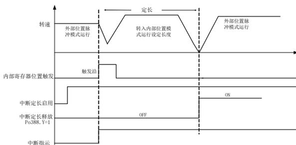
图 6.4.36 中断定长控制时序图
