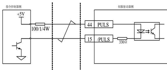
图 4.3.4 5V 集电极开路脉冲输入接口电路
