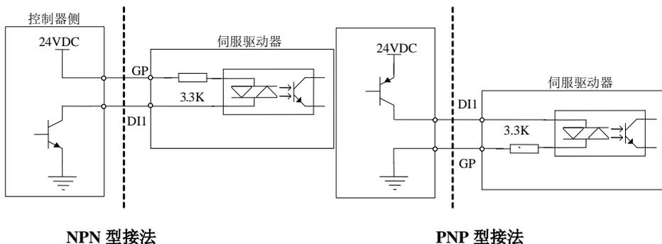
图 4.3.12 有源接点接口电路
