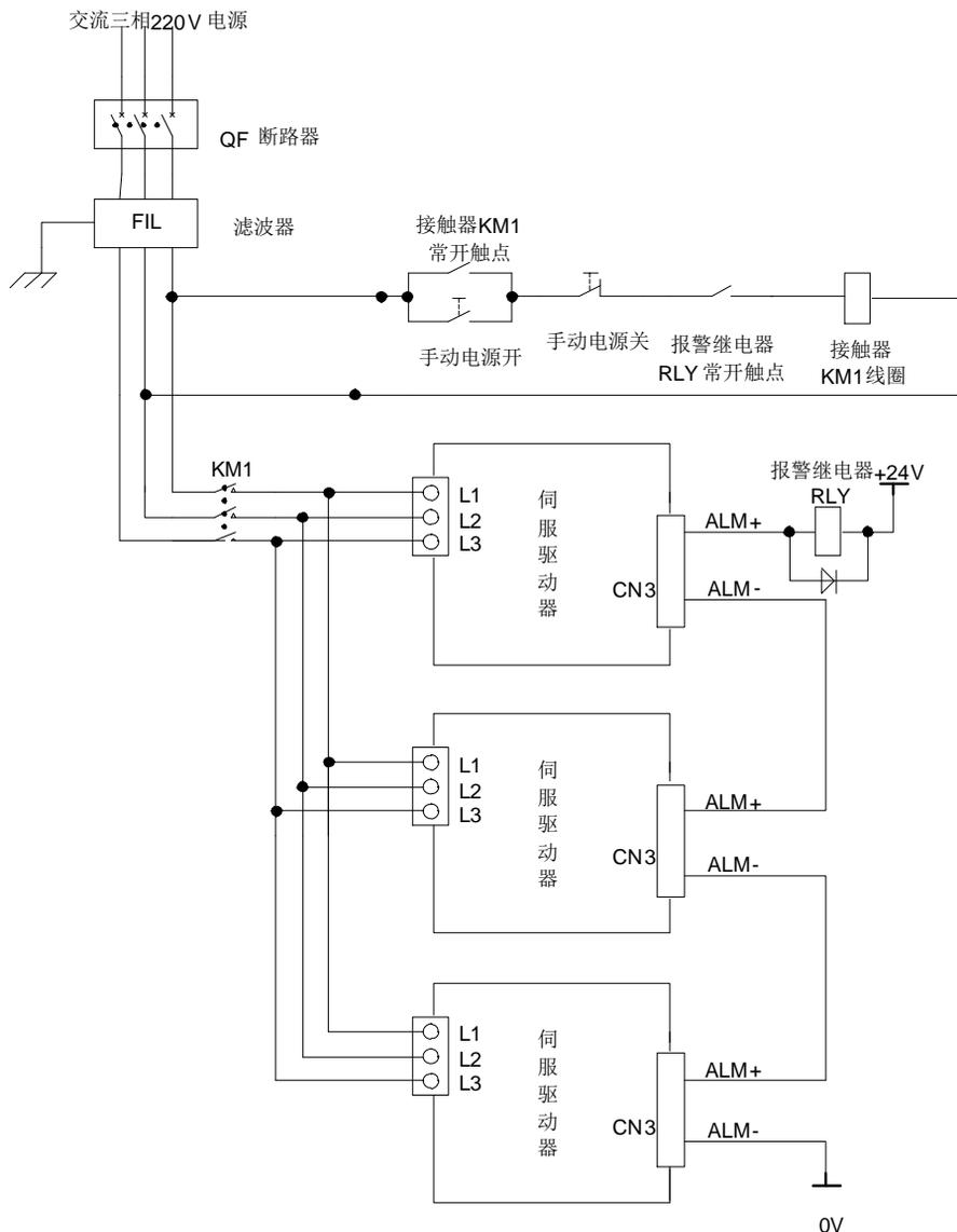
图 4.3.18 220V 多台联机时的接线
