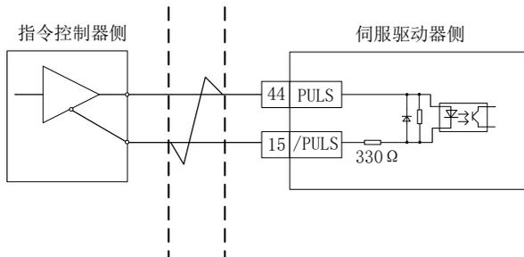
图 4.3.2 5V 差分脉冲输入接口电路
