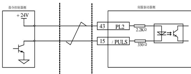
图 4.3.5 24V 集电极开路脉冲输入接口电路
