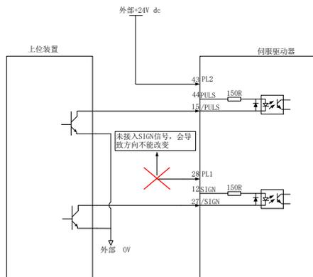
图 4.3.7 24V 集电极开路接线错误示意图 2
