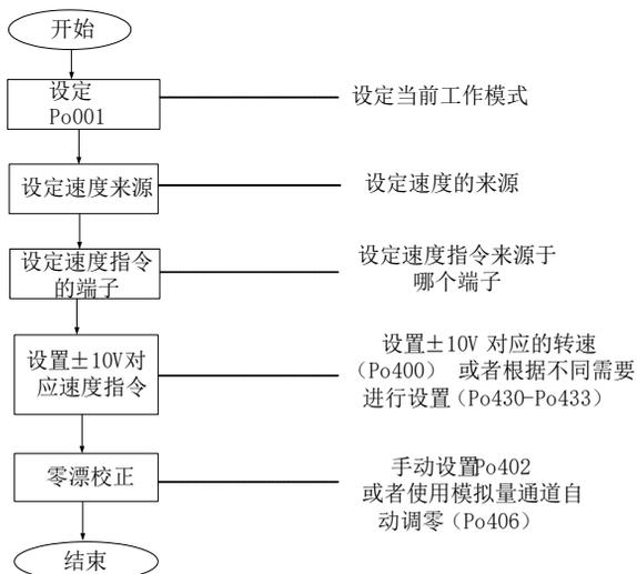
图 6.2.5 模拟量速度指令设定流程图
