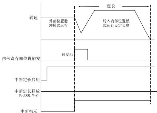
图 6.4.35 中断定长控制时序图
