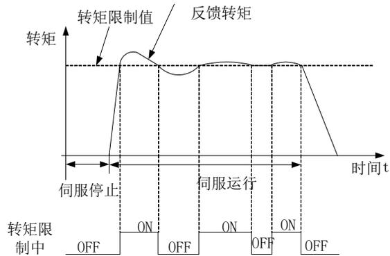
图 6.3.6 转矩限制中输出示意图
