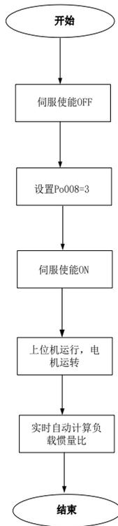
图 7.2.2 在线式转动惯量设置流程图
