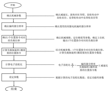
图 6.4.17 电子齿轮比设置步骤流程图
