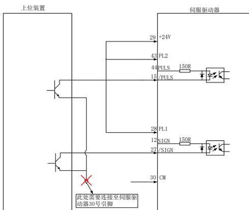
图 4.3.8 24V 集电极开路接线错误示意图 3
