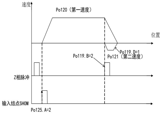
图 6. 4. 29 原点检索第一速度正转寻找原点
