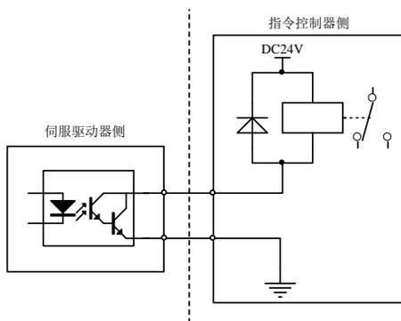
图 4.3.13 继电器输出接口正确电路示意图
