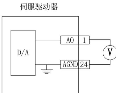
图 4.3.10 模拟量监控输出接口
