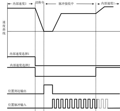
图 6.5.1 速度及位置脉冲模式切换模式时序
