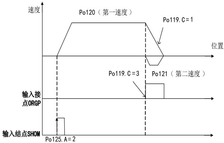
图 6. 4. 31 原点检索第一速度正转寻找原点
