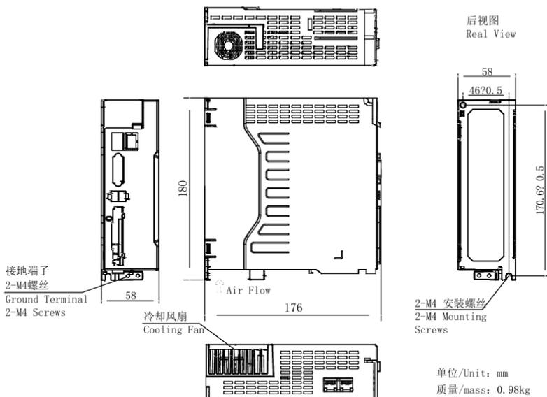
图 3.1.2 伺服驱动器 L3 结构尺寸
