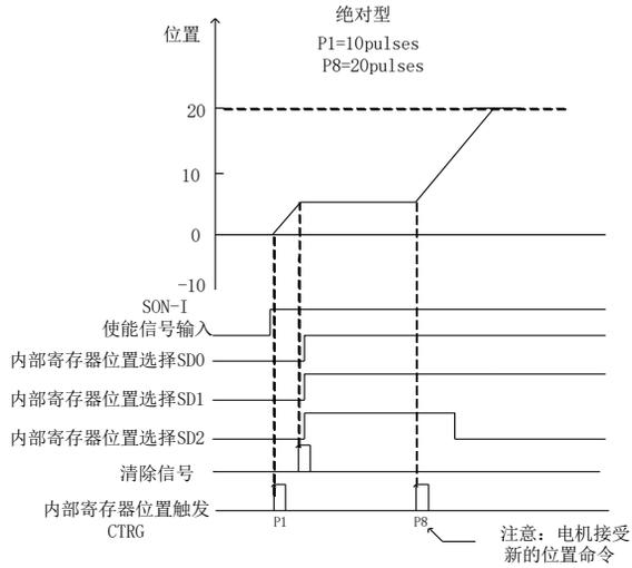
图 6.4.11 内部位置绝对模式再次触发时序图
