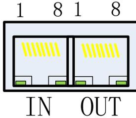
图 4.3.17 L2 结构通讯插头端子排列顺序图
