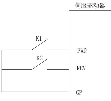
图 6.1.5 方向脉冲控制启停接线示意图
