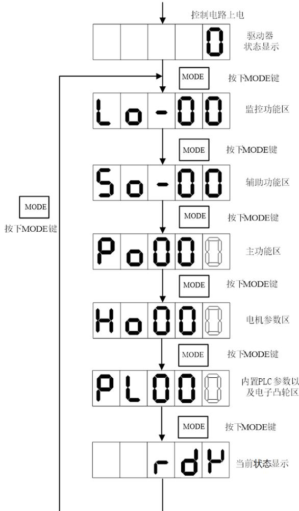
图 5.2.1 用户参数区切换示意图
