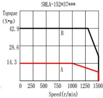
测试条件：1、60/80 法兰伺服电机安装在 260mm×260mm×28mm 铸铁法兰盘上测试；110/130/180 法兰伺服电机安装在 360mm×360mm×38mm 铸铁法兰盘上测试；2、采用匹配驱动器，且输入驱动器电压为额定电压。
