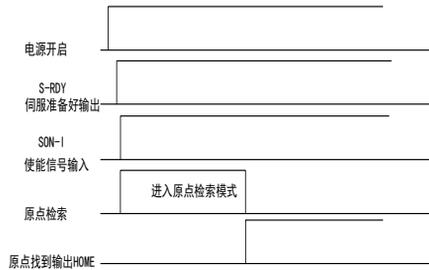
图 6. 4. 23 原点检索模式启动时序图
