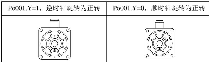
图 6.1.6 电机旋转方向示意图
