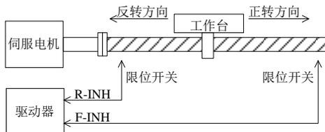
图 6.1.11 超程保护限位开关设置示意图
