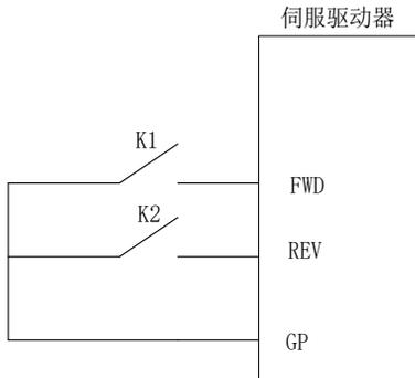
图 6.1.2 两线式运转模式 2 接线示意图
