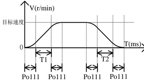
图 6.2.8 S 曲线平滑功能的示意图
