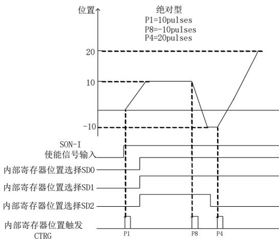
图 6.4.9 内部位置绝对模式时序图
