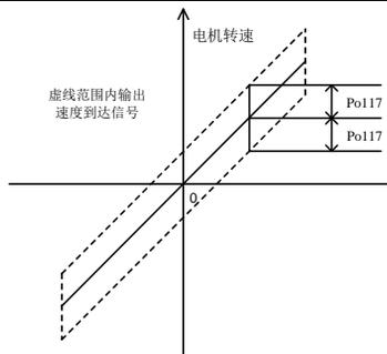
图 6.2.10 速度到达信号输出示意图
