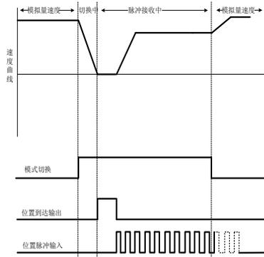
图 6.5.2 模拟量速度及位置脉冲时序图
