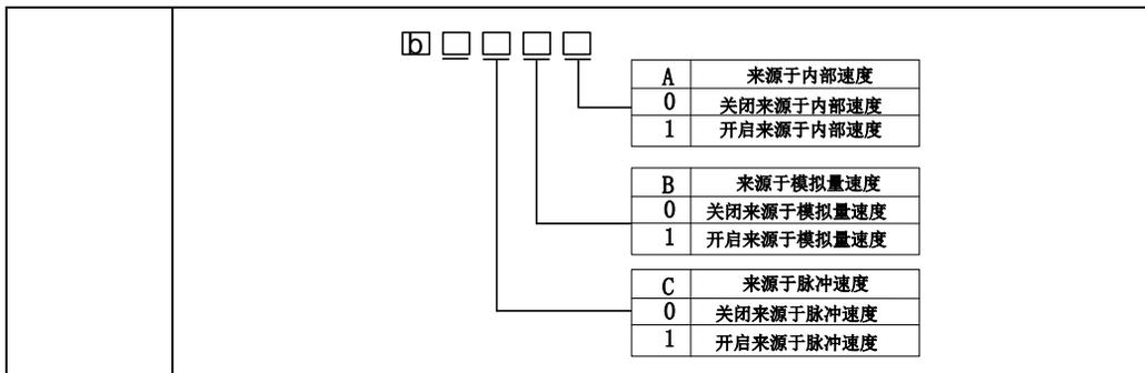
当速度指令来源于脉冲速度时，电机速度等于脉冲信号经过电子齿轮比折算之后的速度。
