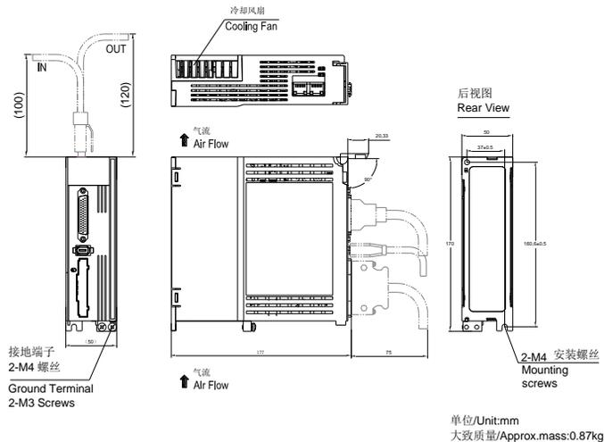
图 3.1.1 伺服驱动器 L2 结构尺寸
