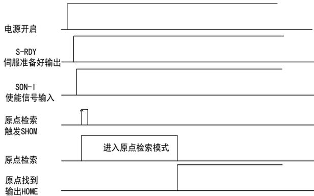
图 6. 4. 24 接入输入点时的时序图
