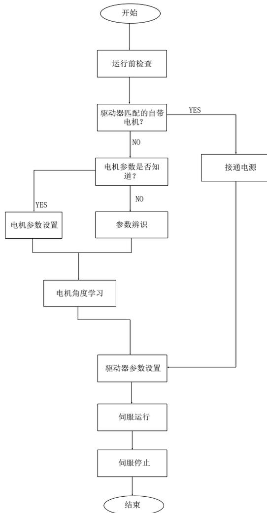
图 6.1 伺服驱动器设定流程简图
