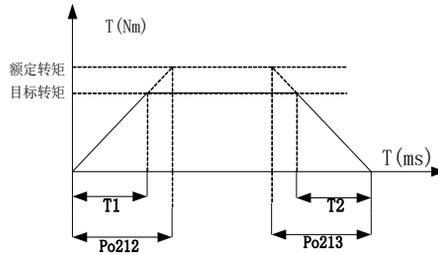
图 6.3.4 转矩模式下速度平滑功能示意图
