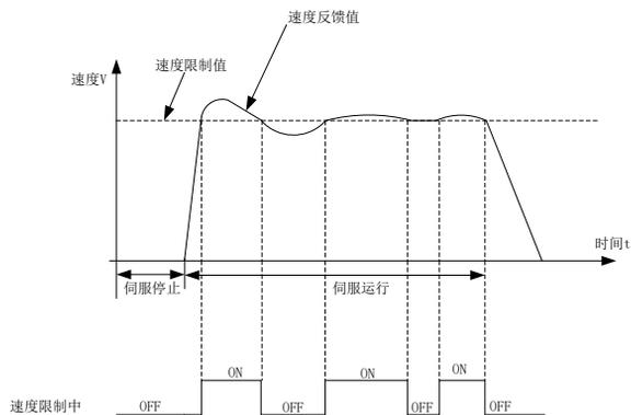
图 6.6.2 转矩模式下速度限制中输出示意图
