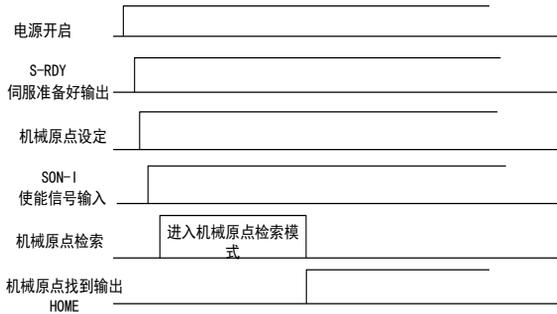
图 6. 4. 33 机械原点检索模式启动时序图
