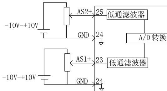
图 4.3.9 模拟量输入接口电路
