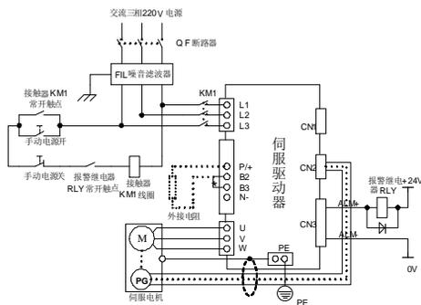
图 4.1.2 220V 驱动器典型主电路配线图
