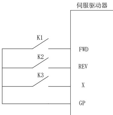
图 6.1.3 三线式运转模式 1 接线示意图
