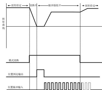
图 6.5.5 转矩模式及位置脉冲模式时序图
