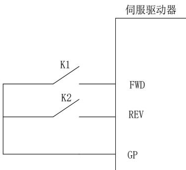
图 6.1.1 两线式运转模式 1 接线示意图
