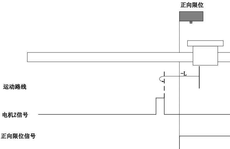
回零启动时 F-INH=1，直接反向低速开始回零，遇到 F-INH 下降沿后 Z 信号折返到 Z 信号；
