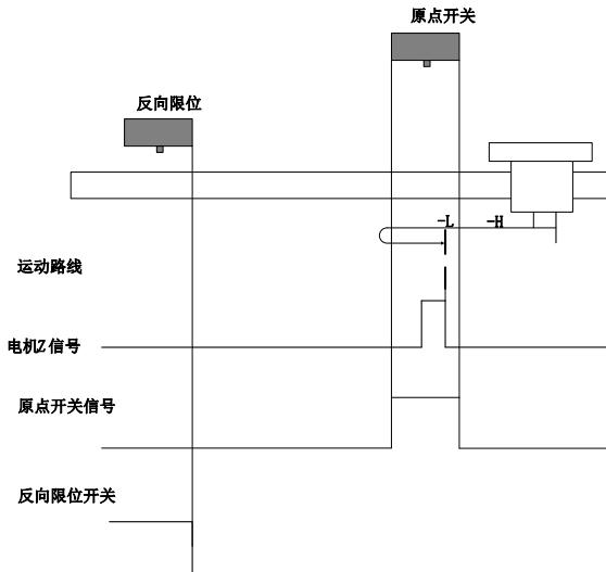
开始回零时 ORGP=0，以反向高速开始回零，未遇到限位开关，遇到 ORGP 上升沿后，减速，反向低速运行，遇到 ORGP 下降沿后，继续反向低速运行，之后遇到的 Z 信号折返到 Z 信号；
