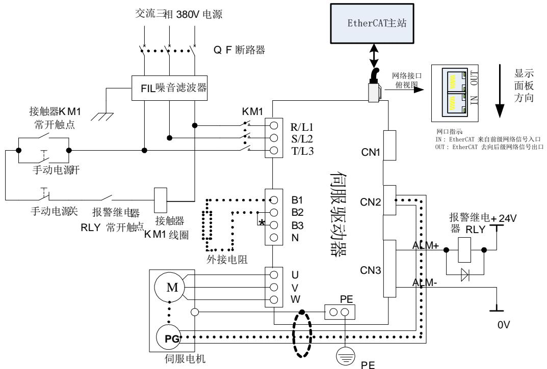
图 4.1.5 380V 驱动器典型主电路配线图
