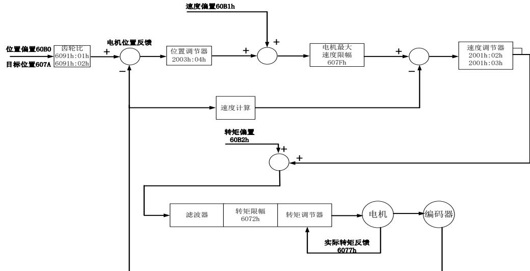
图 7.6.1 周期同步位置 (CSP) 控制框图
