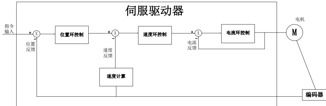
图 7 伺服系统控制框架图
