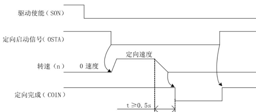
图 8.3.2 电机自由或零速中主轴定向时序
