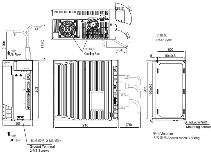
图 3.1.6 伺服驱动器结构尺寸 2
