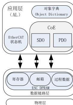
图 6.3.1 基于 CANOpen 应用层的 EtherCAT 通信结构
