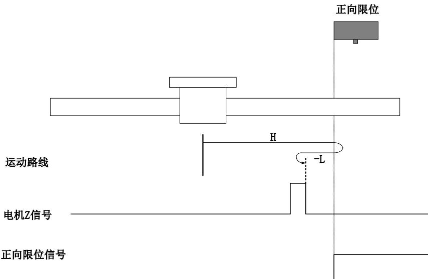
开始回零时 F-INH=0，以正向高速开始回零，遇到 F-INH 上升沿后，减速，反向，反向低速运行，遇到 F-INH 下降沿后的 Z 信号折返到 Z 信号；
