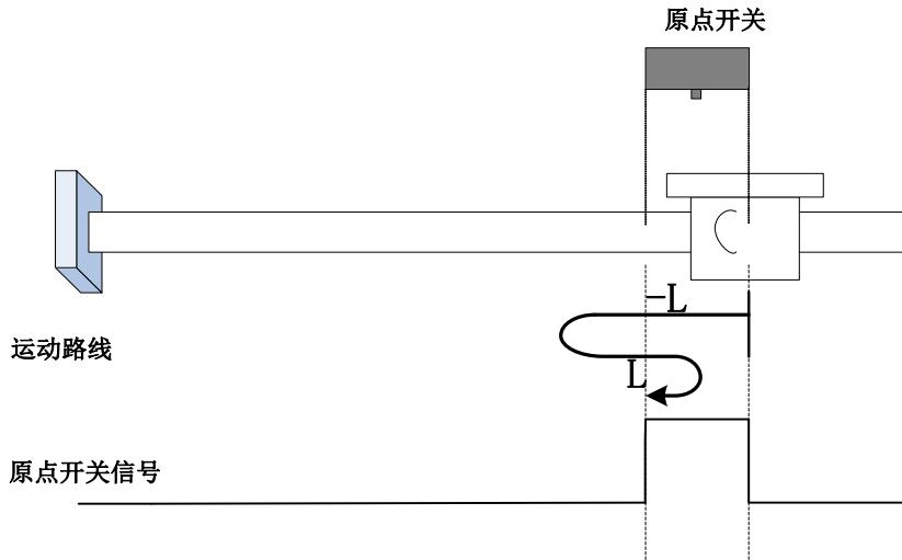
回零启动时 ORGP=1，则直接反向低速开始回零，遇到 ORGP 下降沿后，反向，正向低速，遇到 ORGP 上升沿折返到上升沿；
