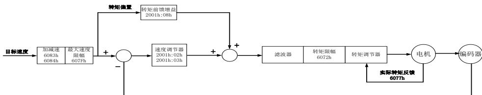
图 7.4.1 轮廓速度模式（PV）控制框图
