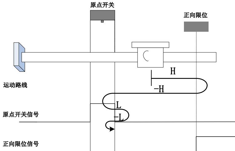
开始回零时 ORGP=0，以正向高速开始回零，遇到限位开关，自动反向，反向高速运行，遇到 ORGP 上升沿后，减速反向即恢复正向运行，正向低速遇到 ORGP 下降沿后，反向，反向低速运行中遇到 ORGP 上升沿折返到上升沿；
