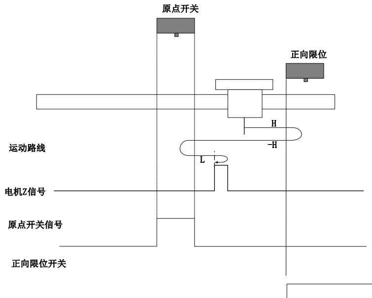
开始回零时 ORGP=0, 以正向高速开始回零, 若遇到限位开关, 自动反向, 反向高速运行, 遇到 ORGP
