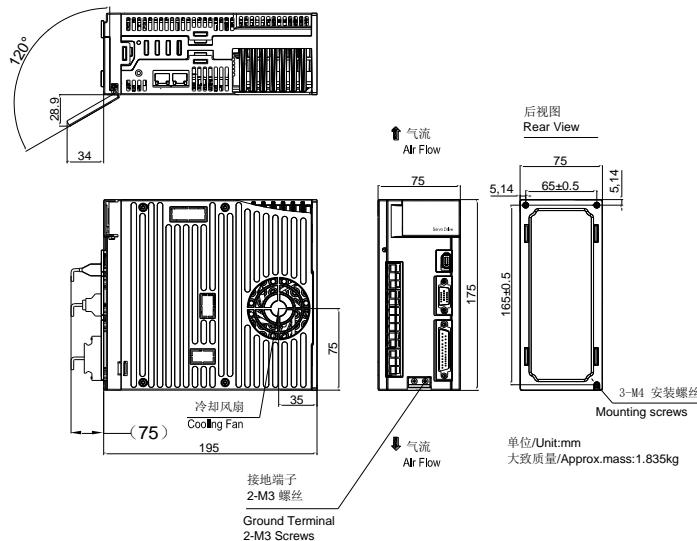
图 3.1.5 伺服驱动器结构尺寸 1
