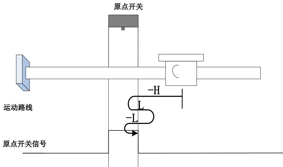
开始回零时 ORGP=0，以反向高速开始回零，未遇到限位开关，遇到 ORGP 上升沿后，减速，反向，正向低速运行，遇到 ORGP 下降沿后，反向，反向低速运行，遇到 ORGP 上升沿折返到上升沿；
