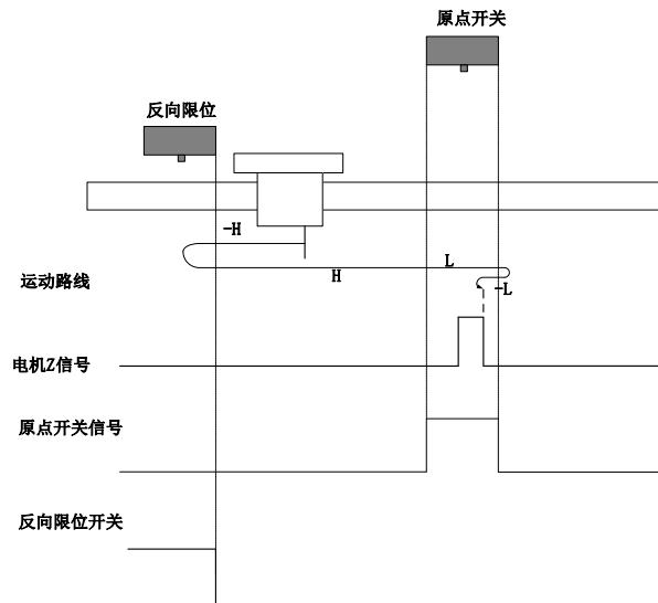
开始回零时 ORGP=0，以反向高速开始回零，遇到限位开关，自动反向，正向高速运行，遇到 ORGP 上升沿后，减速，正向低速运行，遇到 ORGP 下降沿后，反向，反向低速运行，遇到 ORGP 上升沿后 Z 信号折返到 Z 信号；
