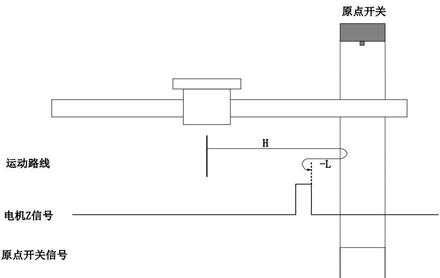
开始回零时 ORGP=0，以正向高速开始回零，遇到 ORGP 上升沿后，减速，反向，反向低速运行，遇到 ORGP 下降沿后，继续运行，之后遇到 Z 信号折返到 Z 信号；
