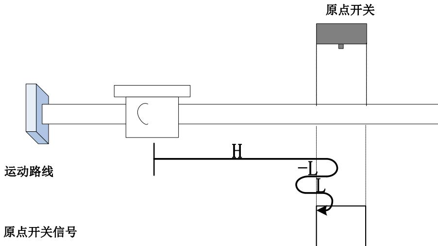
开始回零时 ORGP=0，以正向高速开始回零，未遇到限位开关，遇到 ORGP 上升沿后，减速，反向，反向低速运行，遇到 ORGP 下降沿后，反向，正向低速运行，遇到 ORGP 上升沿折返到上升沿；
