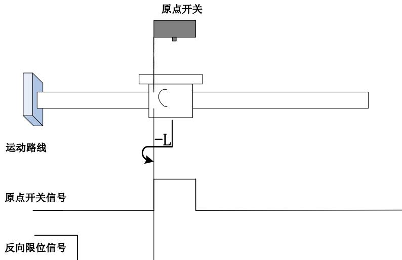
回零启动时 ORGP=1，则直接反向低速开始回零，遇到 ORGP 下降沿折返点下降沿；
