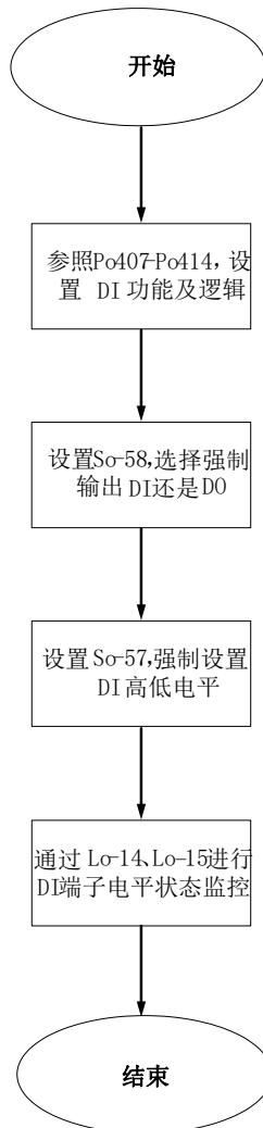
图 7.3.2 DI 信号强制输入设定步骤示意图
