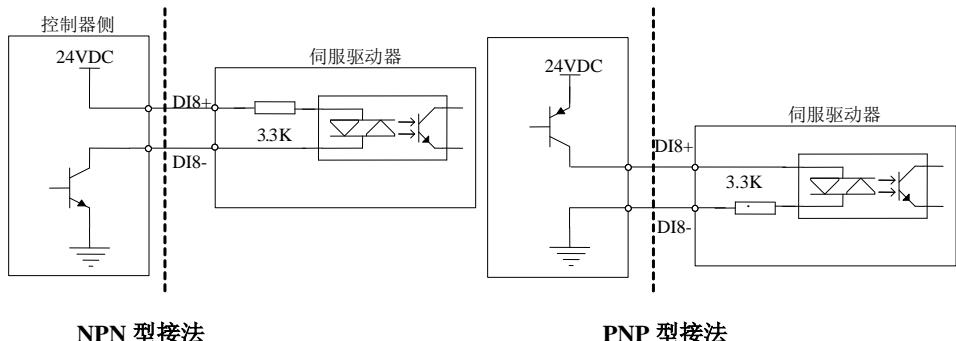
图 4.3.15 DI8 接线图示
