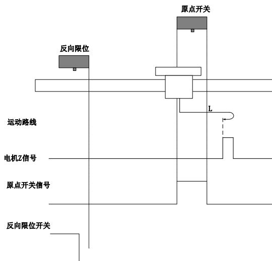
回零启动时 ORGP=1，则直接正向低速开始回零，遇到 ORGP 下降沿后的 Z 信号折返到 Z 信号；
