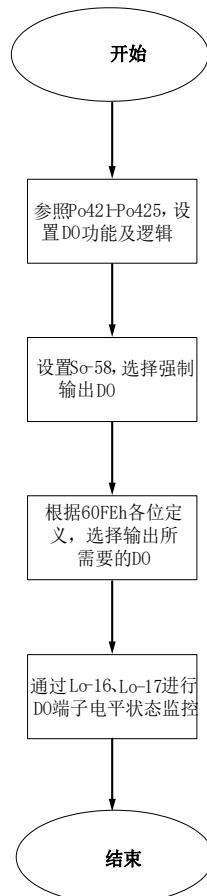
图 7.3.3 DO 信号强制输入设定步骤示意图
