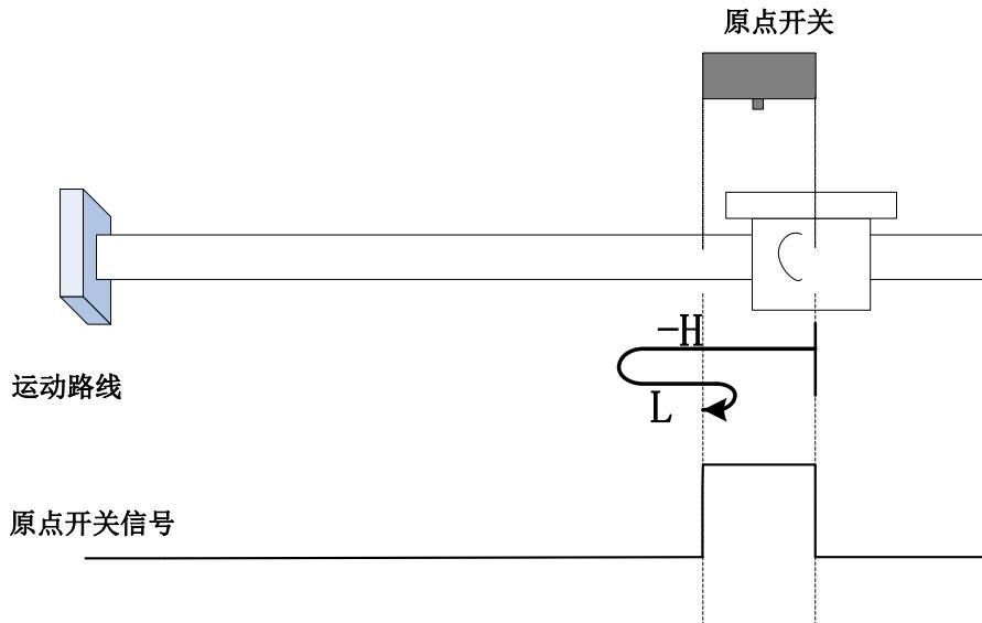
回零启动时 ORGP=1，以反向高速开始回零，遇到 ORGP 下降沿后，减速，反向，正向低速运行，遇到 ORGP 上升沿折返到上升沿；
