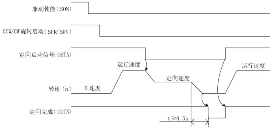
图 8.3.1 电机运动中主轴定向时序
