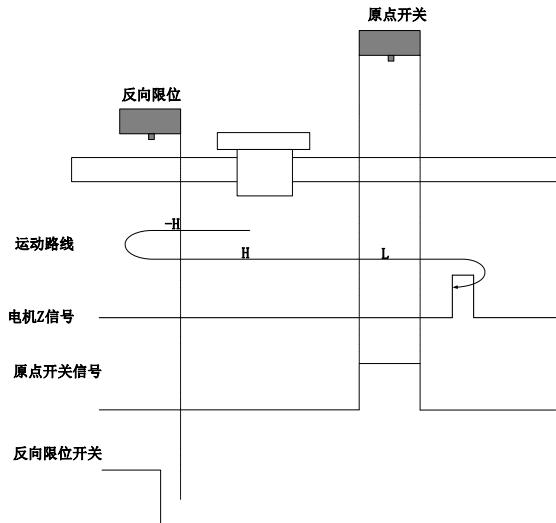
开始回零时 ORGP=0，以反向高速开始回零，若遇到限位开关，自动反向，正向高速运行，遇到 ORGP 上升沿后，减速，继续正向低速运行，遇到 ORGP 下降沿后的 Z 信号折返到 Z 信号；
