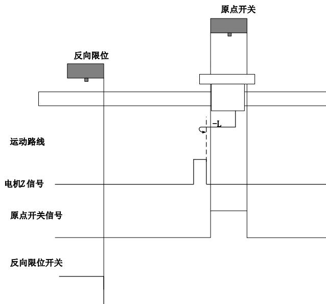
回零启动时 ORGP=1，则直接反向低速开始回零，遇到 ORGP 下降沿后的第一个 Z 停机；
