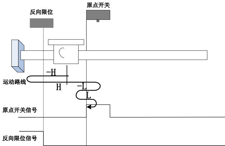
开始回零时 ORGP=0，以反向高速开始回零，遇到限位开关，自动反向，正向高速运行，遇到 ORGP 上升沿后，减速反向运行，反向低速遇到 ORGP 下降沿后，反向，正向低速运行中遇到 ORGP 上升沿折返到上升沿；
