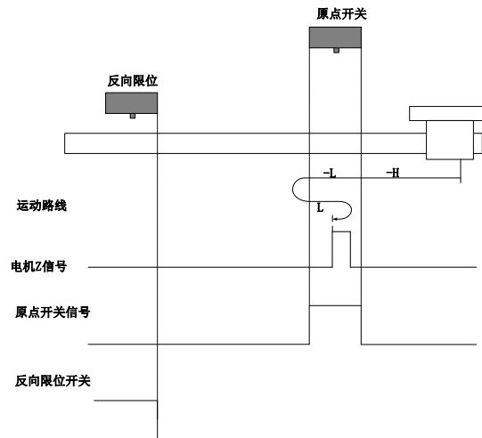
开始回零时 ORGP=0，以反向高速开始回零，若未遇到限位开关，遇到 ORGP 上升沿后，减速，反向低速运行，遇到 ORGP 下降沿后，反向，正向低速运行，遇到 ORGP 上升沿后的 Z 信号折返到 Z 信号；
