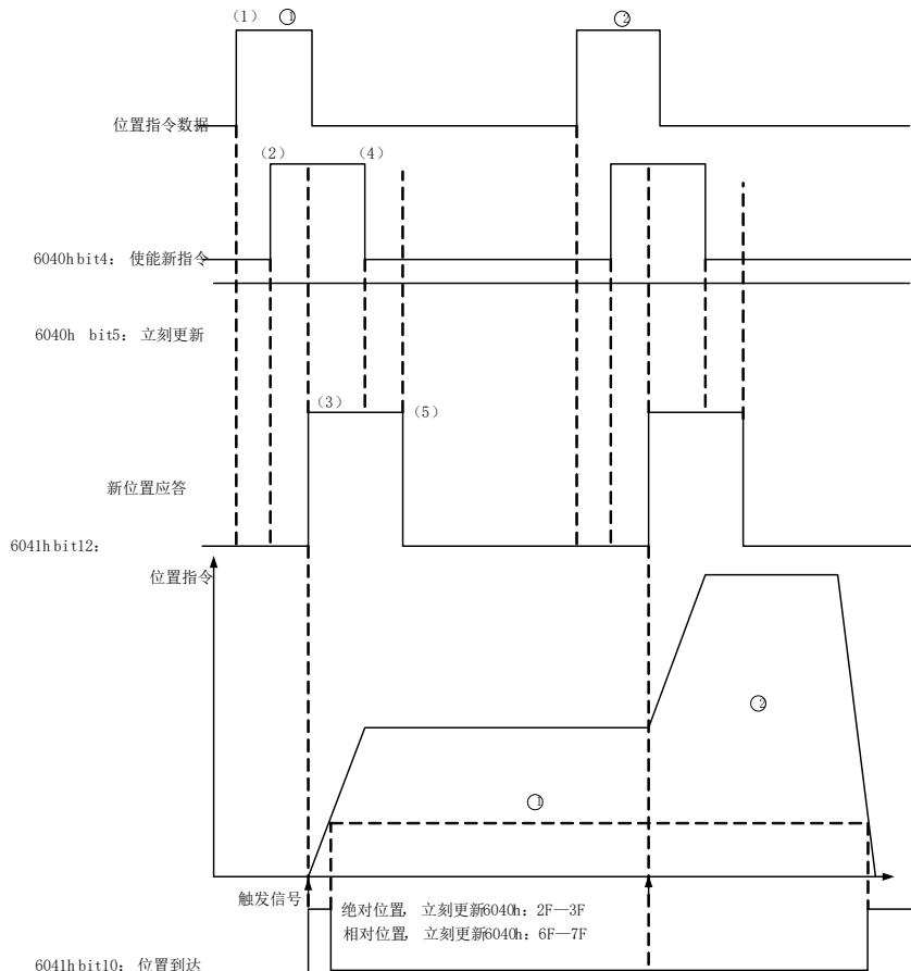
图 7.3.2 立刻更新型时序图与电机运行曲线
