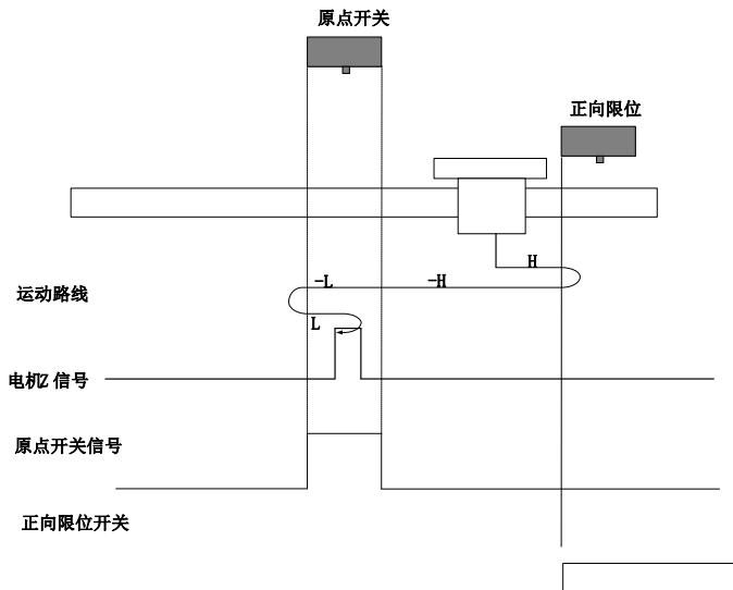
开始回零时 ORGP=0，以正向高速开始回零，若遇到限位开关，自动反向，反向高速运行，遇到 ORGP 上升沿后，减速，反向低速运行，遇到 ORGP 下降沿后，反向，正向低速，遇到 ORGP 上升沿
