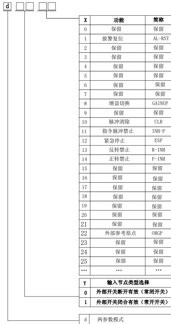
图 8.1.1 可编程输入端子功能设定示意图
