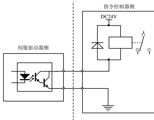
图 4.3.16 继电器输出接口正确电路示意图
