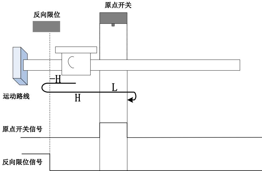
开始回零时 ORGP=0，以反向高速开始回零，遇到限位开关，自动反向，正向高速运行，遇到 ORGP 上升沿后，减速，继续正向低速运行，遇到 ORGP 下降沿折返到下降沿；
