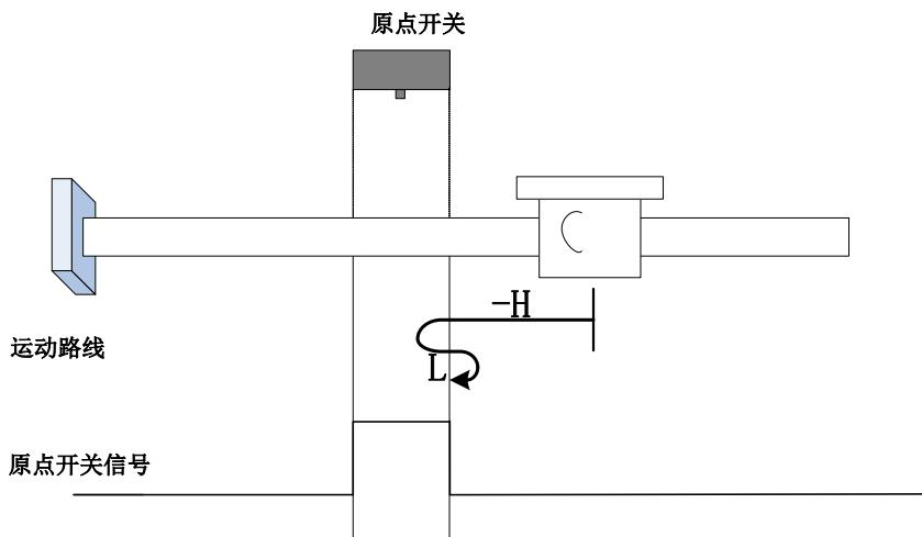
开始回零时 ORGP=0，以反向高速开始回零，遇到 ORGP 上升沿后，减速，反向，正向低速运行，遇到 ORGP 下降沿折返到下降沿；
