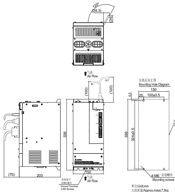
图 3.1.8 伺服驱动器结构尺寸 4
