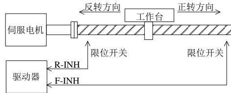
图 7.1.5 超程保护限位开关设置示意图
