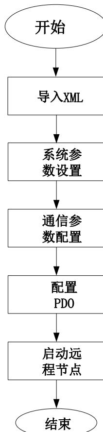
图 6.1.2 EtherCAT 使用设置流程图
