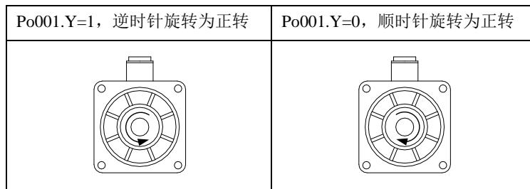
图 7.1.1 电机旋转方向示意图
