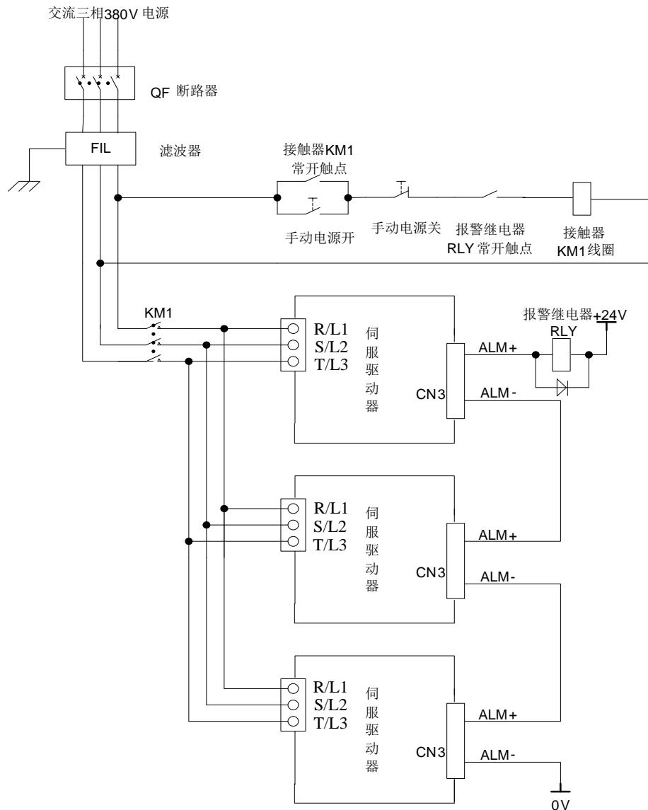
图 4.3.24 380V 多台联机时的接线
