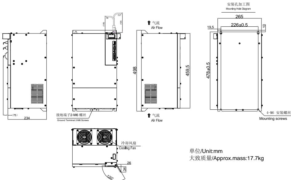
图 3.1.10 伺服驱动器结构尺寸 6
