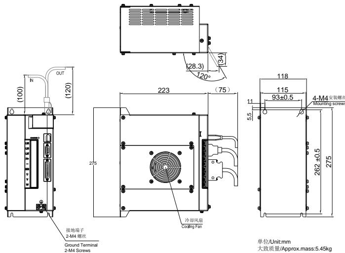
图 3.1.7 伺服驱动器结构尺寸 3
