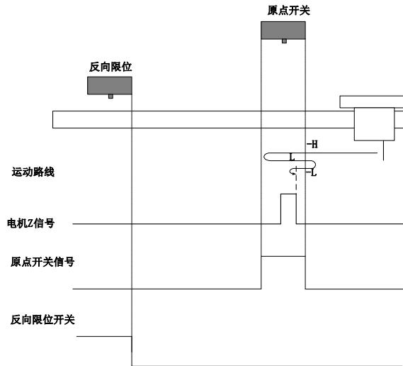
开始回零时 ORGP=0，以反向高速开始回零，未遇到限位开关，遇到 ORGP 上升沿后，减速，反向，正向低速运行，遇到 ORGP 下降沿后，反向，反向低速运行，遇到 ORGP 上升沿后的 Z 信号折返到 Z 信号；
