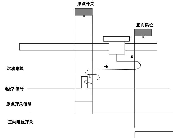
开始回零时 ORGP=0，以正向高速开始回零，若遇到限位开关，自动反向，反向高速运行，遇到 ORGP 上升沿后，减速反向即恢复正向运行，正向低速遇到 ORGP 下降沿后，反向，反向低速运行中遇到 ORGP 上升沿后的 Z 信号折返到 Z 信号；
