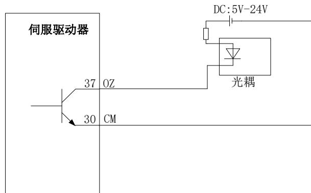
图 4.3.21 集电极 OZ 信号接口电路
