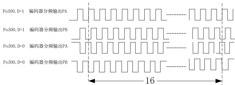
图 7.2.6 编码器信号分频示意图
