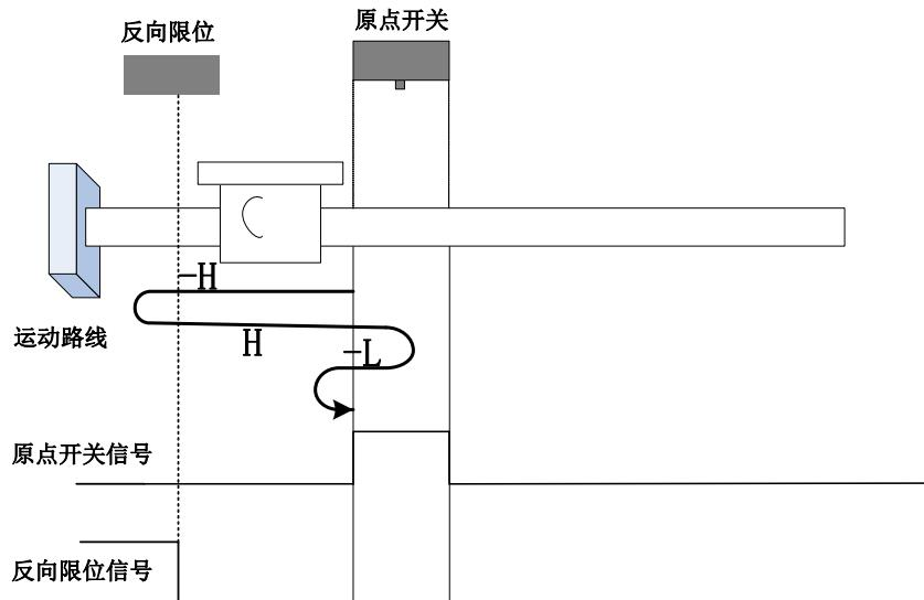
开始回零时 ORGP=0，以反向高速开始回零，遇到限位开关，自动反向，正向高速运行，遇到 ORGP 上升沿后，减速反向运行，反向低速遇到 ORGP 下降沿折返点下降沿；
