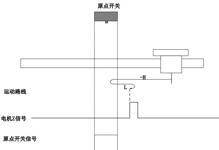
开始回零时 ORGP=0，以反向高速开始回零，若未遇到限位开关，遇到 ORGP 上升沿后，减速，反向，正向低速运行，遇到 ORGP 下降沿后的 Z 信号折返到 Z 信号；
