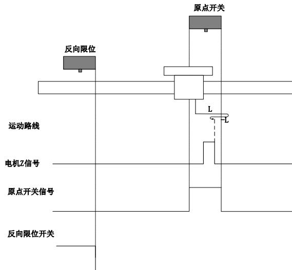
回零启动时 ORGP=1，则直接正向低速开始回零，遇到 ORGP 下降沿后，反向，反向低速，遇到 ORGP 上升沿后的 Z 信号折返到 Z 信号；
