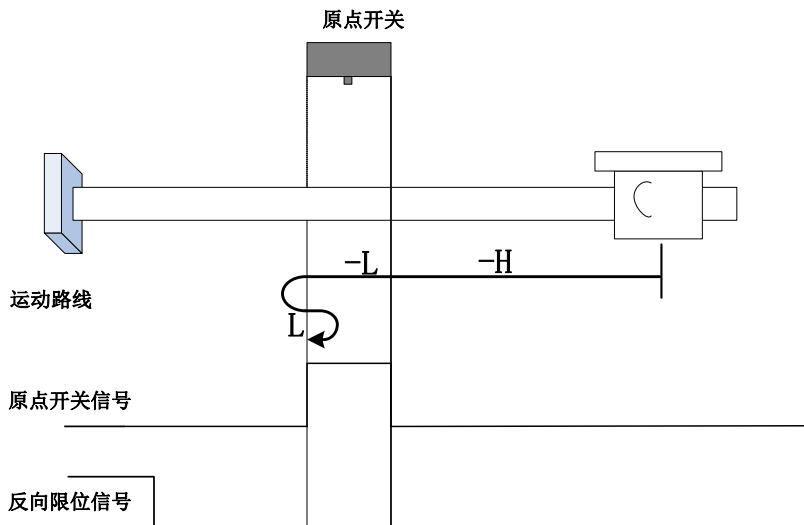
开始回零时 ORGP=0，以反向高速开始回零，未遇到限位开关，遇到 ORGP 上升沿后，减速，反向低速运行，遇到 ORGP 下降沿后，反向，正向低速运行，遇到 ORGP 上升沿折返到上升沿；
