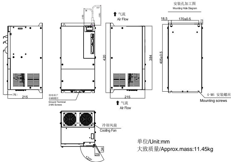
图 3.1.9 伺服驱动器结构尺寸 5
