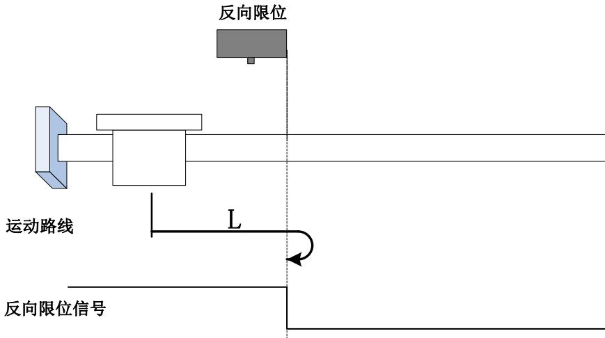
回零启动时 R-INH=1，直接正向低速开始回零，遇到 R-INH 下降沿后折返到下降沿。
