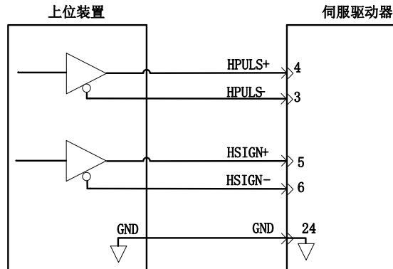
图 4.3.10 高速脉冲输入接口电路
