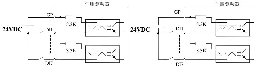
图 4.3.13 无源接点接口电路
