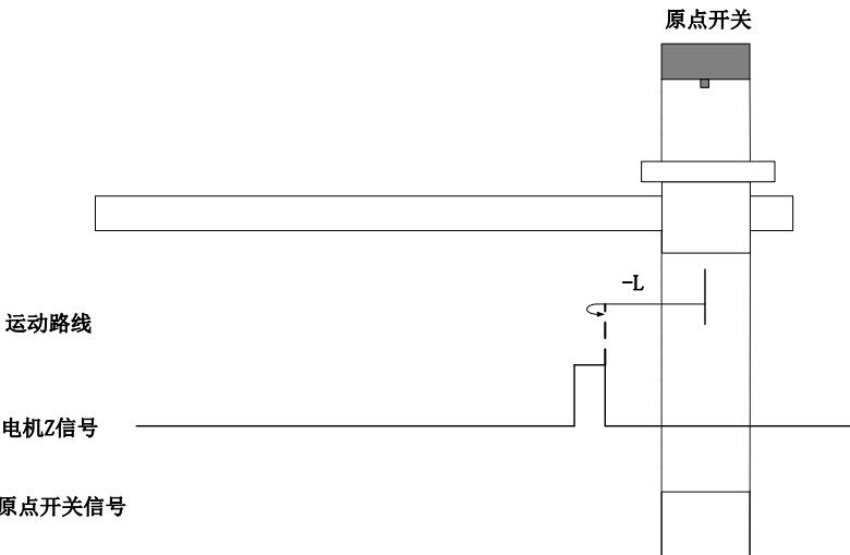
回零启动时 ORGP=1，直接反向低速开始回零，遇到 ORGP 下降沿后的 Z 信号折返到 Z 信号；
