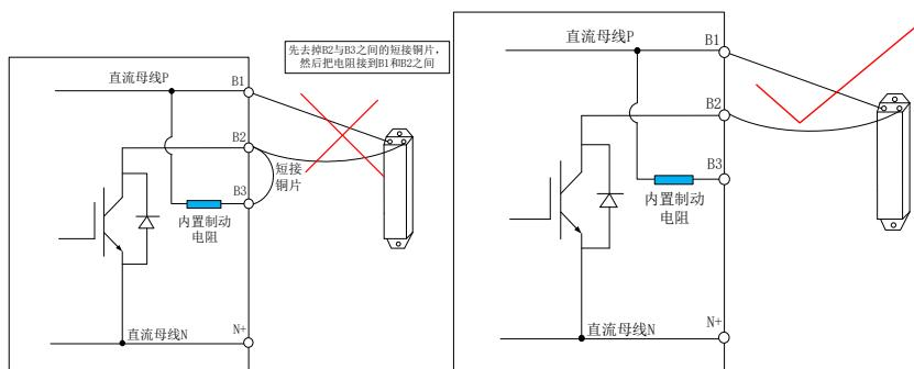
图 7.1.11 伺服制动电阻接线示意图
