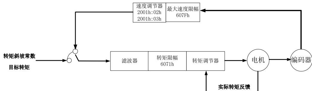
图 7.8.1 周期同步转矩 (CST) 控制框图
