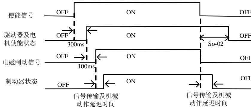
图 7.1.3 电磁抱闸制动时序图
