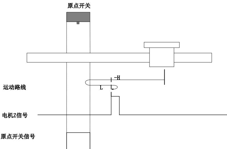
开始回零时 ORGP=0，以反向高速开始回零，遇到 ORGP 上升沿后，减速，反向，正向低速运行，遇到 ORGP 下降沿后的 Z 信号折返到 Z 信号；
