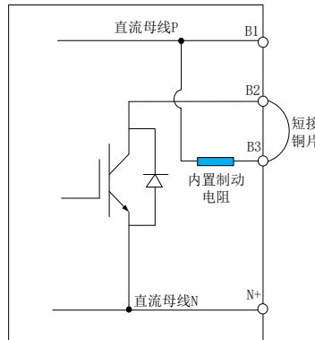
图 7.1.10 伺服内部能耗制动示意图
