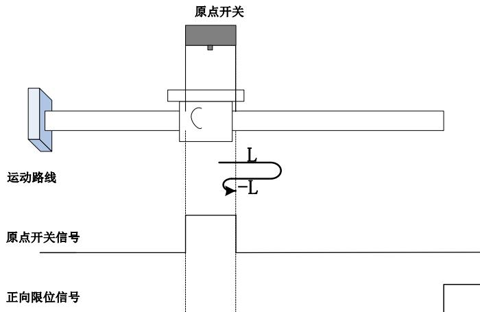
回零启动时 ORGP=1，则直接正向低速开始回零，遇到 ORGP 下降沿后，反向，反向低速运行中，遇到 ORGP 上升沿折返到上升沿；
