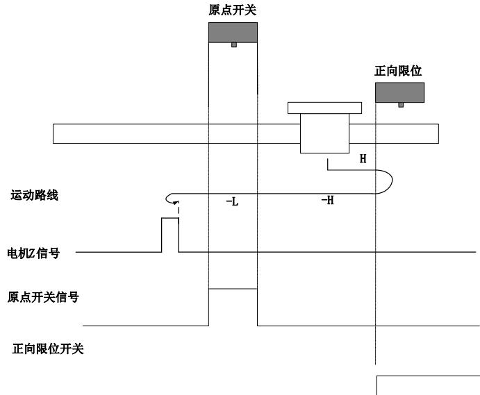
开始回零时  $ORGP=0$ , 以正向高速开始回零, 若遇到限位开关, 自动反向, 反向高速运行, 遇到  $ORGP$  上升沿后, 减速, 继续反向低速运行, 遇到  $ORGP$  下降沿后的 Z 信号折返到 Z 信号;
