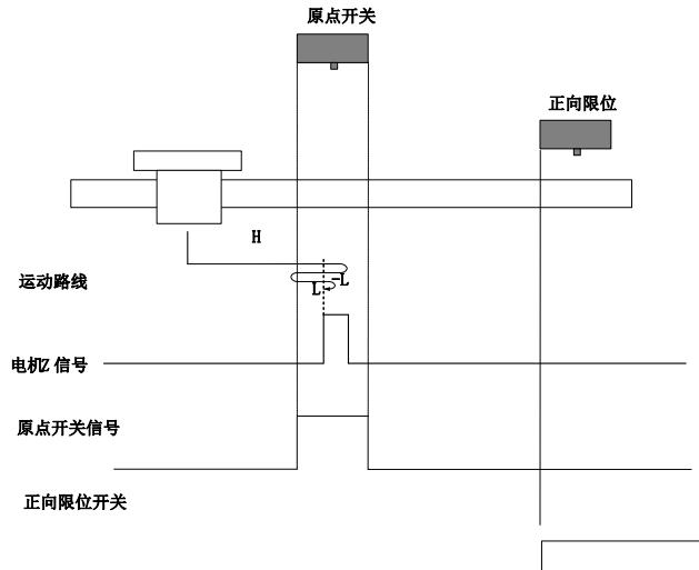
开始回零时 ORGP=0，以正向高速开始回零，若未遇到限位开关，遇到 ORGP 上升沿后，减速，反向，反向低速运行，遇到 ORGP 下降沿后，反向，正向低速运行，遇到 ORGP 上升沿后的 Z 信号折返到 Z 信号；
