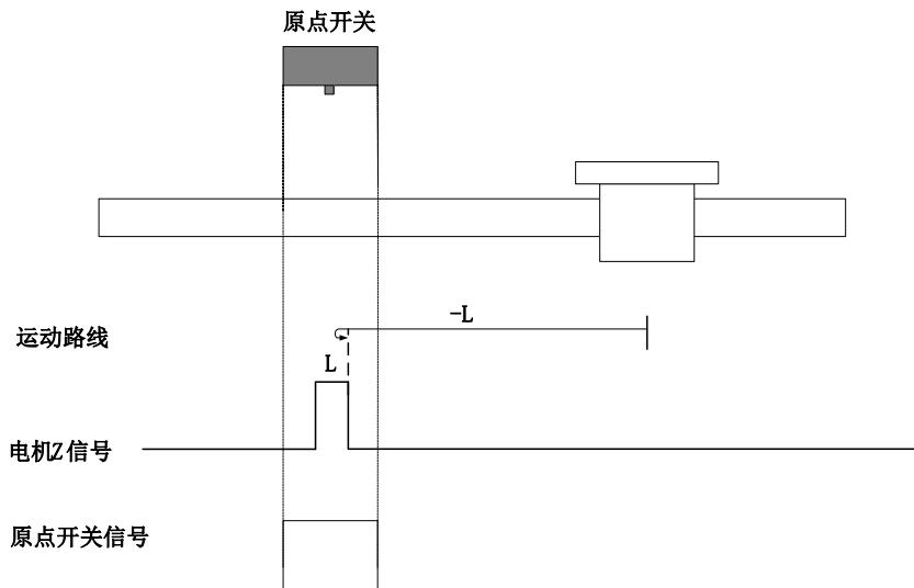
开始回零时 ORGP=0，直接反向低速开始回零，遇到 ORGP 上升沿后 Z 信号折返到 Z 信号；
