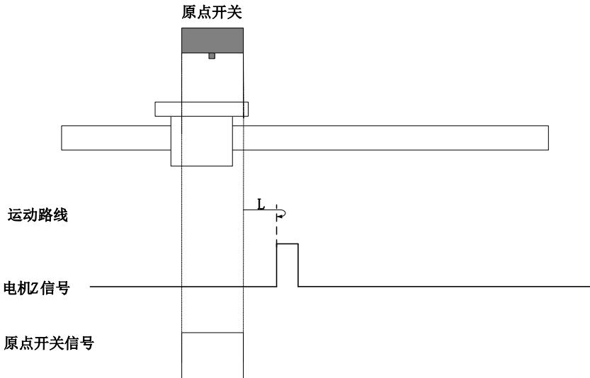
回零启动时 ORGP=1，则直接正向低速开始回零，遇到 ORGP 下降沿后的 Z 信号折返到 Z 信号号；
