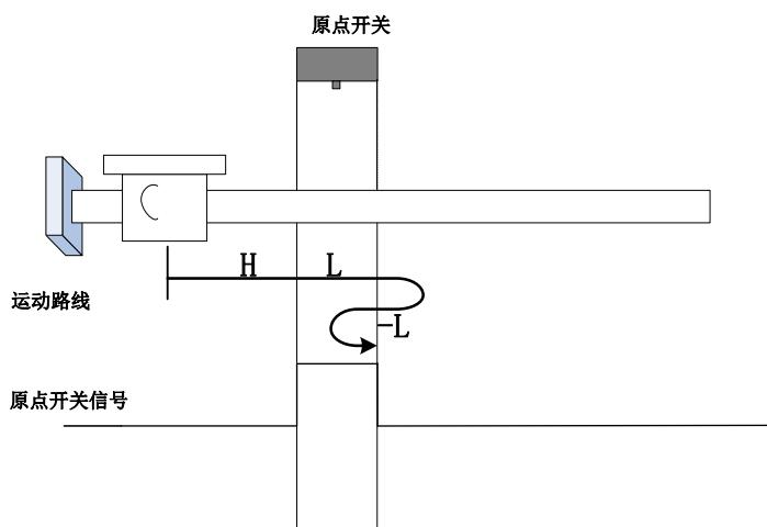
开始回零时 ORGP=0，以正向高速开始回零，未遇到限位开关，遇到 ORGP 上升沿后，减速，正向低速运行，遇到 ORGP 下降沿后，反向，反向低速运行，遇到 ORGP 上升沿折返到上升沿；
