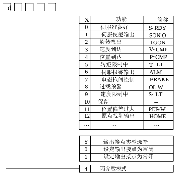
图 8.1.2 可编程输出端子功能设定示意图
