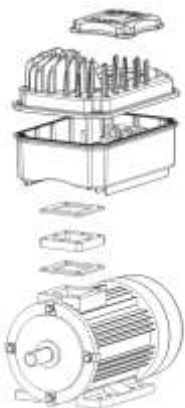
图 4-1-4 J1 变频器与电机安装示意图
