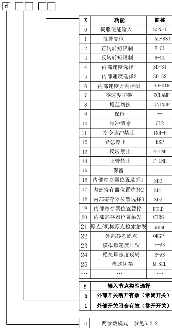
图 8.1.1 可编程输入端子功能设定示意图
