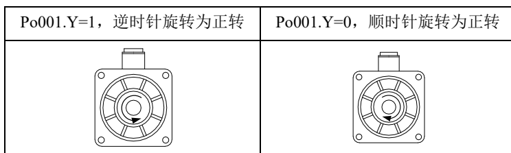
图 6.1.6 电机旋转方向示意图
