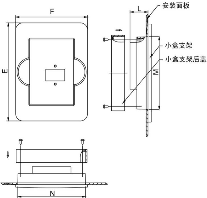
图 3-4 控制面板安装支架结构尺寸示意图
