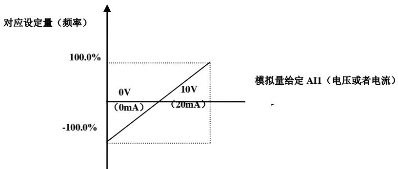
图 6-9 模拟给定与设定量的对应关系
