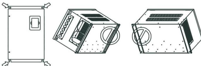
图 1-2 变频器垂直安装示意图
