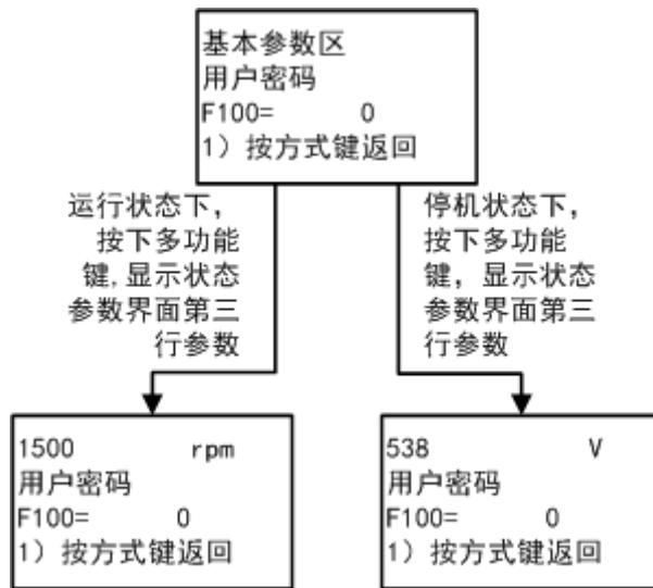
图 5-3 编程界面操作流程图
