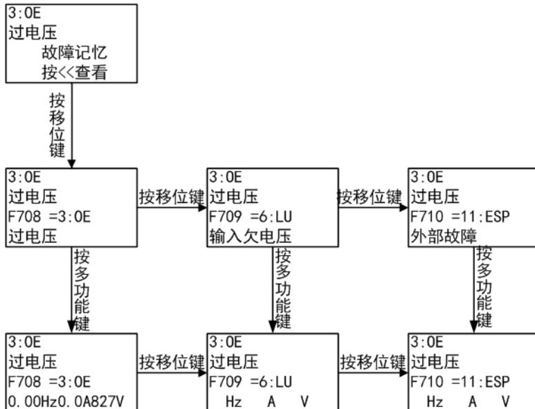
图 5-5 故障界面操作流程图
