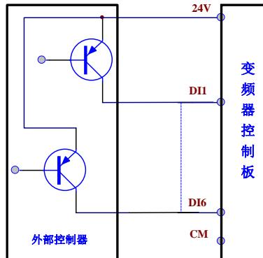
图 4-11 有源共漏极接线方式示意图
