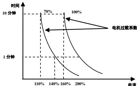
图 6-11 电机过载系数设定
