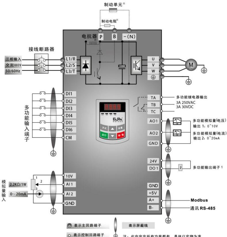
图 4-14 三相变频器标准配线图 (NPN 方式)
