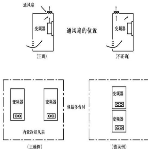
图 1-3 变频器安装在控制柜内示意图
