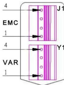
图 4-20 安规短接跳线接插件 J1 示意图
