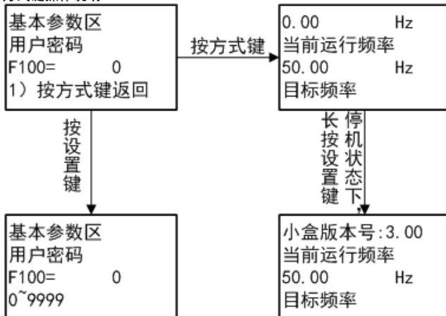
图 5-2 界面切换操作流程图
