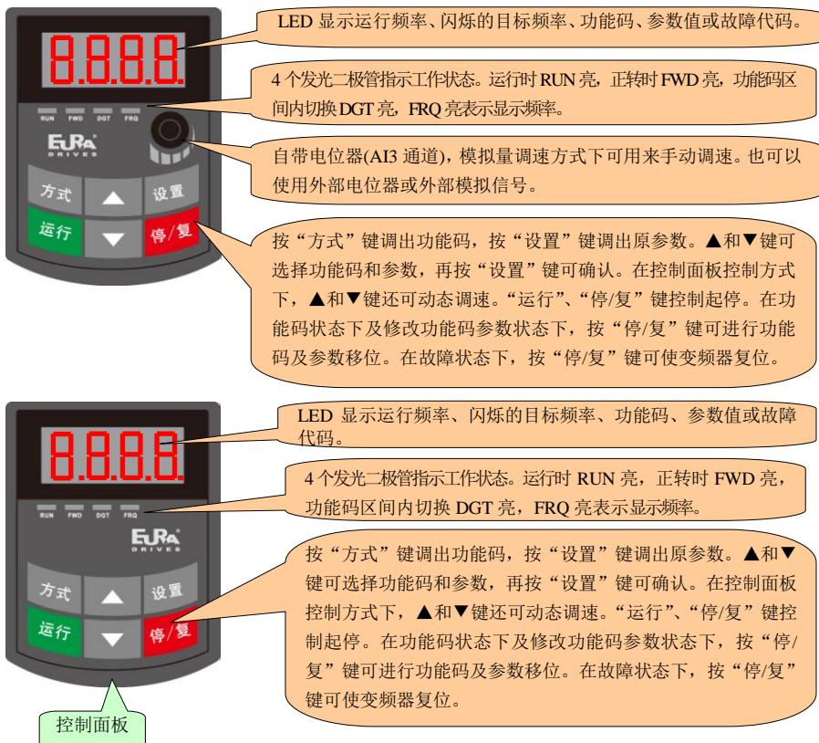
图 3-1 控制面板示意图
