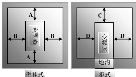
下表给出了变频器安装的间隙尺寸（推荐值）。
