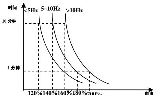
图 6-12 不同频率下的电机过载保护值
