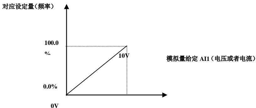
图 6-8 模拟给定与设定量的对应关系
