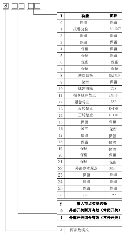
图 8.3.1 可编程输入端子功能设定示意图
