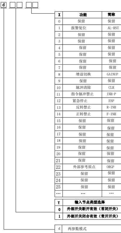
图 8.3.1 可编程输入端子功能设定示意图
