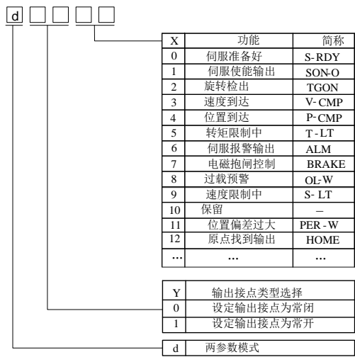
图 8.3.2 可编程输出端子功能设定示意图
