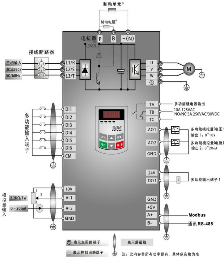
图 4-10-2 三相变频器标准配线图(NPN 方式)
