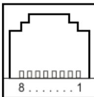
图 3-5 控制面板接口示意图
