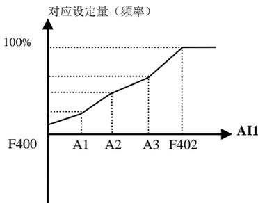
图 6-18 折线式模拟量输入与设定量关系
