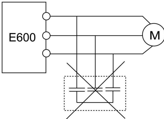
图 1-3 变频器输出端禁止使用电容器
