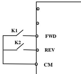
2: 两线式 2: 应用该模式时, FWD 为使能端子, 方向由 REV 的状态来确定。
