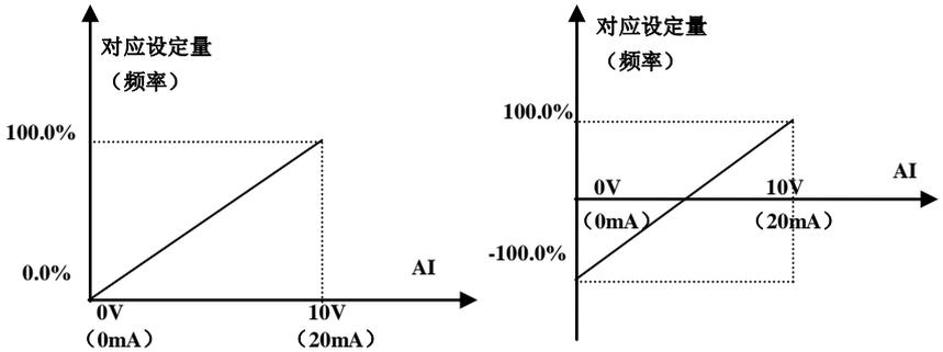
图 6-14 模拟给定与设定量的对应关系
