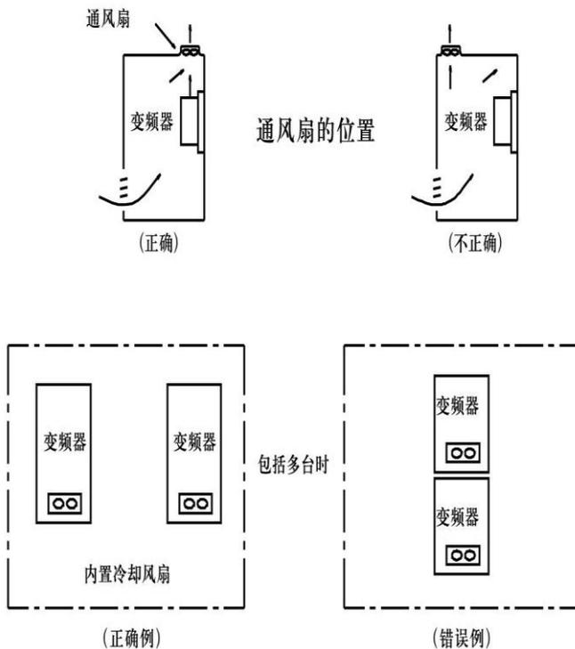
图 1-2 变频器安装在控制柜内示意图
