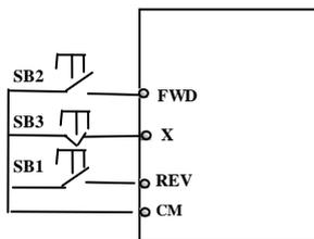
4: 三线式运转模式 2: 该模式下使能端子为 X, 运行命令由 FWD 来给出, 方向由 REV 状态来决定, 停机命令通过断开 X 来完成。
