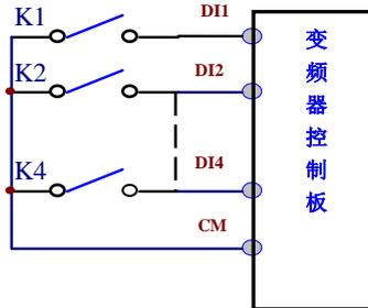
图 4-4 无源共源极接线方式示意图
