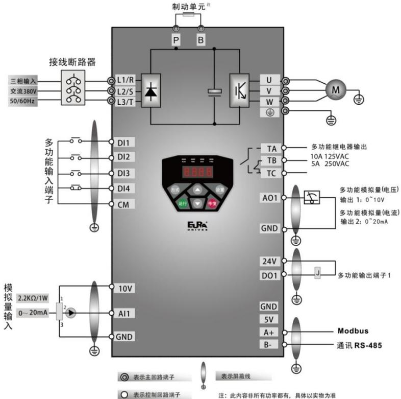
图 4-10-1 三相变频器标准配线图 (NPN 方)
