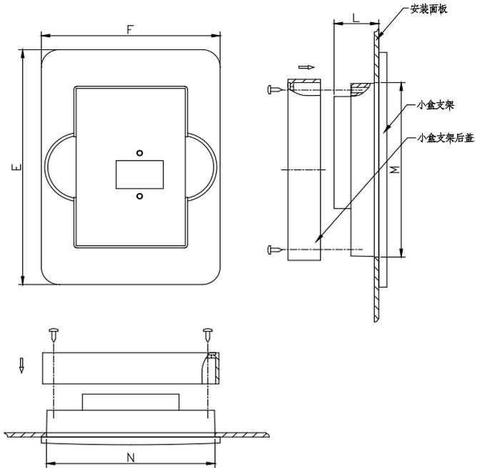
图 3-4 控制面板安装支架结构尺寸示意图
