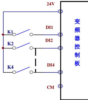
图 4-6 无源共漏极接线方式示意图
