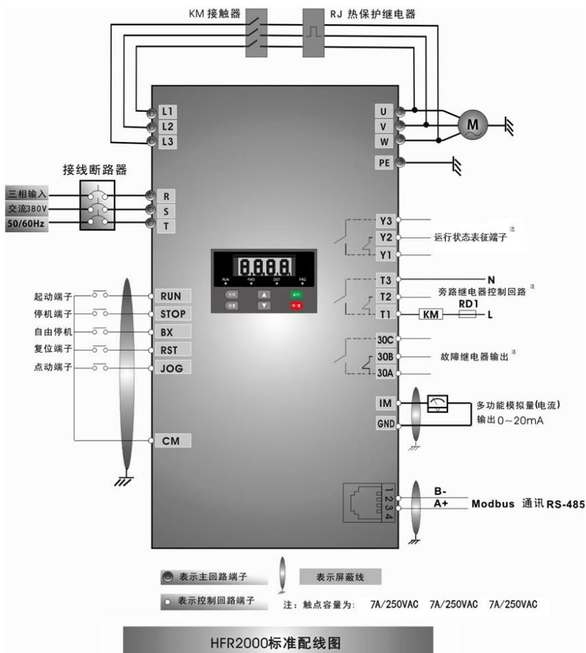
软起动器端子 R、S、T 为输入端；U、V、W 为输出端；QF-空气自动断路器；KM-接触器；RJ-热保护继电器；RD1-熔断器；L-N 接 220VAC，严禁接 380VAC。
