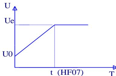
电压斜坡起动特性曲线 图 (1)
