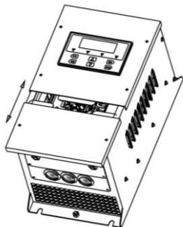
HFR2015-HFR2055 结构外观拆卸示意图
