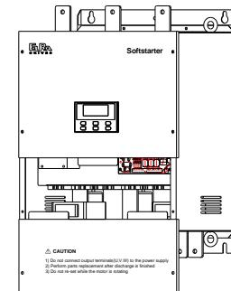
HFR2075-HFR2500 结构外观拆卸示意图
