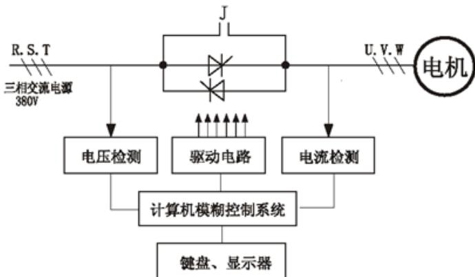
采用三组反并联可控硅模块作为功率器件，通过对输入电压取样获得同步信号，对输出电流取样进行反馈模糊控制，自动跟踪相位、控制移相角，使电压逐步上升，从而控制起动电流。起动完毕旁路接触器将可控硅短接，电动机投入电网运行。
