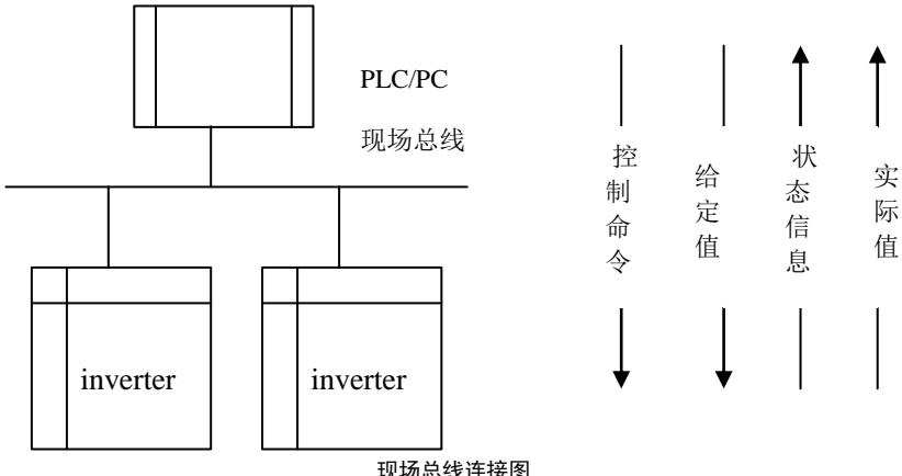
软起动器采用 RS485 的半双工通讯方式。485 总线要采用手拉手结构，而不能采用星形结构或者分叉结构。星形结构或者分叉结构会产生反射信号，从而影响到 485 通讯。
