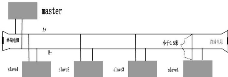
接线时要考虑计算机/PLC 的驱动能力及计算机/PLC 与软起动器之间的距离。如果驱动能力不足需要自行加装中继器。
