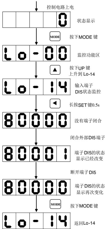
图 5-3-2 监控参数区操作示意图
