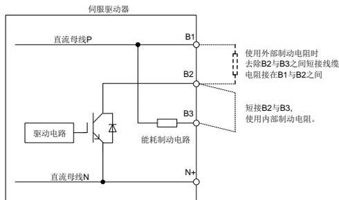
图 6-4-2 能耗制动接线示意图
