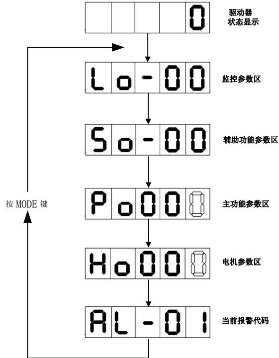
图 5-3-1 用户参数区切换示意图
