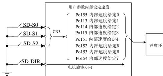
图 6-7-1 内部寄存器速度模式示意图
