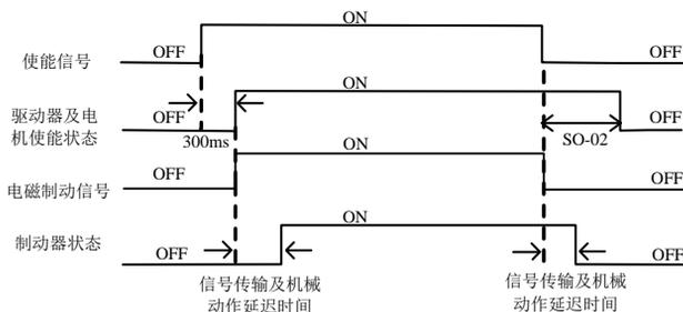
图 6-4-3 电磁抱闸制动时序图
