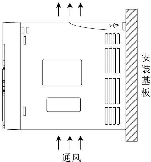
图 3-1-1 标准安装方向示意图
