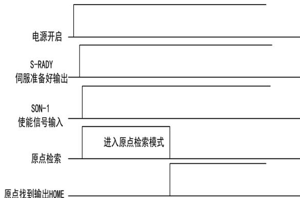
2. 接入输入点时的时序图 (Po125=2)
