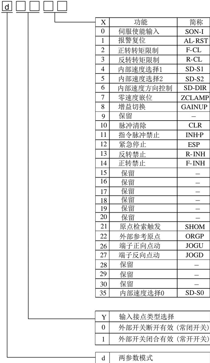
图 4-5-1 可编程输入端子功能设定示意图
