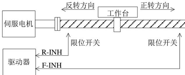
图 6-4-1 超程保护限位开关设置示意图
