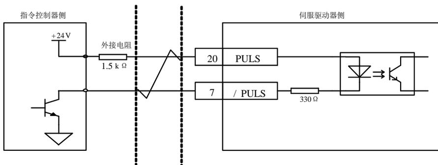
图 4-4-8 24V 集电极开路脉冲输入接口电路
